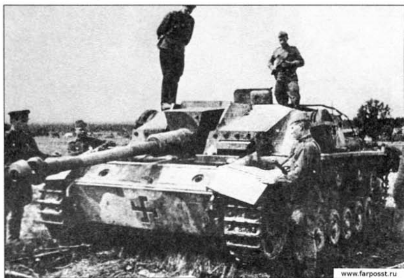
75-мм германская самоходная установка StuG III, состоявшая на вооружении финской армии. Захвачена советскими войсками в 1944 г.
