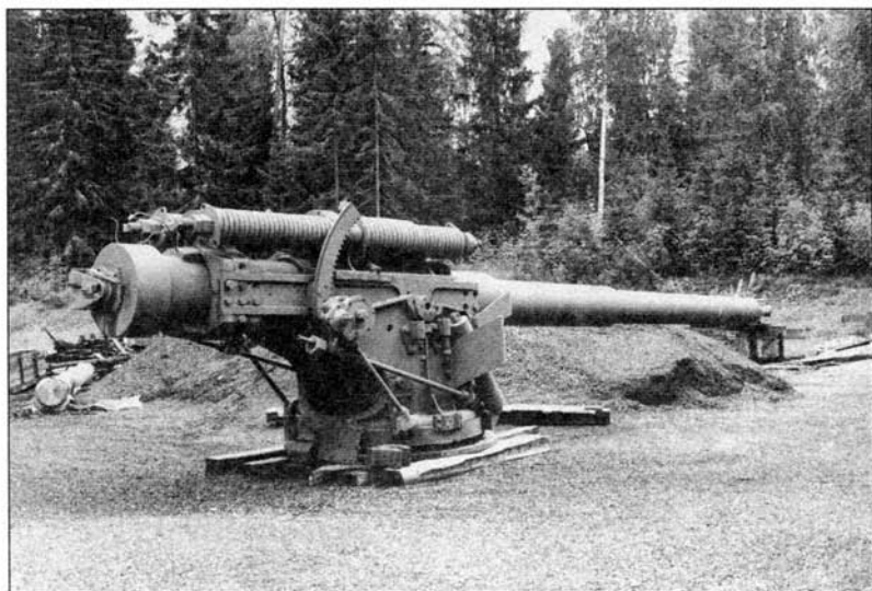
203/50-мм береговая пушка, модернизированная финнами: ствол перевернут, и противооткатные устройства оказались вверху
