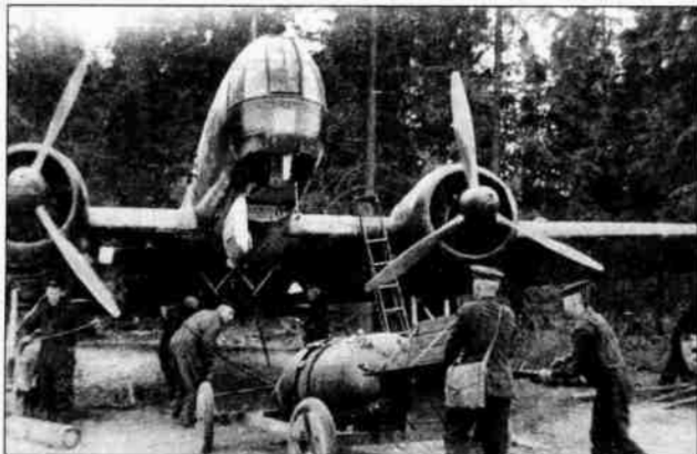
Транспортировка и подвеска мины АМГ-1 под самолет ДБ-3Б 1-го мтап, 1941 г. (фото из архива Г.Ф. Петрова)
