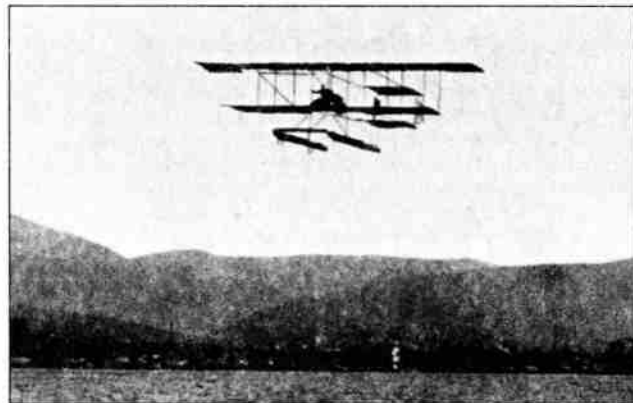
Гидросамолет фирмы «Фарман» — первый в истории торпедоносец, с которого лейтенант Гвидони проводил эксперименты по сбрасыванию торпед в 1912 г.
