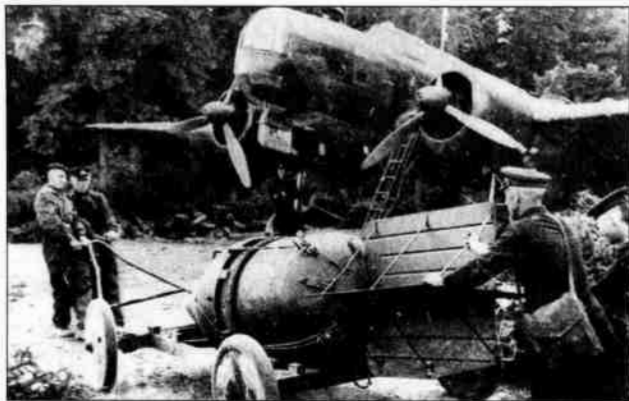
Транспортировка и подвеска мины АМГ-1 под самолет ДБ-3Б 1-го мтап, 1941 г. (фото из архива Г.Ф. Петрова)
