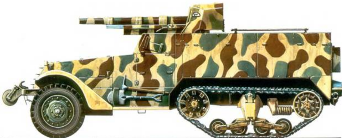
75-мм самоходная пушка на шасси бронетранспортера М3. Рота специального оружия 1-й дивизии морской пехоты США, декабрь 1943 года.
