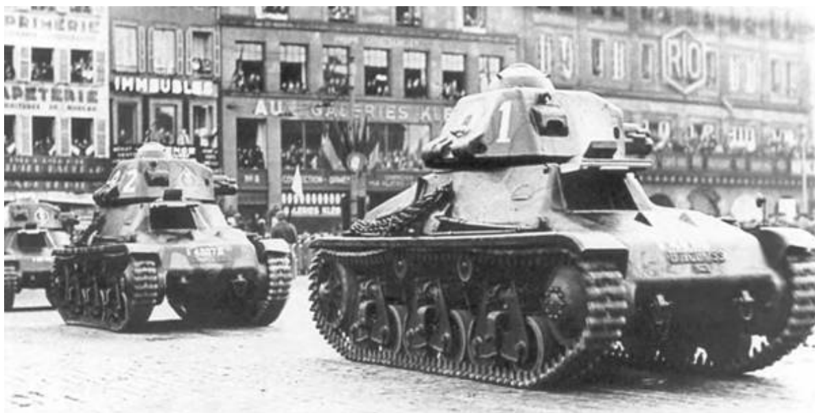
Легкие танки "Гочкис" H35 на одном из предвоенных парадов. Эти машины были вооружены короткоствольной 37-мм пушкой.
