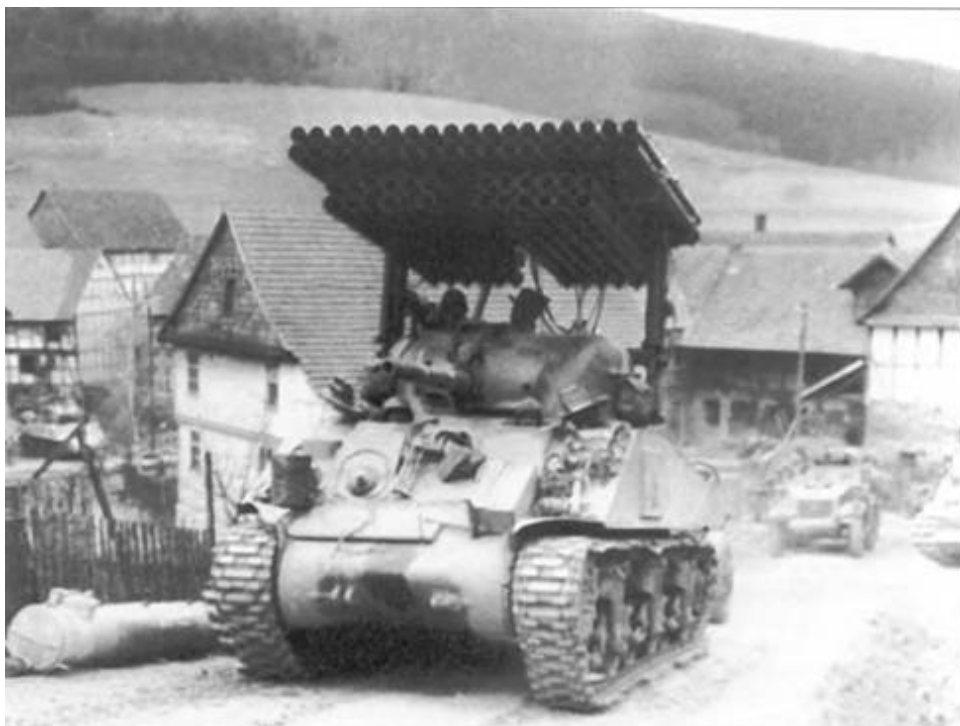
Американская "катюша" – танк М4, оборудованный реактивной системой залпового огня Т34 "Голиаф". 6-я танковая дивизия, Германия, апрель 1945 года.
