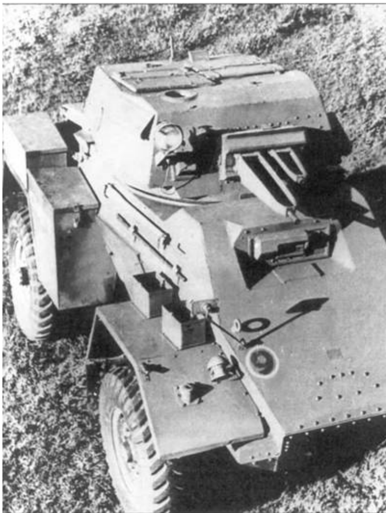
Канадский броневедомобиль "фокс" Mk I. Канадское отделение американской фирмы "Дженерал Моторс" изготовило более 1000 таких машин, вооруженных обычным и крупнокалиберным пулеметами "Браунинг".
