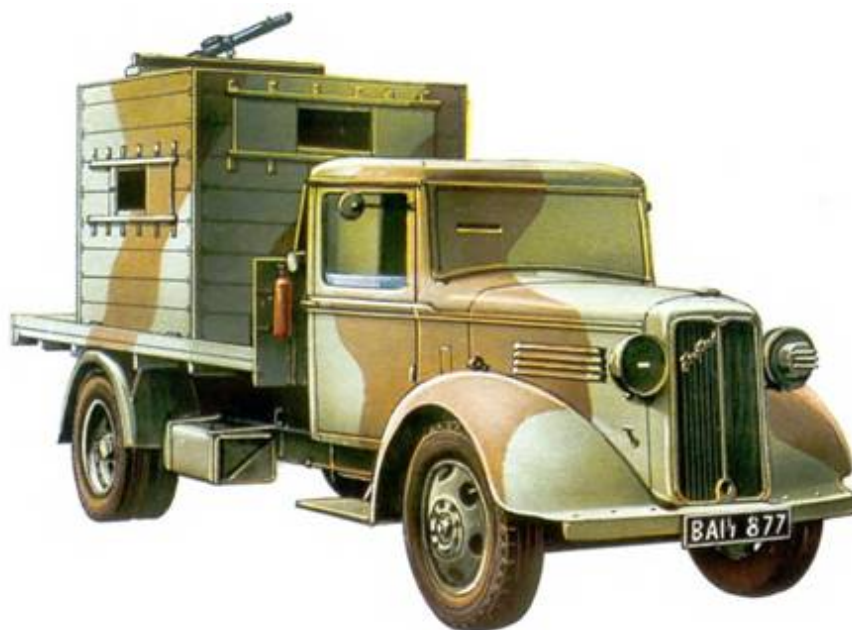
Импровизированный бронеавтомобиль "Армадилло" Mk I на базе грузовика "Бедфорд". Великобритания, 1940 год.
