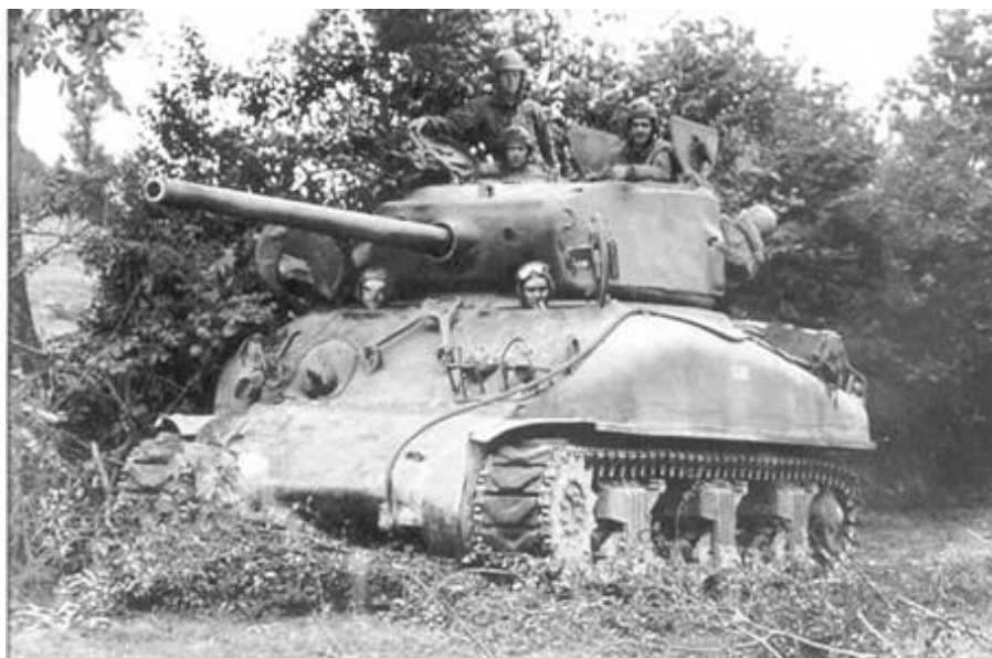
Средний танк М4А1(76)W 2-й танковой дивизии в Нормандии. Июль 1944 года. Эта машина вооружена 76-мм длинноствольной пушкой.
