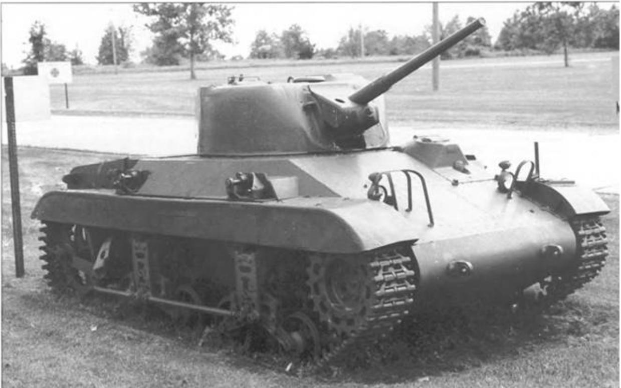
М22 "Локаст" — авиадесантный легкий танк. Предназначался для транспортировки как внутри, так и снаружи самолета и десантирования посадочным способом.
