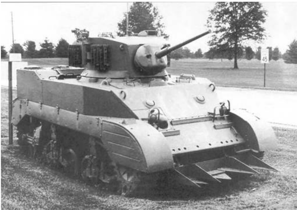
Легкий танк М5А1 в музее Абердинского полигона в США. Эта машина оборудована специальным ножевым устройством для преодоления живых изгородей.
