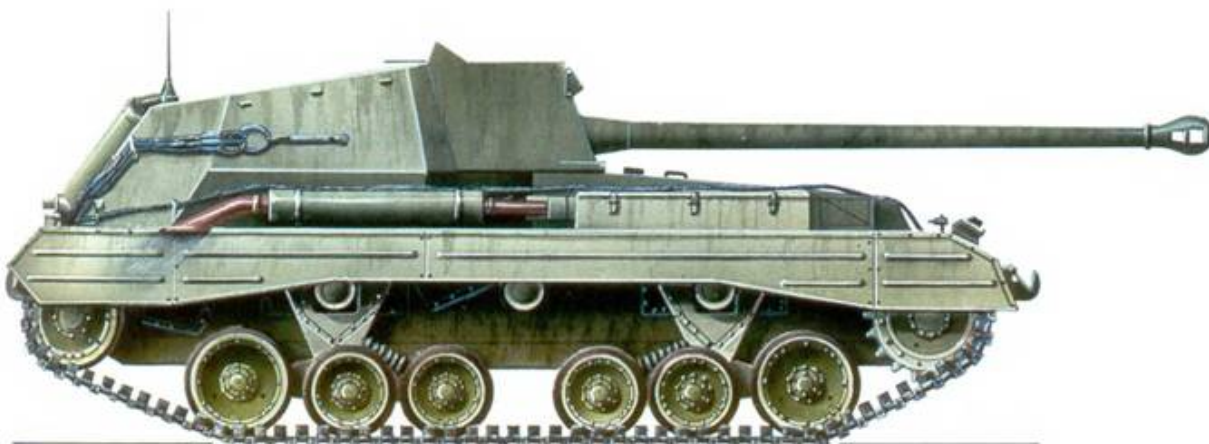
Самоходная противотанковая пушка "Арчер". У этой машины мощная 17-фунтовая пушка установлена стволом назад.
