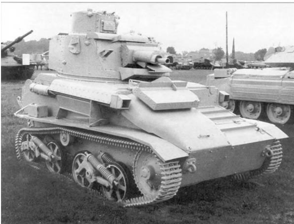
Легкий танк Mk VI в экспозиции Абердинского полигона в США. В башне танка в общем лафете размещены два пулемета "Виккерс" калибра 7,7 и 12,7 мм.
