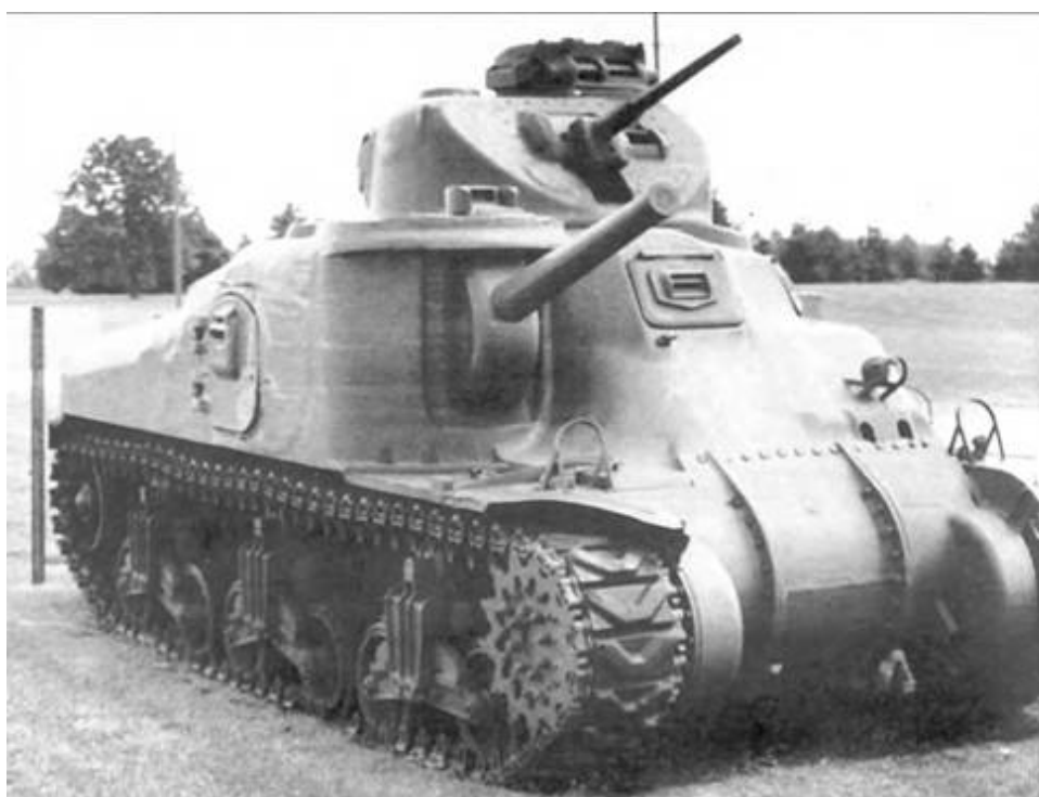
Один из самых колоритных танков Второй мировой войны – американский средний танк М3 "Генерал Ли". Вооружение располагалось в три яруса: 75-мм пушка в спонсоне; 37-мм – в башне; пулемет "Браунинг" в командирской башенке.
