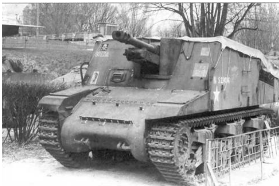
"Секстон" – самоходная гаубица, разработанная с использованием базы канадского танка "Гризли" и 25-фунтовой английской полевой гаубицы.
