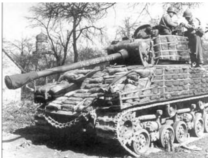
Этот обложенный мешочками с песком "Шерман" принадлежит 14-й американской танковой дивизии. Подобное дополнительное "бронирование" было характерно только для этого соединения.
