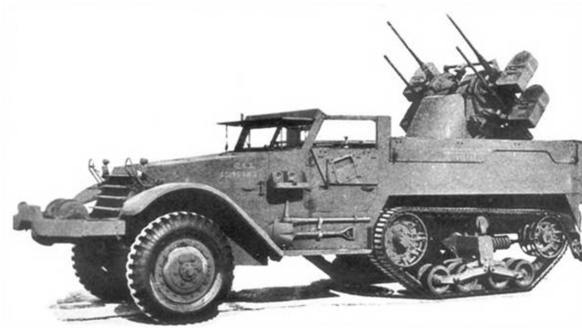
Зенитная самоходная установка М16. Вооружалась счетверенной установкой 12,7-мм крупнокалиберных пулеметов "Браунинг".
