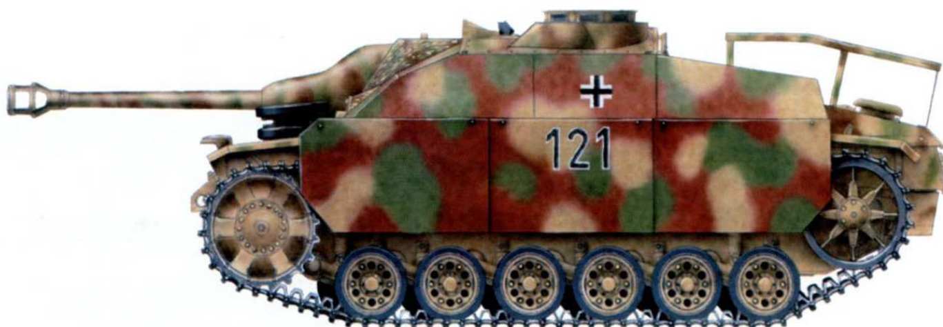
Штурмовое орудие StuG 40 Ausf G позднего выпуска. Рубка САУ покрыта антимагнитным покрытием и бетонными "подушками". В ходе ремонта данный образец получил дополнительное бронирование. Чехословакия, 10-я панцергренадерская дивизия, май 1945 года.
