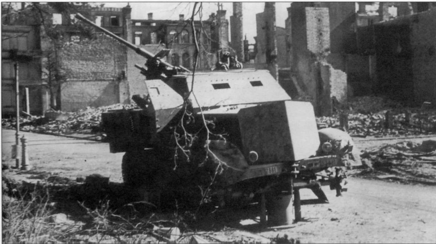
38. Немецкая самоходная зенитная установка калибра 37 мм Flak 36, установленная на базе полубронированного тягача Sd Kfz 7/2 (регистрационный номер «WH 152661»). Померания, город Кольберг, март 1945 года (АСКМ).
