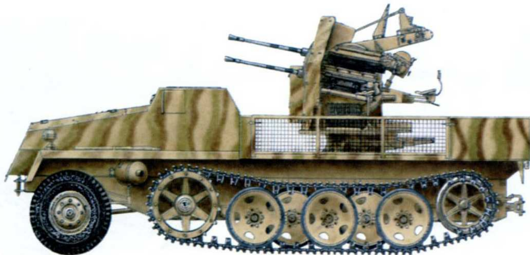
Полугусеничный транспортер универсального назначения SWS со счетверенной 20-мм зенитной установкой Flakvierling 38. Принадлежал сводной дивизии "Фердинанд фон Шилль". Германия, юго-западнее Берлина, 22-й корпус 12-й армии вермахта, апрель 1945 года.
