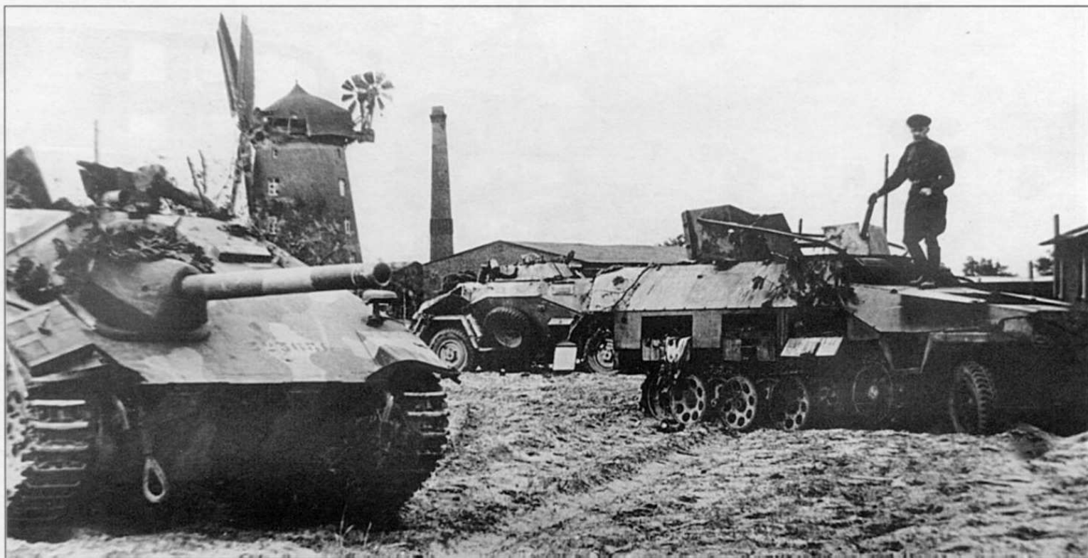
64, 65. Немецкий легкий истребитель танков Jagdpanzer 38 "Хетцер" и огнеметный вариант бронетранспортера Sd Kfz 251/16 из состава пехотной дивизии вермахта "Шарнхорст". Западнее Берлина, май 1945 года. Light tank destroyer Jagdpanzer 38 "Hetzer" and armoured personnel carrier Sd.Kfz.251/16 from infantry division "Scharnhorst". . West of Berlin, May 1945 (ASKM).
