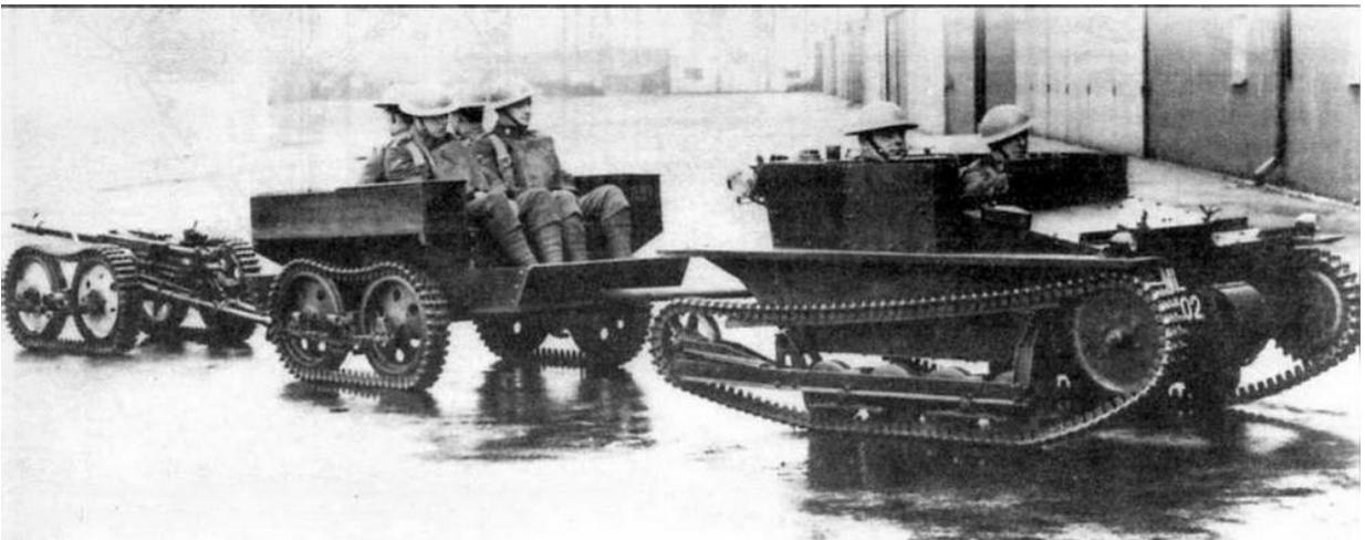
*Танкетка «Карден-Лойд» Mk VI, буксирующая прицеп для перевозки пехоты и тяжелый пулемет*
