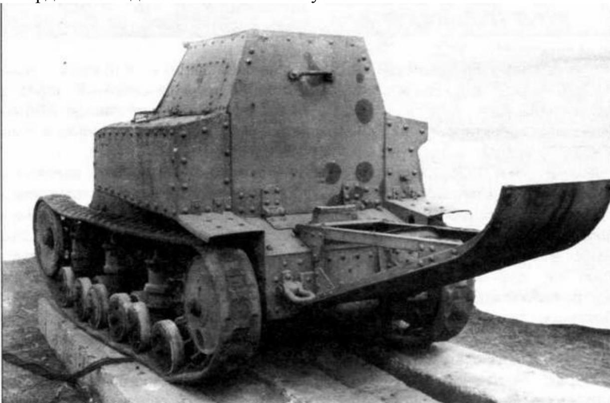
*Танкетка Т-17 «Лилипут». Хорошо видны конструкция хвоста и откидная кормовая дверь*
