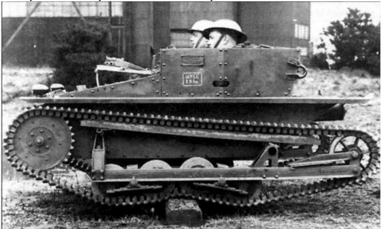
*Танкетка «Карден-Лойд» Mk VI на испытаниях*
