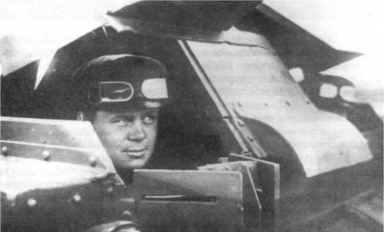
*Танкист на месте стрелка в танкетке Т-27. Хорошо видна конструкция амбразуры для установки пулемета ДТ*
