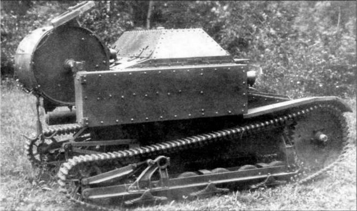
*Опытный образец минного заградителя МЗ-27. Хорошо виден барабан с минами, укрепленный в кормовой части корпуса машины*
