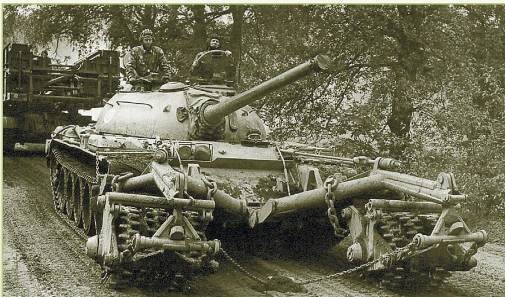
Танк Т-54 с колейным катковым тралом КМТ-5
