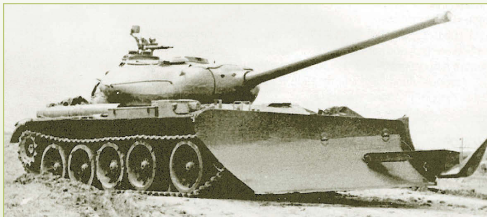
Танк Т-54 со снегоочистителем СТУ
