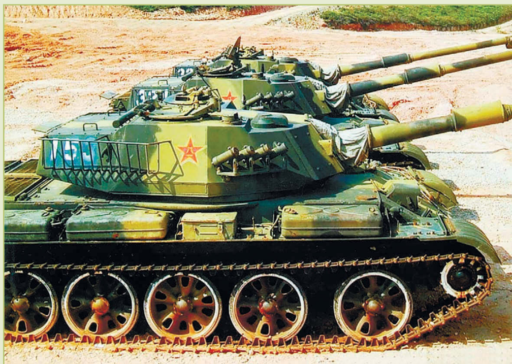
Легкие танки Туре 62г. 2000 г. Вместо штатной эти машины получили башни от плавающего танка Туре 63А со 105-мм пушкой
