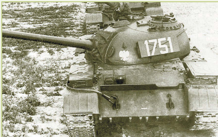
Танк Т-54А польского производства. Характерными внешними отличиями этих машин были L-образные топливные баки на надгусеничных полках и ящик ЗИП на борту башни
