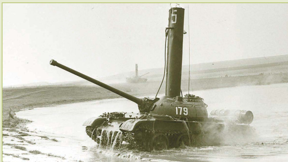
Средний танк Т-54Б (модерни- зированный Т-54 обр. 1951 г.) с установленной трубой-лазом ОПВТ после преодоления водной преграды по дну
