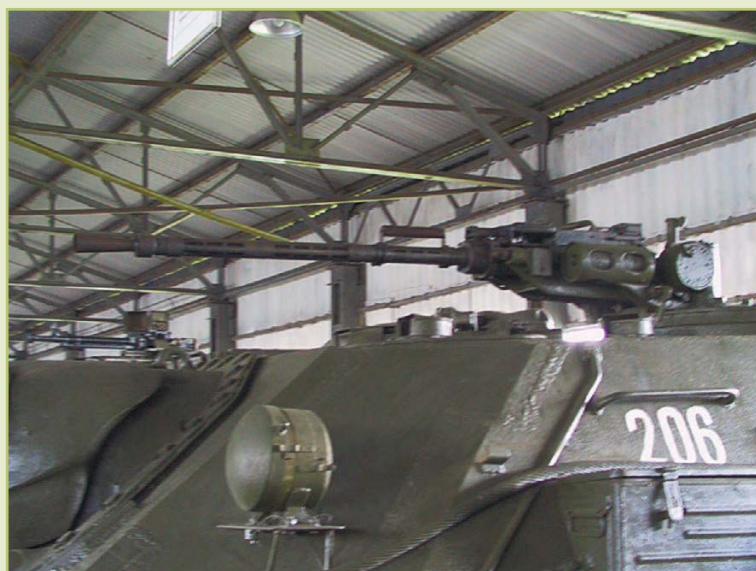
Установка зенитного пулемета КПВТ
