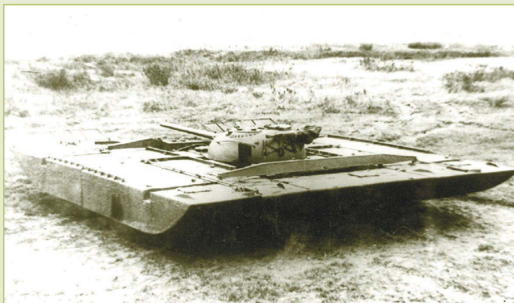
Танк Т-54 с плавсредствами ПСТ-54 в положении «на плаву»
