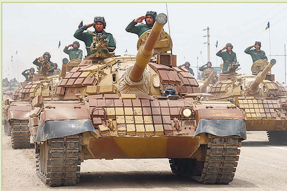
Серийный образец танка Safir-74 с более простым вариантом навесной динамической защиты
