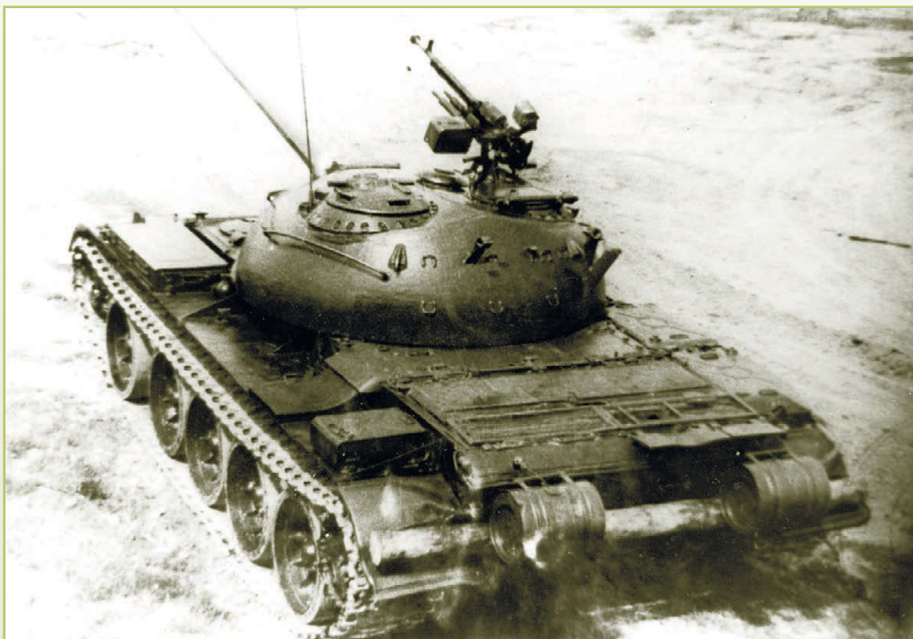
Вид сзади сверху на танк Т-54 обр. 1951 г. Хорошо видна полусферическая форма башни
