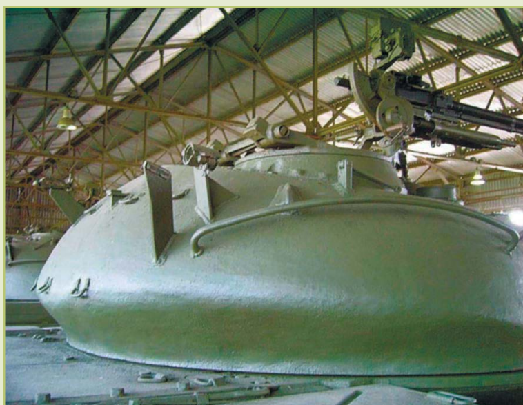
Кормовая часть башни Т-54 обр. 1949 г. Хорошо виден обратный скос («заман»)
