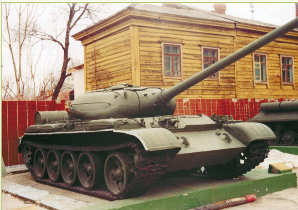
Танк Т-54 обр. 1947 г., прошедший модернизацию. Элементы ходовой части, наружные топливные баки, ящики ЗИП – от танка Т-55. Ликвидированы курсовые и зенитный пулеметы
