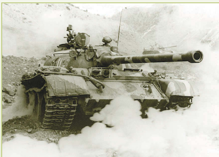
Танк Т-54Б, полученный в результате модернизации Т-54 обр. 1951 г.
