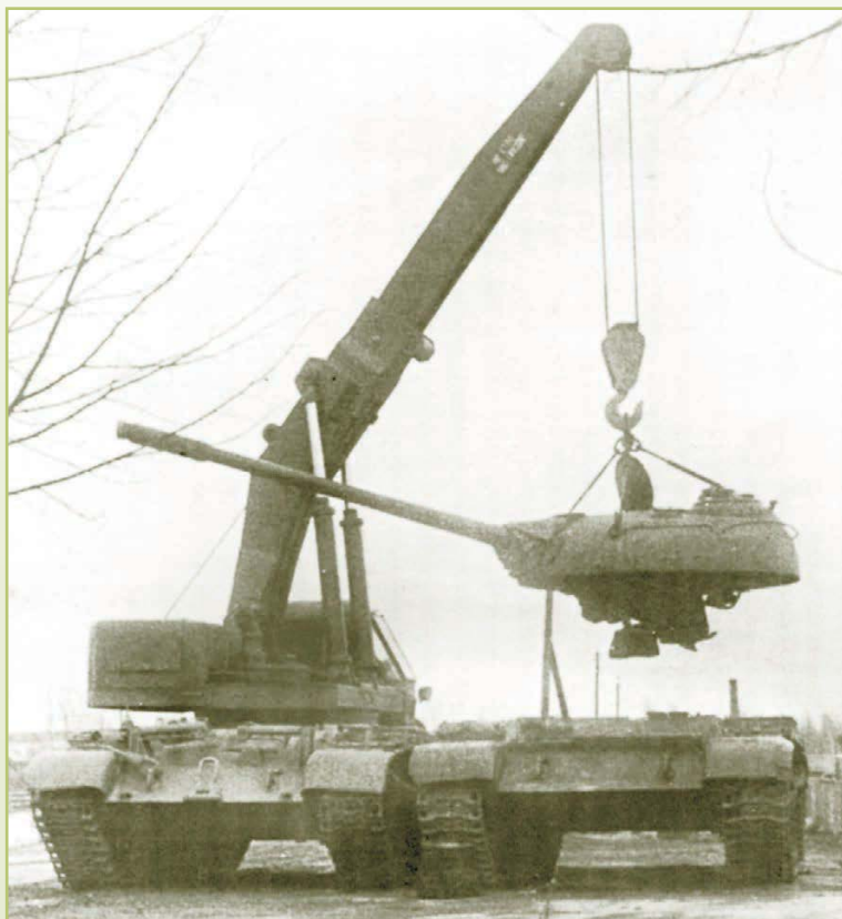
С помощью крана СПК-12Г осуществляется демонтаж башни с танка Т-54
