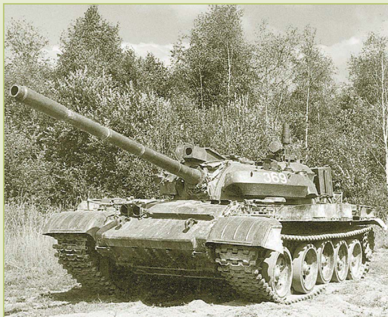
Модернизи- рованный танк чехословацкого производства Т-55АМ2, оснащенный СУО «Кладиво»
