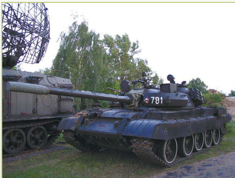
Польский танк Т-55АМ, оснащенный СУО Merida
