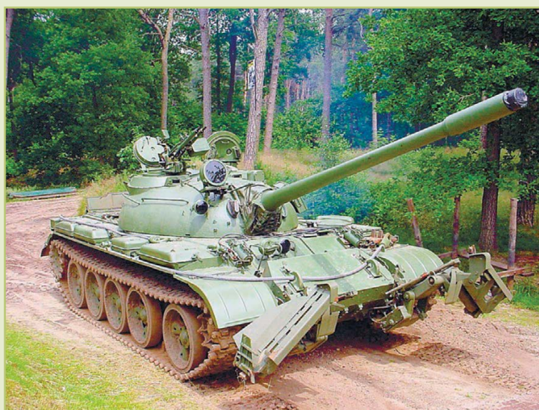
Танк Т-55А с колейным ножевым минным тралом КМТ-6М
