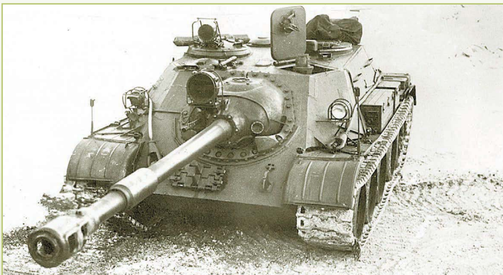
Самоходная установка СУ-122-54 с приборами ночного видения
