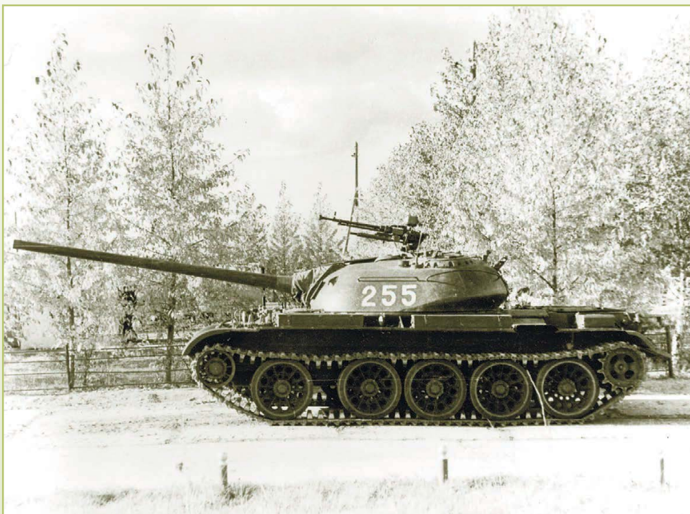
Слева: Танк Т-54 обр. 1949 г., прошедший частичную модернизацию в ходе капремонта. Об этом можно судить, например, по защитному чехлу маски пушки. Кроме того, танк оборудован под установку минного трала ПТ-54. 1957 год
