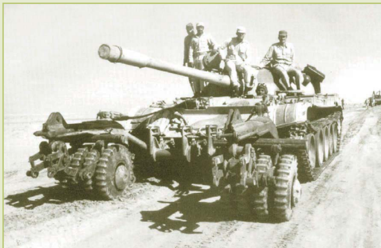
Египетский танк Т-54А, оснащенный катковым минным тралом ПТ-54. 1973 год
