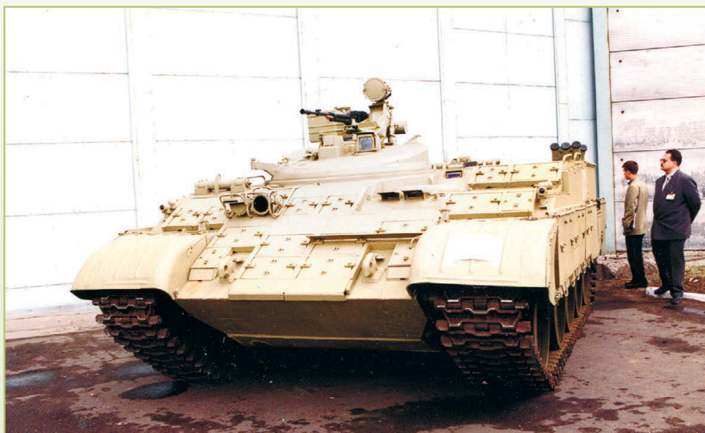
Бронетранспортер БТР-Т - вариант использования шасси танка Т-55
