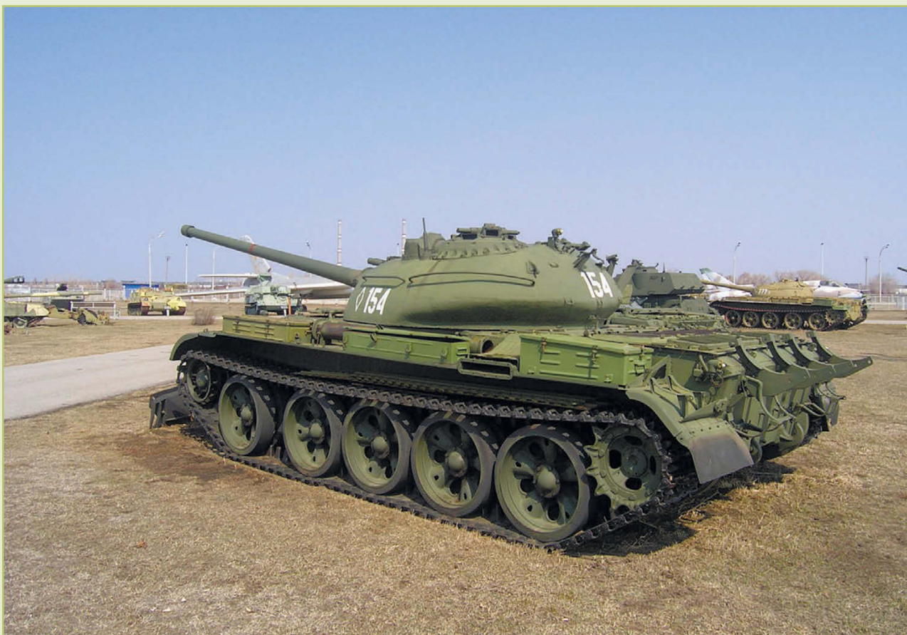
Внизу: Значительно более серьезно модернизированный танк Т-54 обр. 1949 г. И дело даже не в ходовой части, заимствованной у Т-55. Судя по противовесу дульного среза пушки, эта машина доведена до уровня Т-54Б
