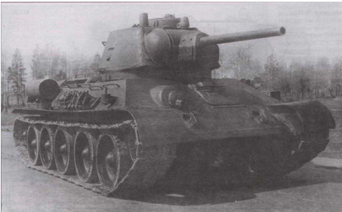
Танк Т-34 выпуска 1943 года с командирской башенкой. НИБТПолigon, 1946 год. Полигонное происхождение снимка объясняет наличие нештатных элементов во внешнем облике танка. Так, вместо дымовых шашек на корме корпуса установлены топливные баки
