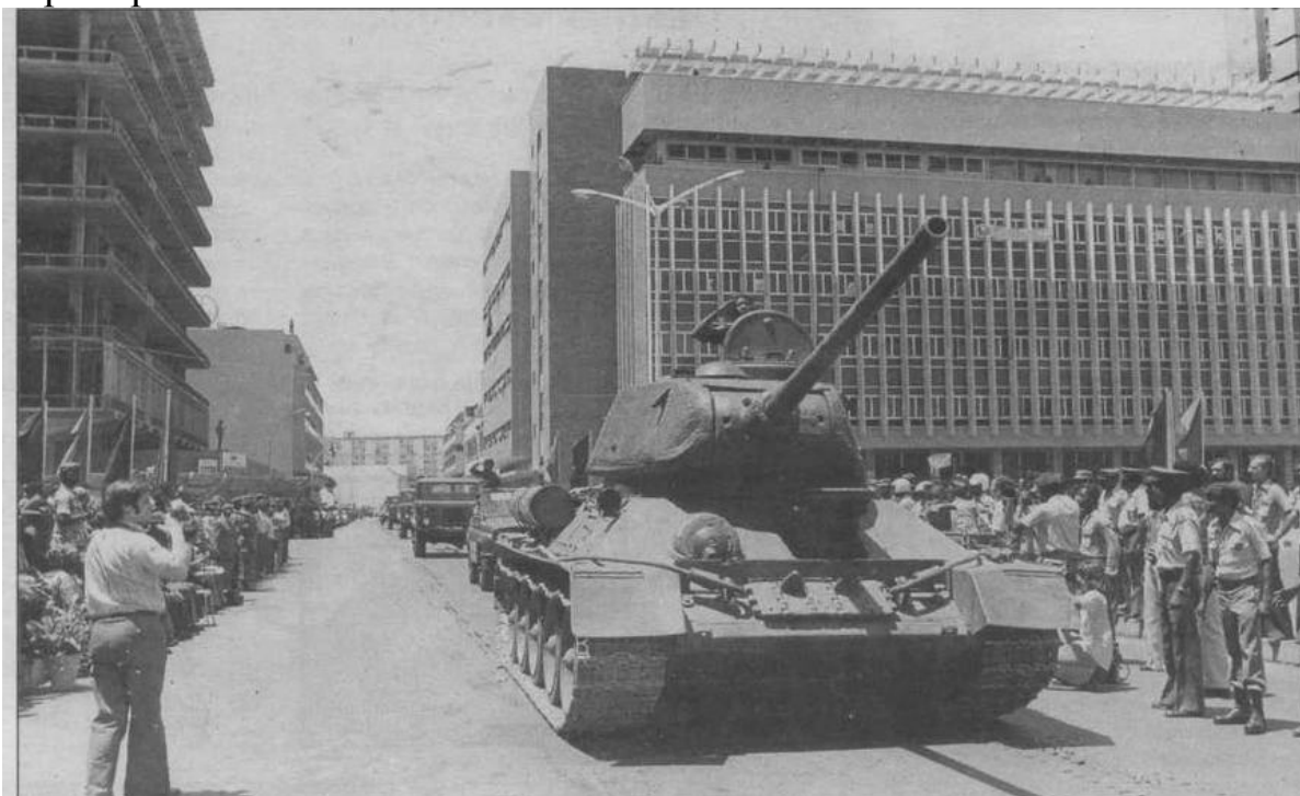
Сормовский Т-34-85 на параде в Анголе. Машина прошла модернизацию, о чем можно судить по ИК-осветителю ФГ-100 на правом борту корпуса. Луанда, 9 февраля 1976 года
