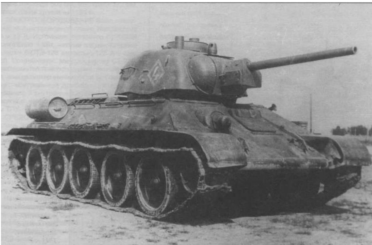
Огнемётный танк ТО-34 во время испытаний на полигоне в Кубинке. 1944 год
