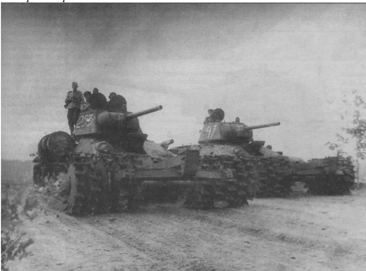
Танки Т-34, оборудованные противоминным тралом ПТ-3. Харьковское направление, 1943 год
