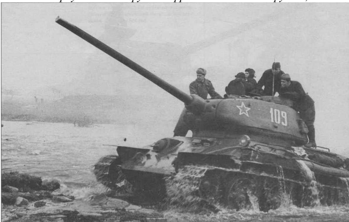
Т-34-85 позднего выпуска 1944 года. Нештатные грязевые щитки установлены, видимо, в ходе ремонта. Довольно редкий снимок, на котором хорошо видны полностью открытые "ресницы" — броневые крышки призм приборов наблюдения механика-водителя
