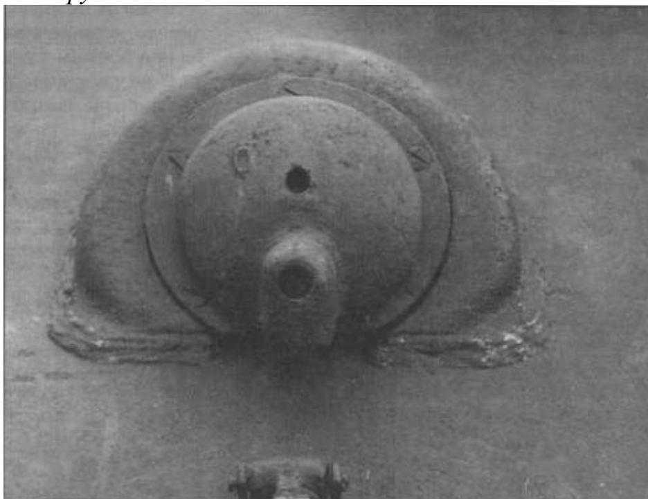
Броневая маска шаровой установки курсового пулемета
