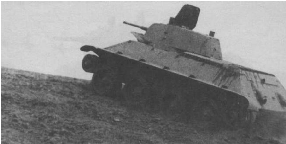
Колесно-гусеничный танк А-20 на колесном ходу преодолевает косогор. НИБТПолигон, 1939 год
