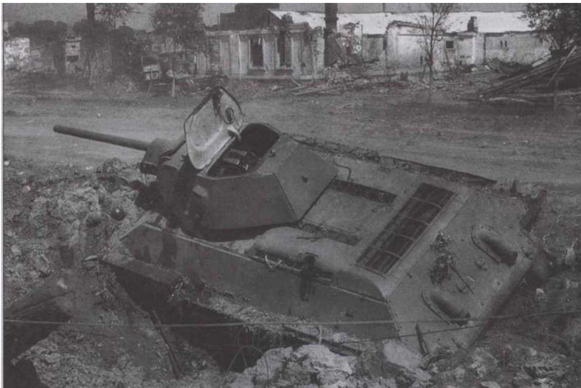
Т-34 производства СТЗ, подбитый в ходе боев в излучине Дона. Июль 1942 года. Машина поздних выпусков, об этом можно судить по приваренной несъемной кормовой стенке башни
