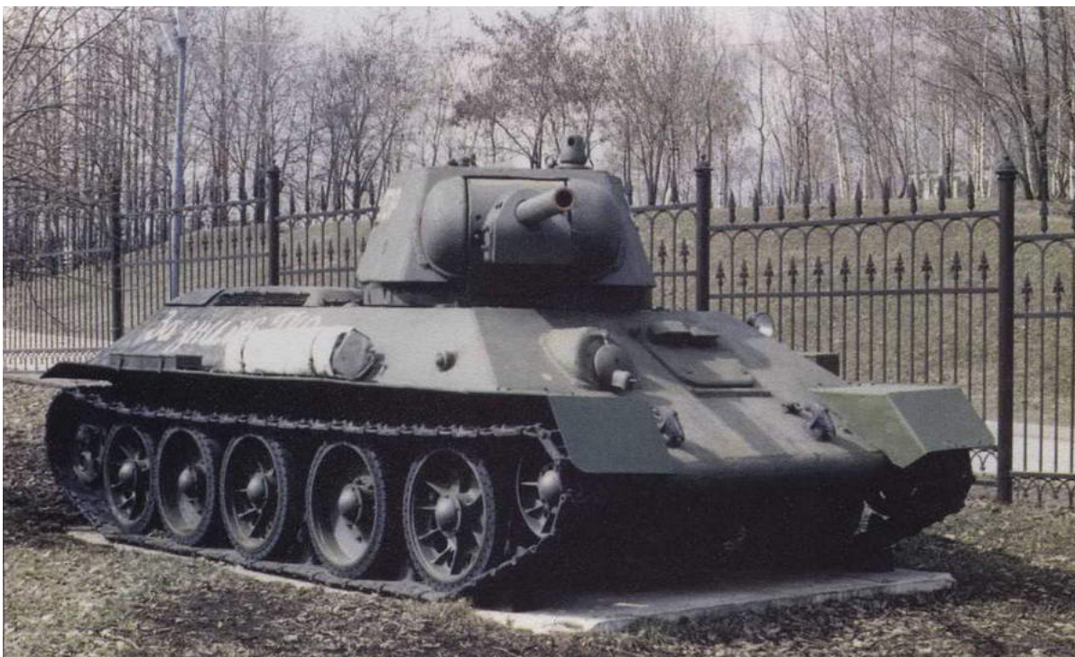
Танк Т-34 выпуска 1942 года с улучшенной башней Фото М. Барятинского
