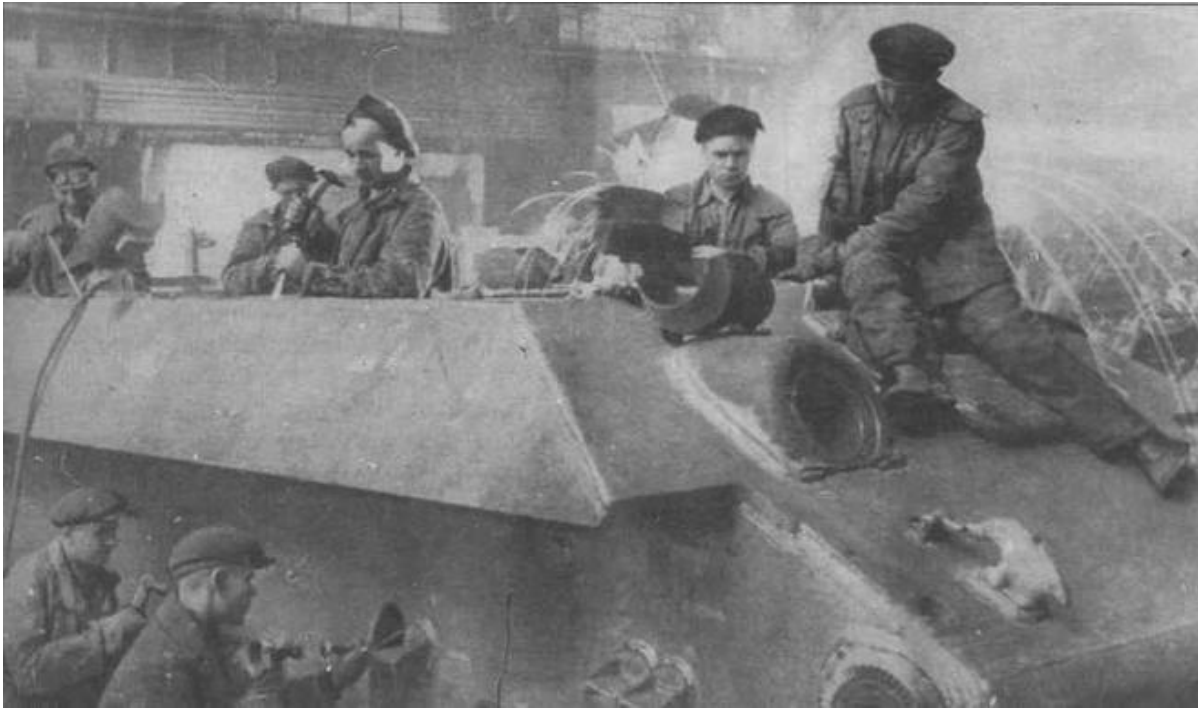
Зачистка сварных швов на корпусе танка Т-34
