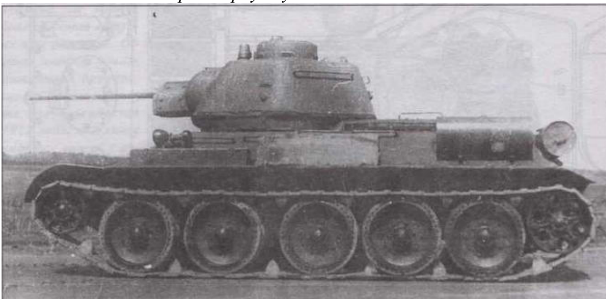
Танк Т-34 выпуска 1943 года с командирской башенкой. НИБТПолigon, 1946 год. Полигонное происхождение снимка объясняет наличие нештатных элементов во внешнем облике танка. Так, вместо дымовых шашек на корме корпуса установлены топливные баки
