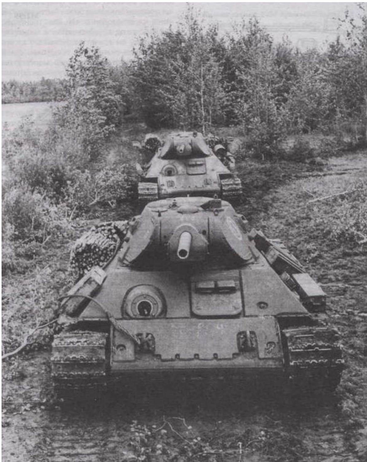
"Тридцатьчетверки", оборудованные дополнительной лобовой броней, состоящей из трех частей. Калининский фронт, 1942 год
