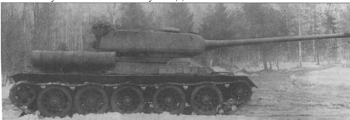
Танк Т-34-100, вооруженный 100-мм пушкой ЛБ-1. Весна 1945 года
