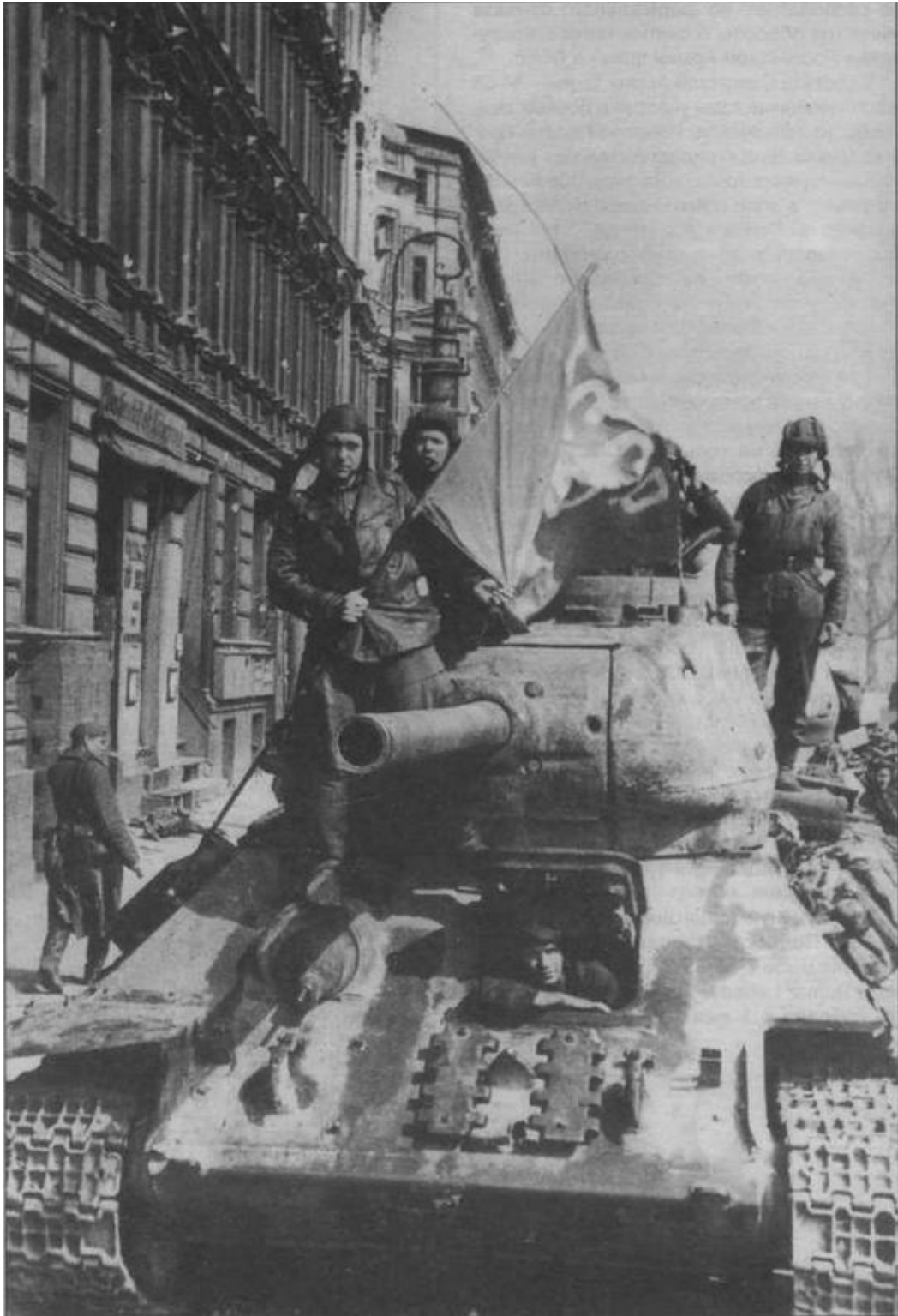
Т-34-85 в Берлине, май 1945 года. Машина поздних выпусков 1944 года с пушкой ЗИС-С-53 и креплением запасных траков на лобовой броне
