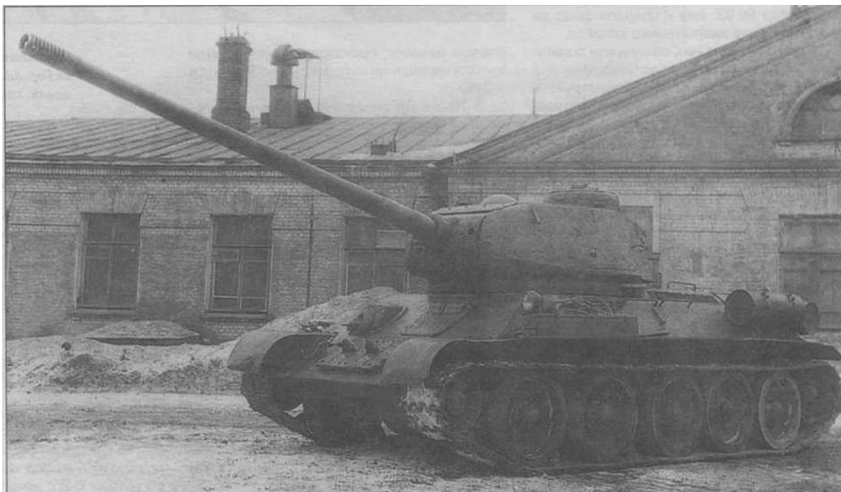
Танк Т-34-100 с орудием ЗИС-100 в штатной башне танка Т-34-85. 1945 год
