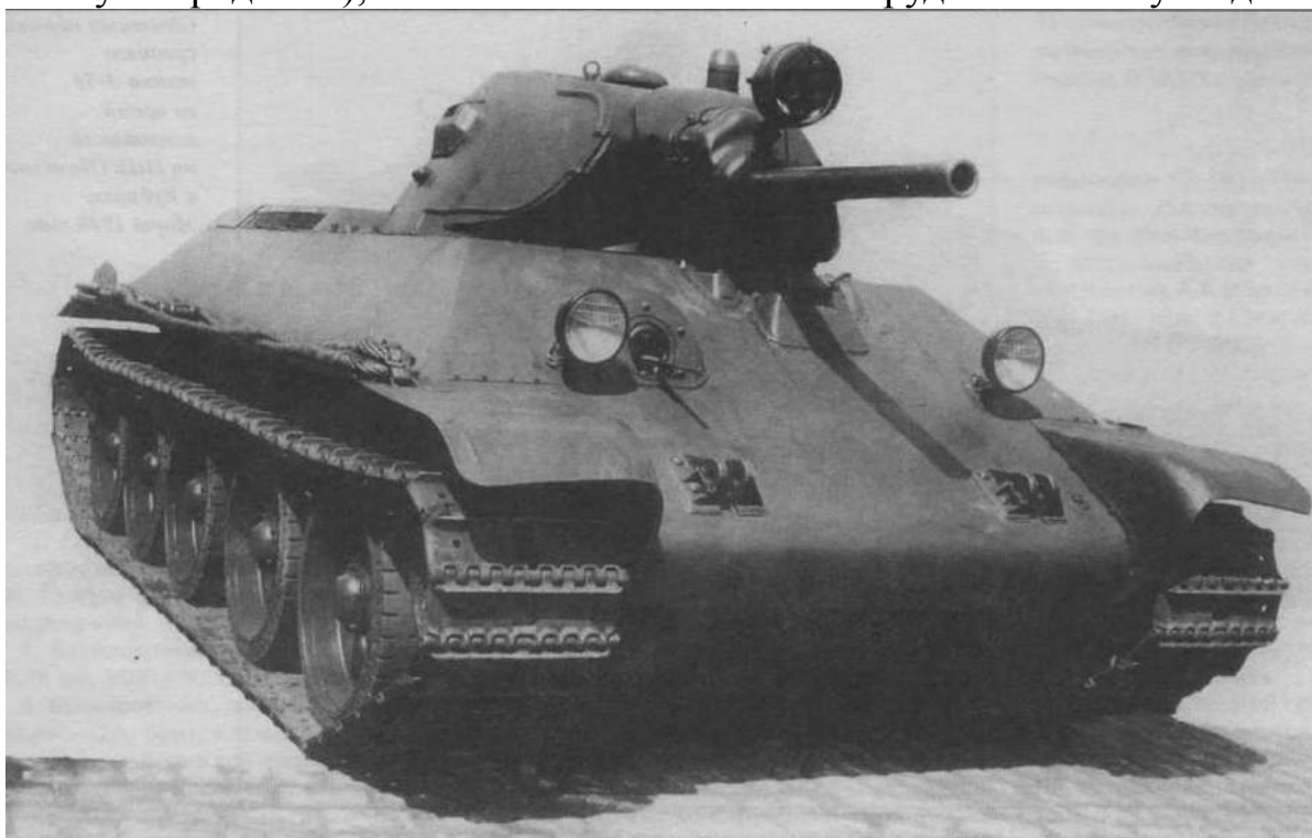
Первый опытный образец танка А-34. Обращает на себя внимание гнутый лобовой лист корпуса, отсутствовавший на серийных машинах
