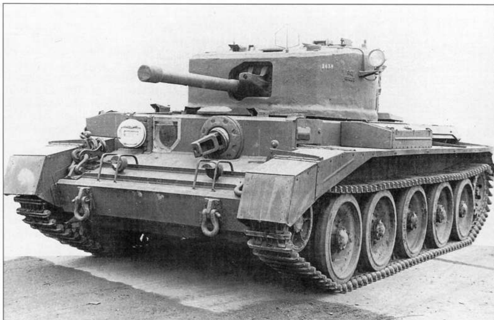
Прототип танка «Кромвель» с литой башней, изготовленный фирмой Vauxhall
