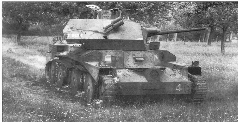
Сгоревший недалеко от Абвиля крейсерский танк Mk IV. Франция, май 1940 года. Хорошо видны броневой кожух пулемета Vickers и установка дымовых гранатометов на правом борту башни
