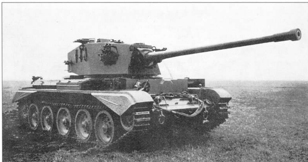
Средний танк Charioteer Mk 7. Амбразура курсового пулемета заварена. По бортам башни ус- тановлены блоки ды- мовых гранатометов
