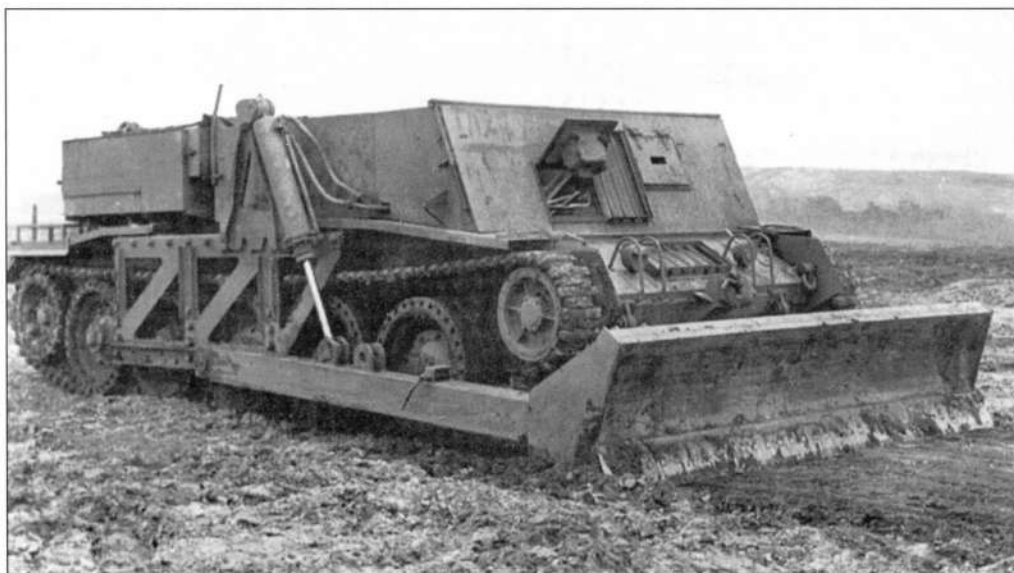
Артиллерийский тягач Crusader Gun Tractor Mk I, оснащенный после войны бульдозерным оборудованием с гидроприводом
