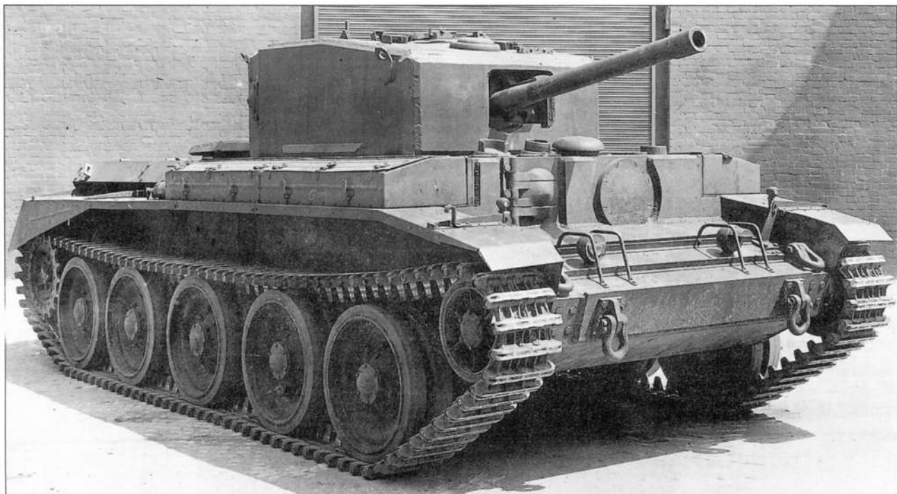
Прототип танка «Кромвель» с литой башней и накладной броней башни и корпуса, изготовленный фирмой Rolls-Royce
