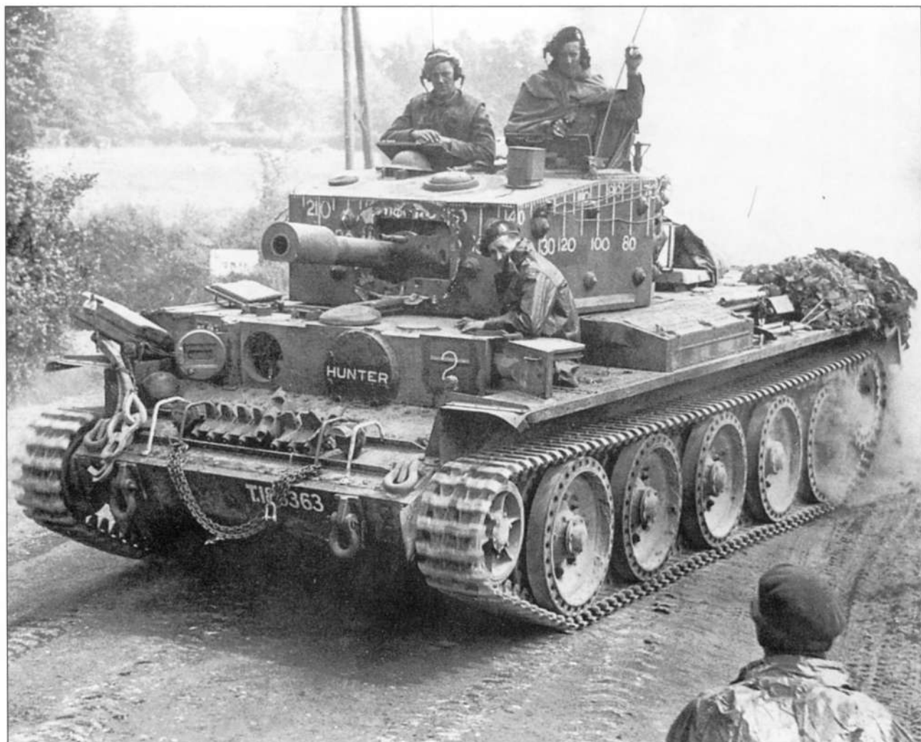
Крейсерский танк Centaur IV из состава Танковой группы поддержки Королевской морской пехоты. Нормандия, июнь 1944 года. Градусная градуировка, нанесенная на башню, облегчала наведение орудия при стрельбе с десантных судов на конечной стадии высадки
