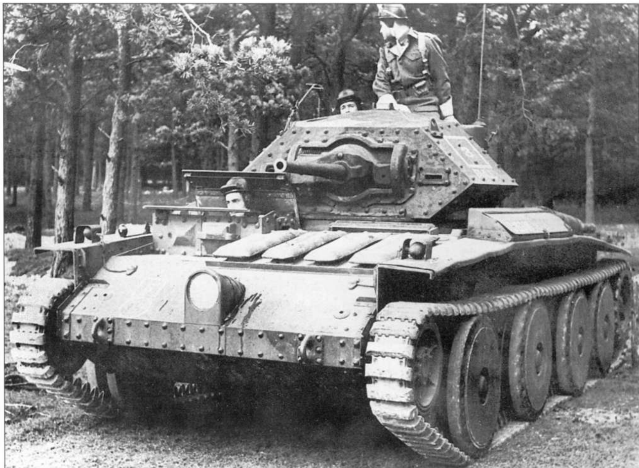
Пилотный экземпляр танка «Ковенантер» с литой маской пушки. Обращают на себя внимание довоенные фибровые шлемы у членов экипажа
