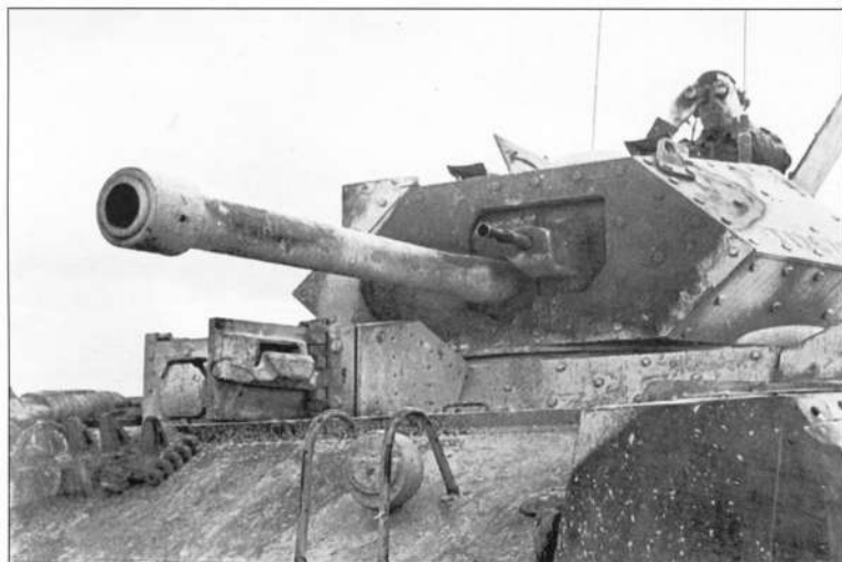
Танк Crusader III крупным планом. Характерной деталью его внешнего вида была внутренняя маска спаренной установки 6-фунтовой пушки и пулемета Besa при абсолютно вертикальном лобовом листе башни
