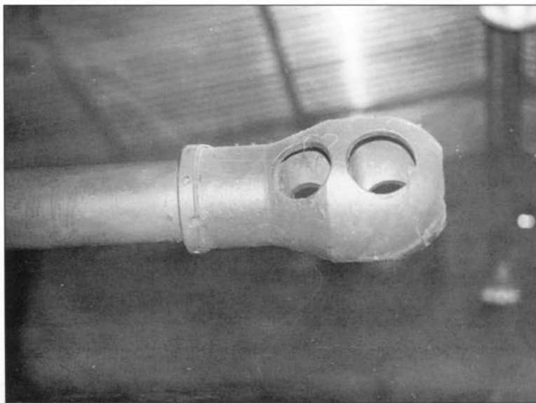
Характерной особенностью 77-мм пушки был заимствованный у 17-фунтовки грушевидный дульный тормоз
