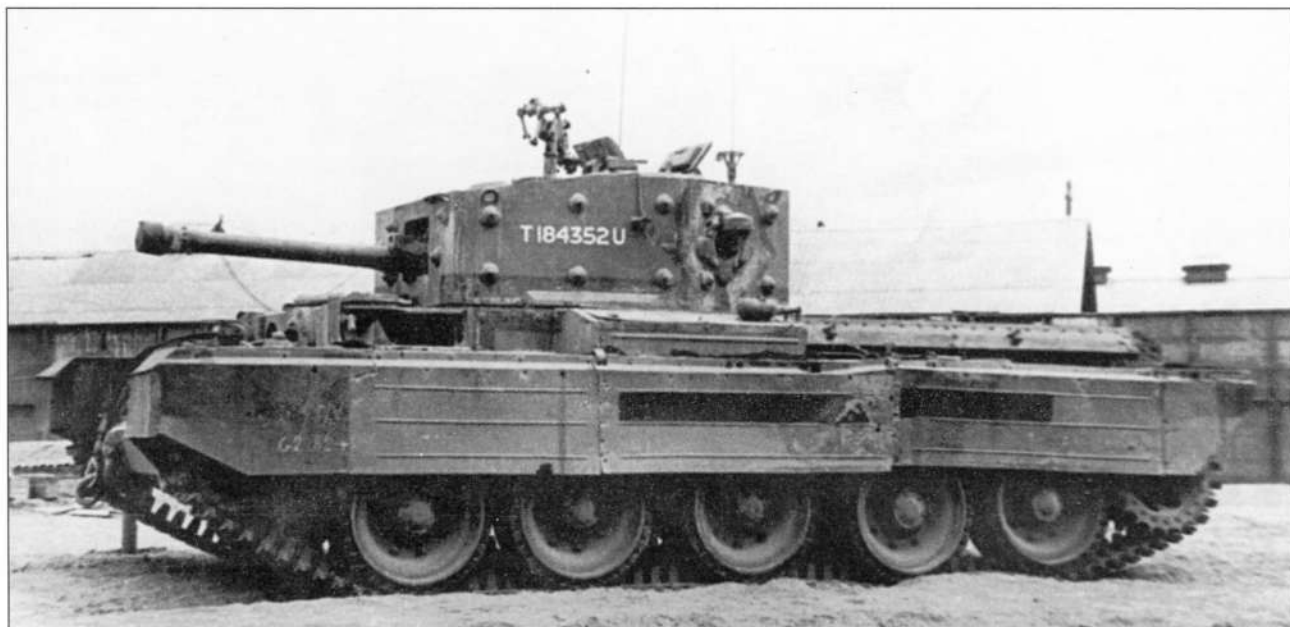
Крейсерский танк Cromwell III. Эта машина оснащена бортовыми экранами, не получившими широкого распространения
