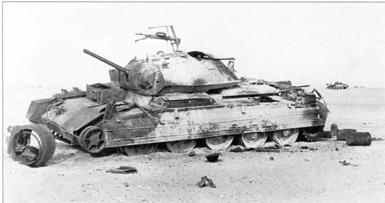
Сгоревший «Крусейдер II». Пулеметная башенка сорвана внутренним взрывом. Резиновые бандажки опорных катков сгорели полностью
