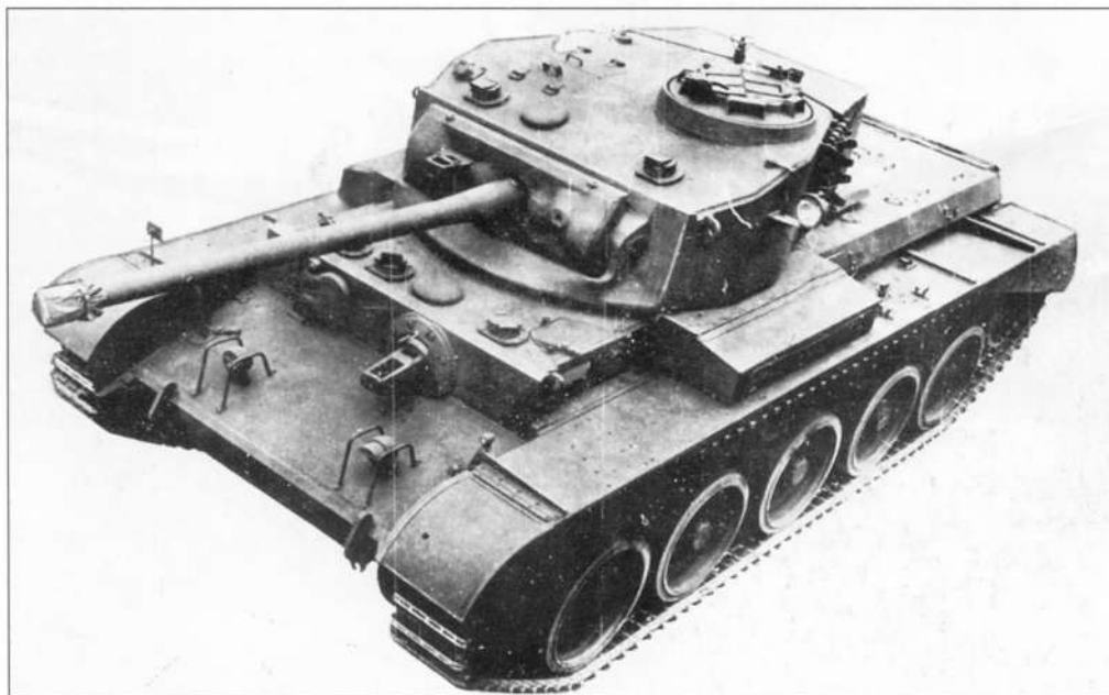
Крейсерский танк A34 Comet (вверху и слева). Характерными деталями внешнего вида «Кометы» были литые маска и лобовая часть башни
