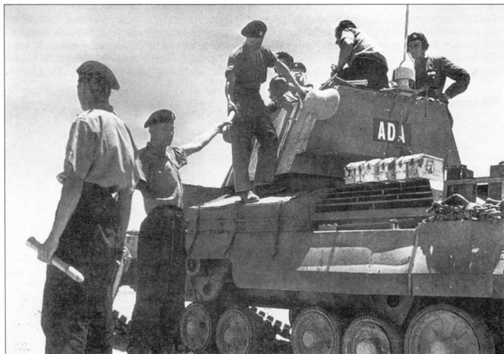
Загрузка 2-фунтовых выстрелов в крейсерский танк Mk II. Северная Африка, 1940 год
