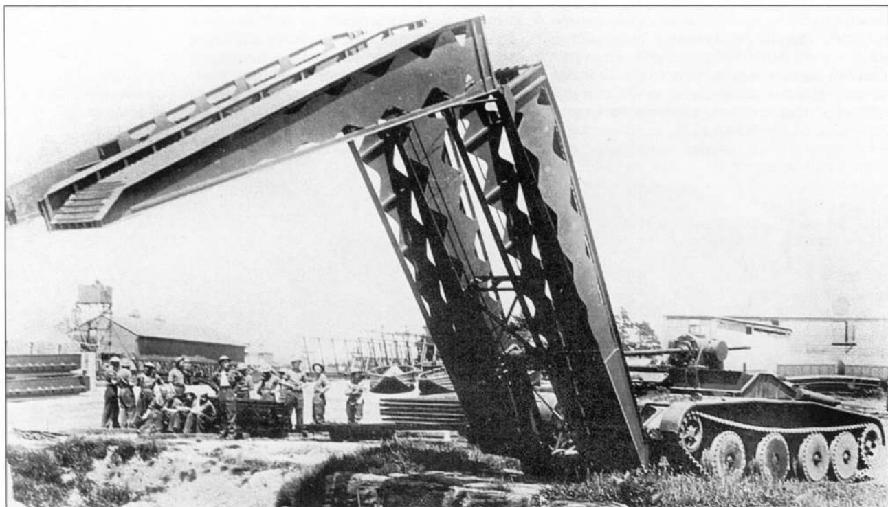
Танковый мостоукладчик на базе танка Covenanter
