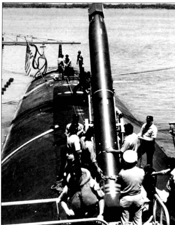
Погрузка торпеды Mk 48, вид из носа лодки в корму. Для погрузки торпеды требуется много народа.
