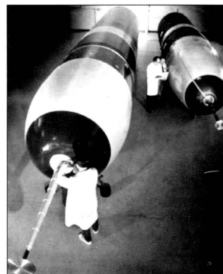
Специалисты фирмы Локхид Мартин выполняют проверку новейших ракет «Трайдент». Слева - удлиненный вариант UGM-133A «Трайдент II», справа - ранний вариант UGM-96A «Трайдент I». Длина ракеты «Трайдент II» составляет 13,41 м, диаметр 1,85 м, масса 58 500 кг. Ракета может нести до 14 боевых блоков, но по договору ОСВ-2 количество боевых блоков на одной ракете ограничено пятью. Мощность одного боевого блока W88/Mk5 - 475 кт.
