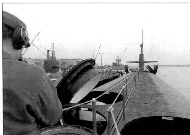
Открытые крышки ракетных шахт подводной лодки SSBN-726 «Огайо». Снимок сделан у причальной стенки верфи Электрик Бот.
