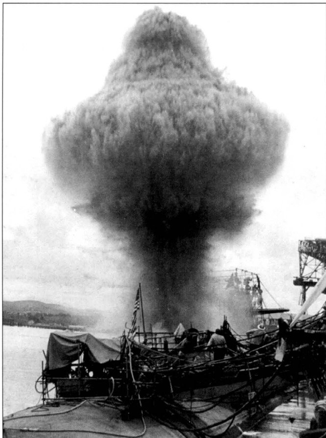
Выброс воды из ракетной шахты атомохода SSBN-634 «Стонуолл Джэксон», верфь на острове Мари, 17 мая 1964 г.
