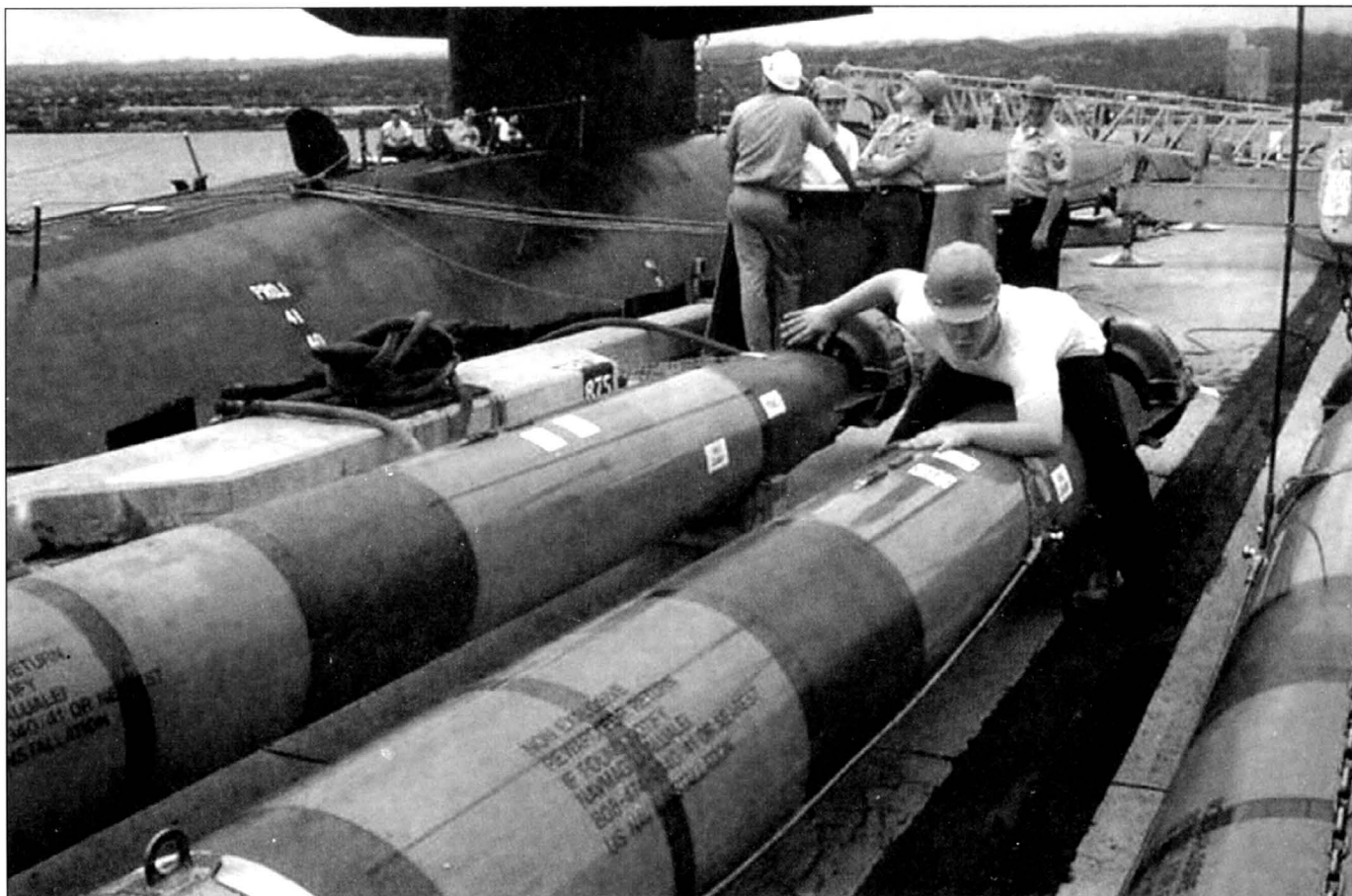
Торпедисты проверяют узлы крепления торпед Mk 48 перед их погрузкой на атомоход.
