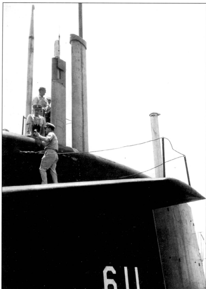
Крупный план рубки ракетносца SSBN-611 «Джон Маршалл», перископы и мачты выдвинуты. На руле глубины стоит командир атомохода.
