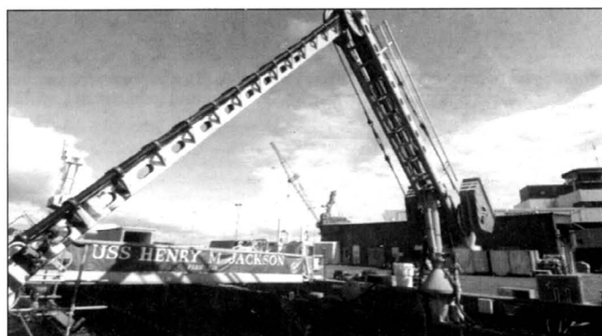
На стоянках в бортах реакторы атомных подводных лодок глушатся, а энергия на корабль подается с берега посредством кабелей и стрелы, стрелы обычно окрашены в желтый цвет.
