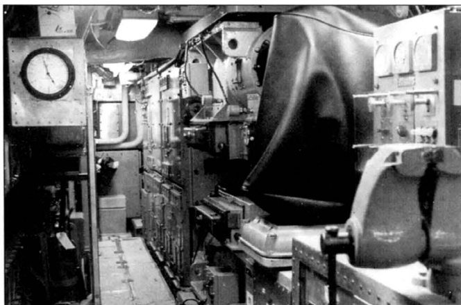
На атомоходе «Генри М. Джексон» имеются дизели, которые используются, прежде всего, в качестве резервных двигателей наряду с аккумуляторными батареями и электромоторами. Для обеспечения работы дизелей в подводном положении корабля имеется шпирхель.
