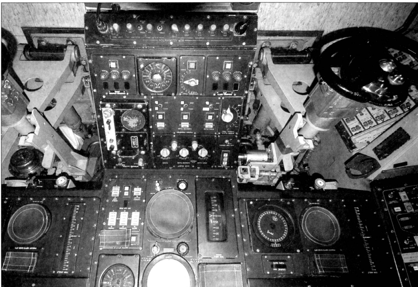
Консоль управления движением. Приборы, показывающие скорость хода и глубину погружения по соображениям секретности закрыты.
