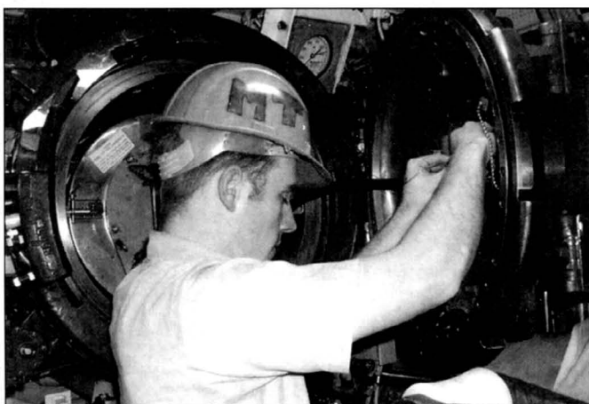
Перед тем, как закрыть крышку торпедного аппарата, торпедист прикрепляет к торпедке электроразъем. Торпеда Mk 48 оснащена совершенной и очень сложной системой управления, которая позволяет использовать торпеду в различных режимах атаки. Управление торпедой осуществляется по тонкому проводу, который после пуска связывает торпеду с субмариной.
