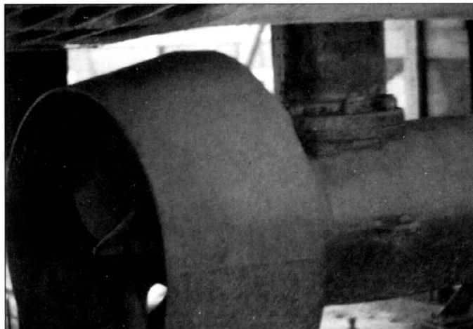
Подруливающее устройство - «375-сильный мотор». Подруливающее устройство необходимо при маневрировании в узкостях или в тесных акваториях портов. Устройство выдвигается при необходимости из корпуса атомохода, оно выполнено вращающимся на 360 градусов в горизонтальной плоскости. На практике пользуются им очень редко.
