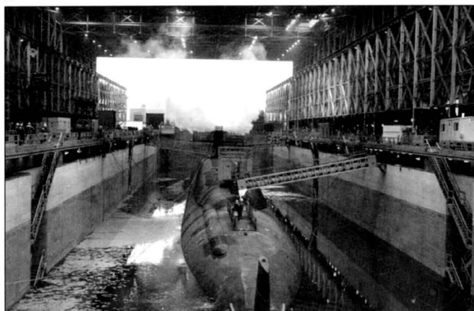
Корма атомохода «Небраска». Док находится в процессе осушки. В ходе послепоходного ремонта гребной винт обязательно снимается с лодки для вдумчивой инспекции и перебалансировки.
