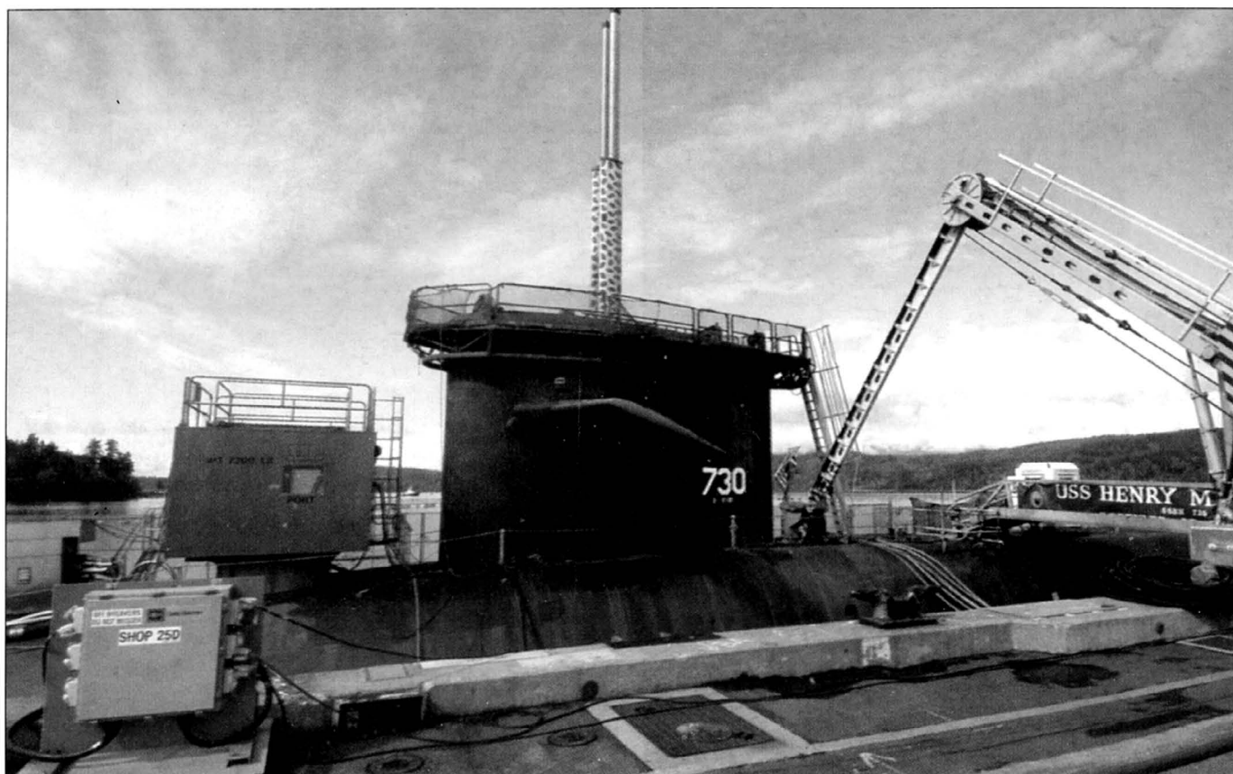
Средняя часть ракетносца «Генри М. Джексон». Короб красного цвета установлен над люком, через который на стоянке в корабль грузятся припасы, входят и выходят люди.
