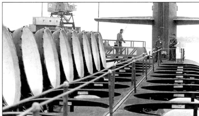
Моряк у крышки люка, предназначенного для технического обслуживания ракетной шахты.
