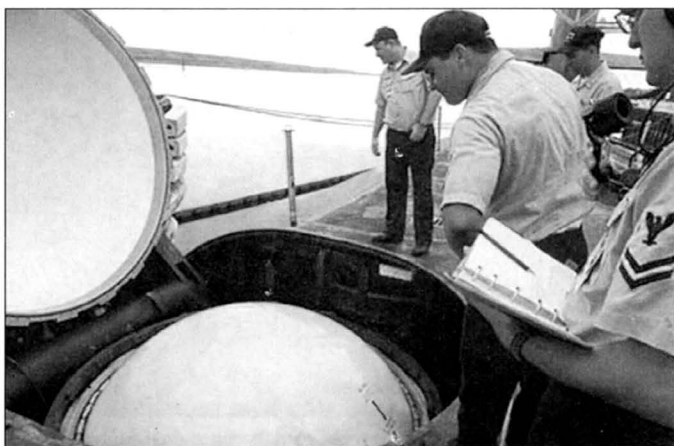
Из шахты торчит ярко-голубой обтекатель МБР «Трайдент II». В каждой из 24 шахт атомохода типа «Огайо» помещается одна баллистическая ракета «Трайдент I» или «Трайдент II». Одна ракета может нести до 14 боевых блоков Mk76/W88 мощностью по 475 кт. По договору ОСВ-2 количество боевых блоков на одной ракете ограничено пятью.
