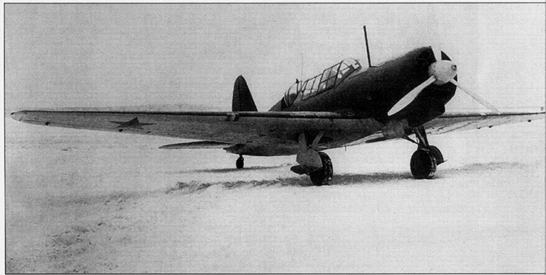
Серийный самолет Су-2 с мотором М-88Б. Production airplane Su-2 with M-88B engine.
