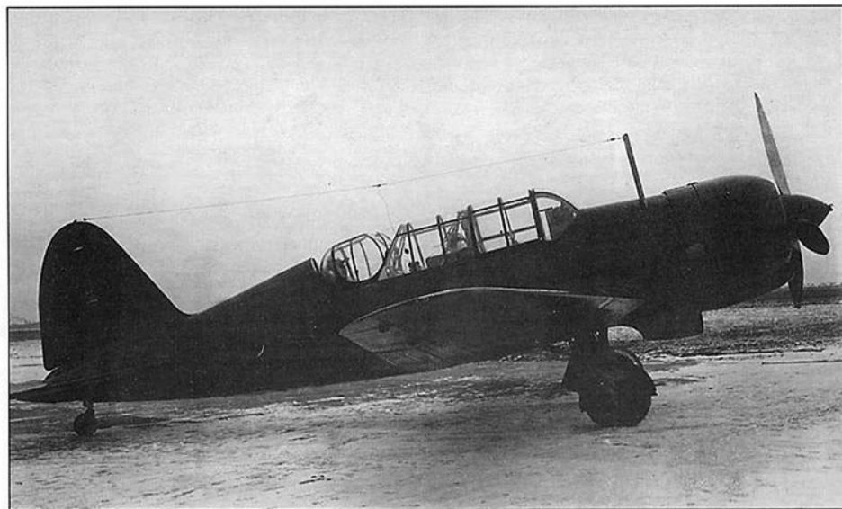
Серийный самолет ББ-1 с мотором М-87Б. Вид сбоку и 3/4 спереди. Production airplane BB-1 with M-87B engine. A side view and 3/4 in front.
