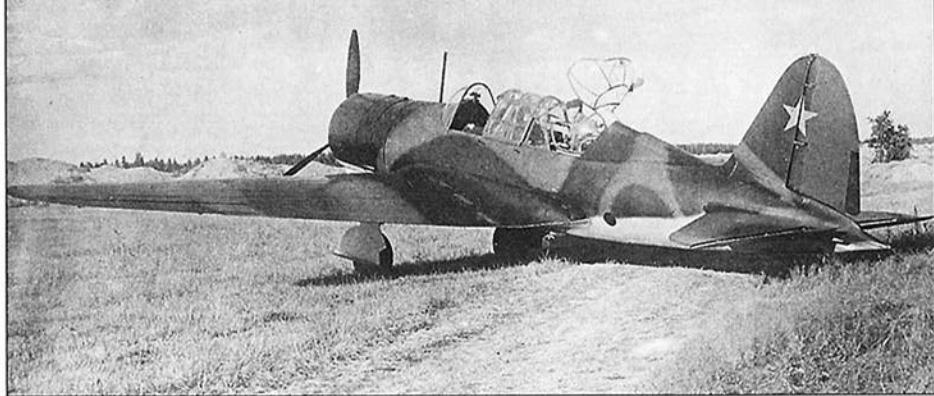
Су-2 в варианте арткорректировщика. Турель откинута. (Обтекатель поднят).
