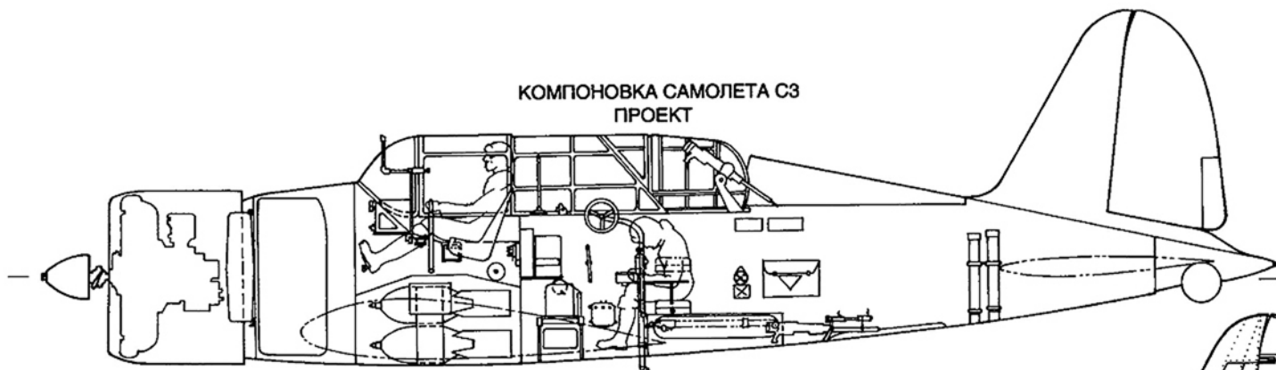
БОКОВАЯ ПРОЕКЦИЯ САМОЛЕТА СЗ С МОТОРОМ М-62. ПРОЕКТ
