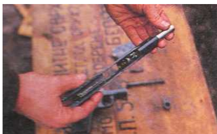
8. Извлеките ствол вместе с втулкой через переднюю часть кожуха затвора.
