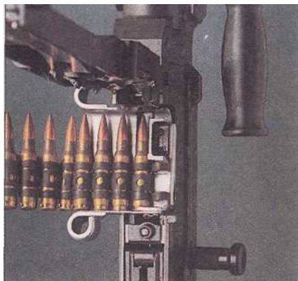
Устройство подавателя. Обратите внимание на то, что лента укладывается звеньями вверх и что первое звено свободно. Перед заряданием обязательно проверяйте ленту на отсутствие разрывов и повреждений.
