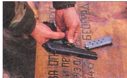
4. Извлеките крепежную шпильку с левой стороны.
