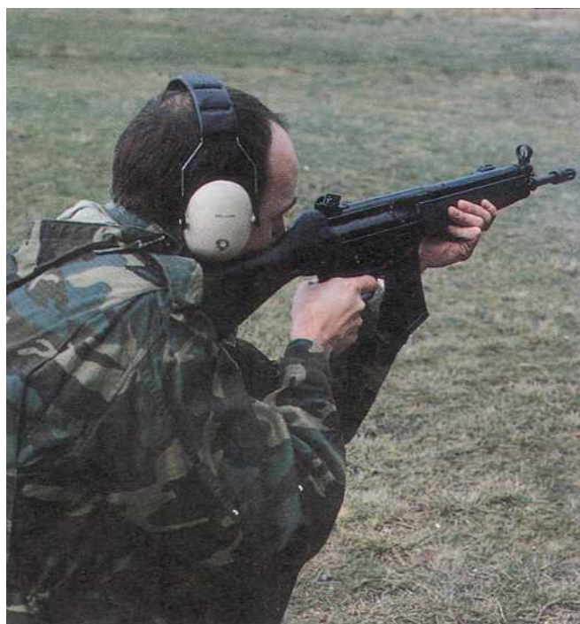
Ведется стрельба из винтовки НК-33. Версия G-3, переделанная под 5,56-мм патрон. Она выглядит более надежно и внушительно, чем М-16, но их технические характеристики практически схожи.
