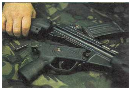
4. Поднимите верхнюю часть ствольной коробки.
