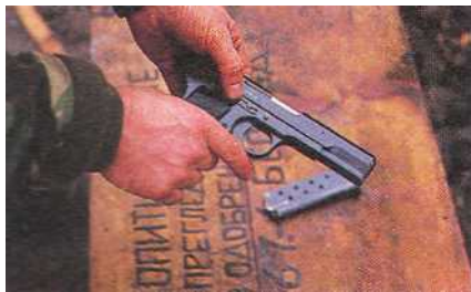
3. Задержка затвора и крепежная шпилька ствола расположены справа на рамке.
