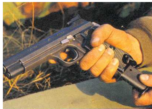
Защелка магазина расположена на основании пистолетной рукоятки. Это можно назвать единственным недостатком Р-210 как боевого пистолета. Защелка магазина, сделанная под большой палец, позволяет одной рукой извлекать магазин, а другой подносить новый.
