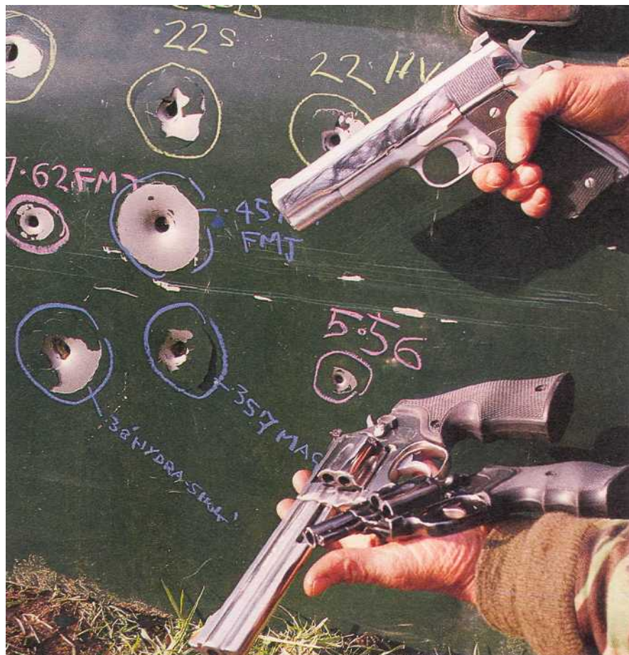
Пули калибра .45, выпущенные из М-1911, пробивают насквозь дверь машины.
