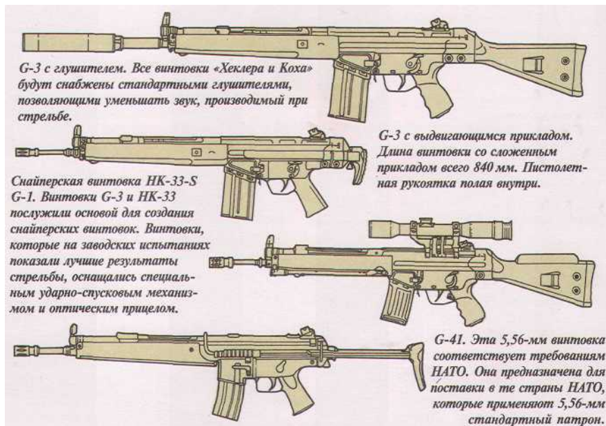
Вверху и внизу: К винтовке НК-33 присоединяется 25-зарядный магазин. Магазины отличаются от того, что применяется в американской М-16 и британской SA-80. В G-41 вы получаете дополнительно пять патронов.
