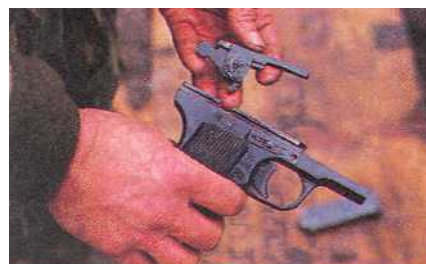
9. Извлеките ударно-спусковой механизм из рамки.
