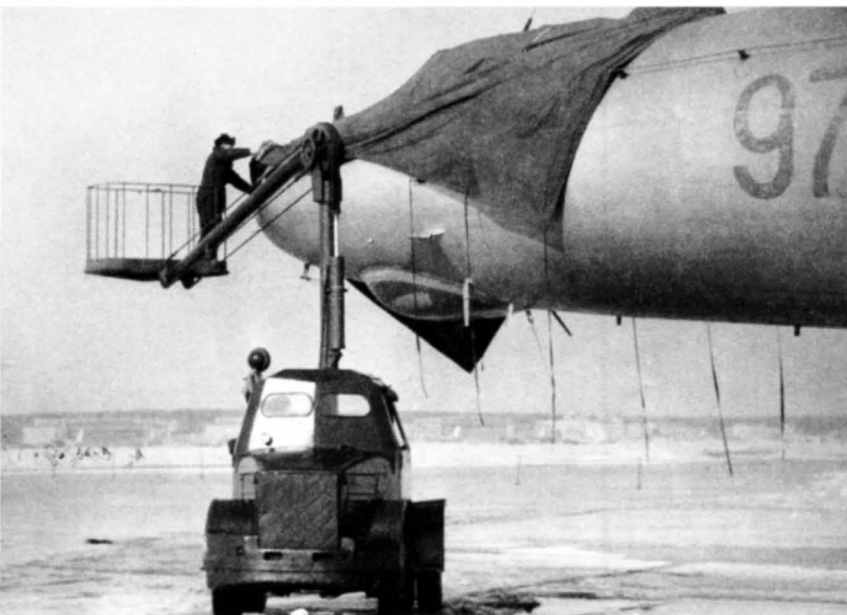
Чтобы зачехлить переднюю кабину М-4 требовался автоподъемник
