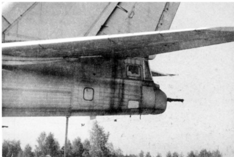
Кормовая артиллерийская установка с пушками АМ-23 самолета Ту-95МС первой серии, заимствованная с Ту-95М
