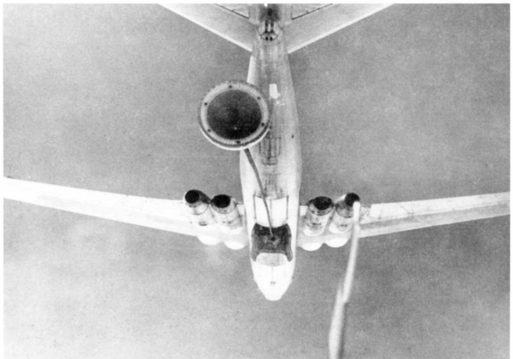
Выпуск топливо- заправочного шланга с самолета ЗМС-2
