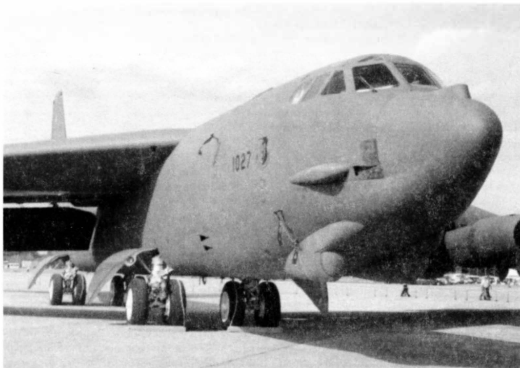
Под носовой частью фюзеляжа В-52Н в ходе эксплуатации разместили датчики оптико-электронной системы EVS
