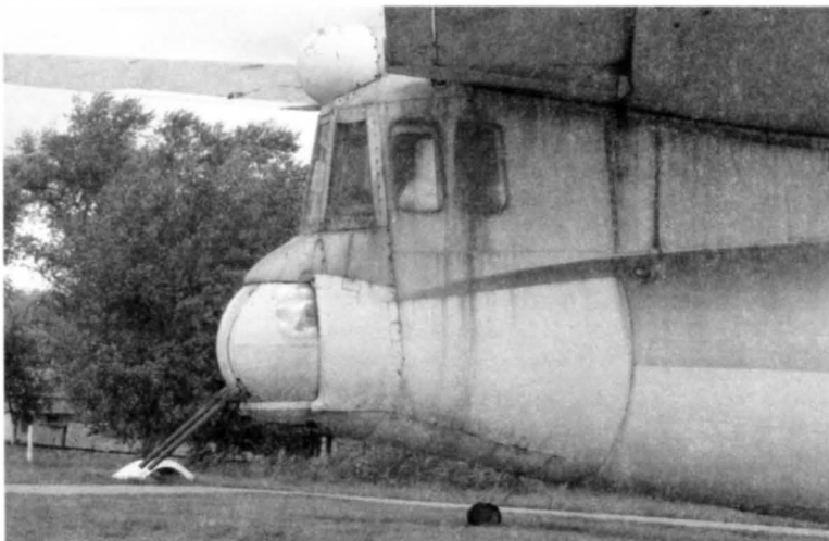
Кормовая артиллерийская установка М-4
