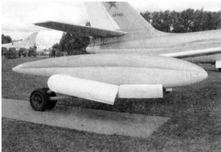
Крыльевая опора шасси самолета М-4
