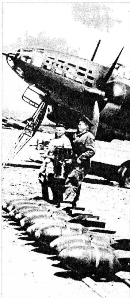
Подготовка бомбардировщика авиации Северного Флота к боевому вылету. Десять ФАБ-100, или «соток», как их прозвали на фронте, составляли обычную норму бомбовой нагрузки самолета Ил-4
