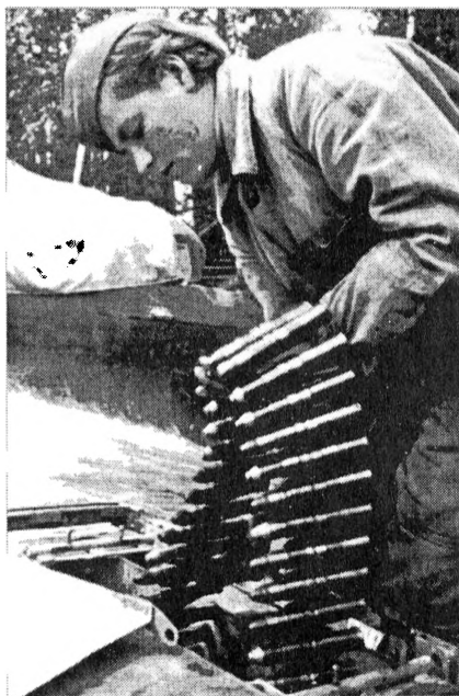
Оружейница пополняет боезапас крыльевых пушек штурмовика
