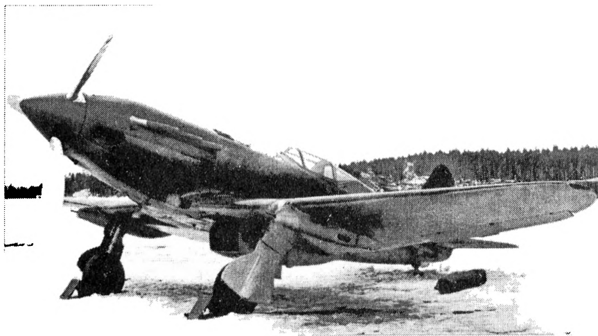
На истребитель МиГ-3 перед войной возлагали большие надежды, но он их не оправдал. Уже первые бои показали слабость бортового вооружения, которое иногда усиливали установкой двух подкрыльевых пулеметов УБК
