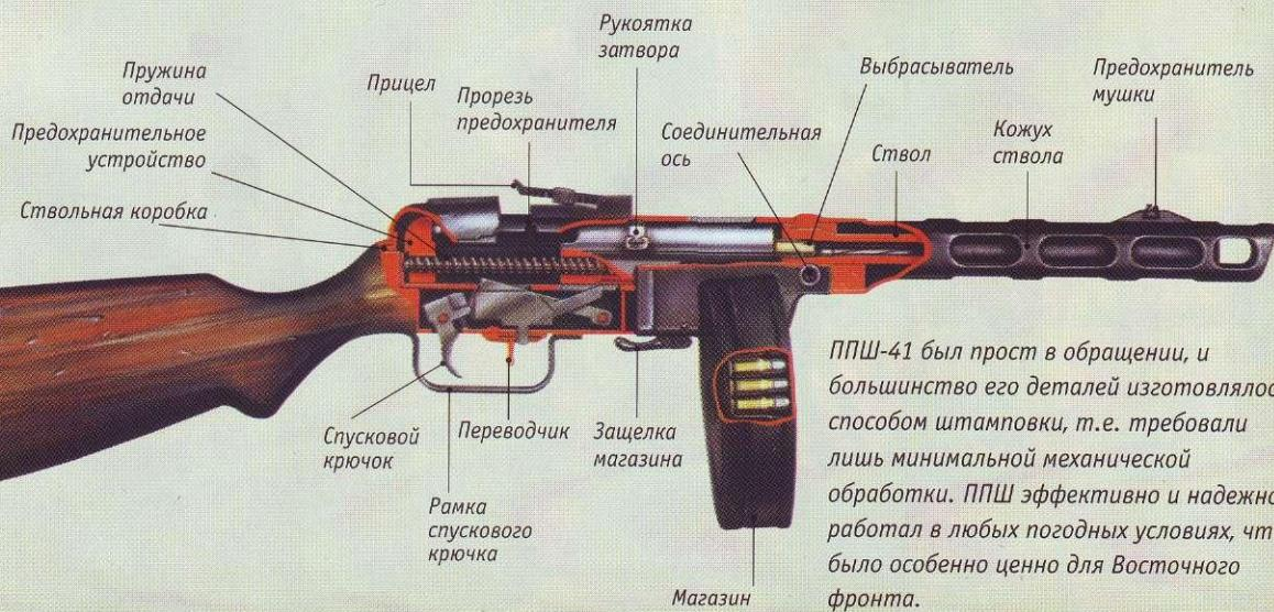
ППШ-41 был прост в обращении, и большинство его деталей изготавливались способом штамповки, т.е. требовали лишь минимальной механической обработки. ППШ эффективно и надежно работал в любых погодных условиях, что было особенно ценно для Восточного фронта.
