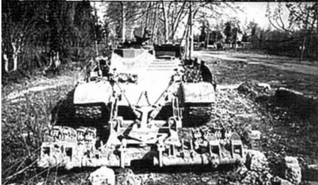
*Боевая машина разминирования БМР создана на базе Т-55: тот же корпус танка со снятой башней, усиленный бронированием днища и навешенными минными тралами. Обеспечивает действия войск и движение войсковых колонн на заминированной местности— производит траление мин, проделывает проходы в минных полях*
