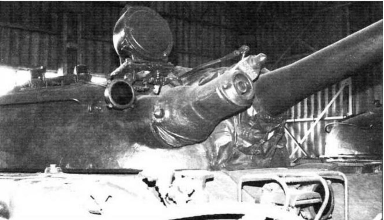
*Автоматический танковый огнемет АТО-200 установлен на месте спаренного с пушкой пулемета*
