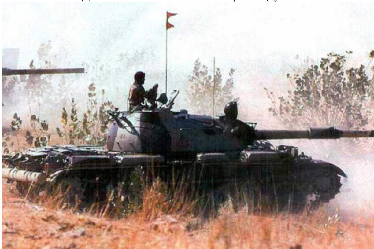
*Танк Т-55 армии Индии с ложным эжектором на стволе орудия*
