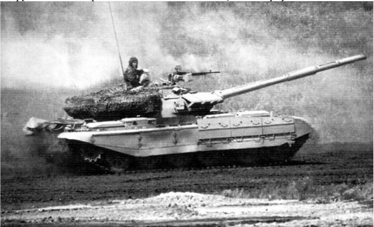
*Танк Т-55М(6) с вооружением от Т-72Б; подвеска танка— с шестью катками*
