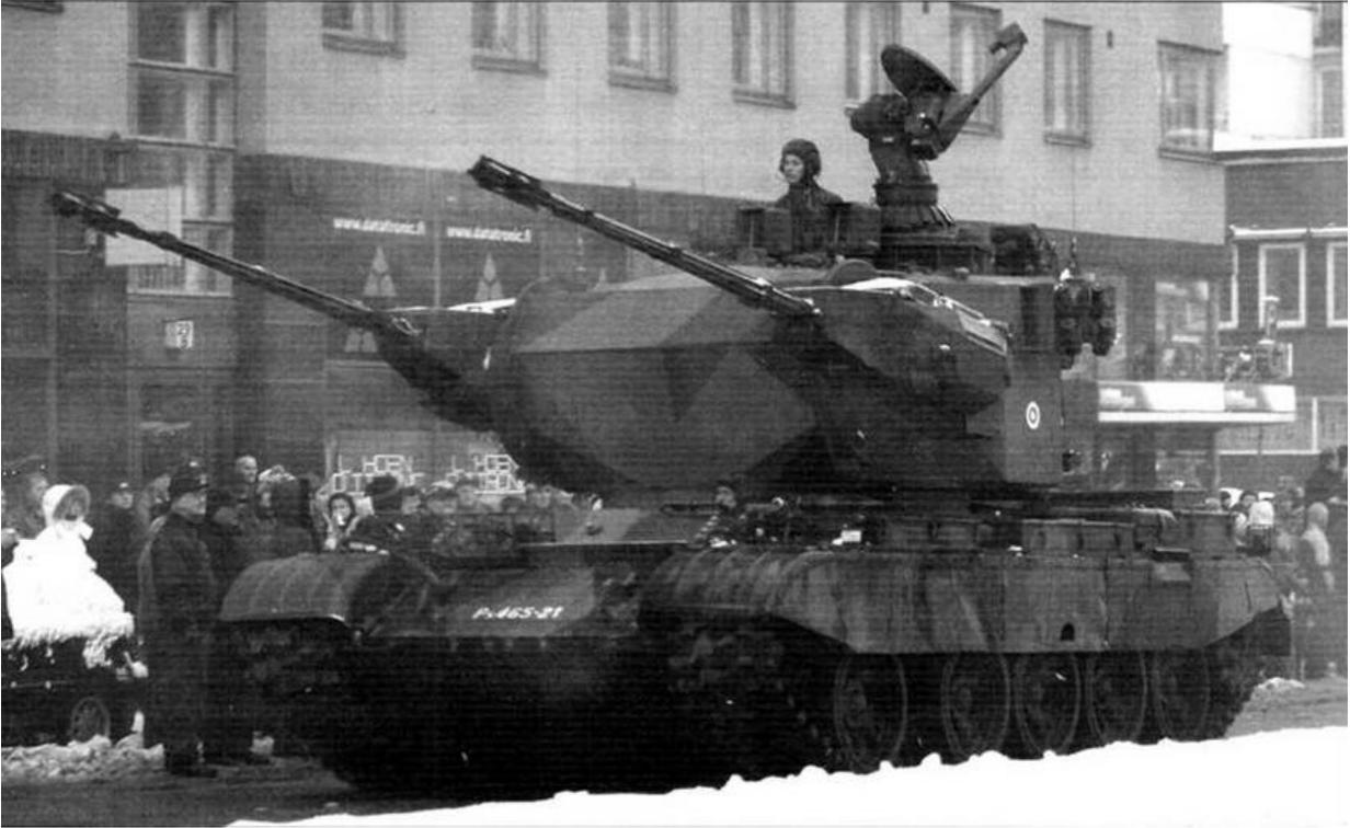
*6 декабря— День независимости Финляндии. Это наиболее церемониальный национальный праздник. В этот день на всех учреждениях подняты флаги, проходит военный парад. На фото — зенитная самоходная установка на шасси танка Т-55 с боевым модулем «Марксмен», двумя 35-мм швейцарскими зенитными пушками «Эрликон». Разработка Великобритании.*
