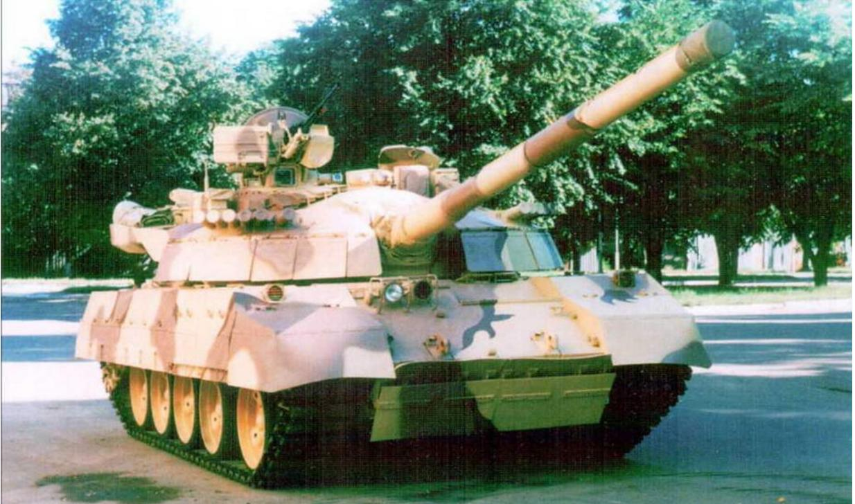
*Танк Т-55АГМ, вооруженный 125-мм гладкоствольной пушкой с автоматом заряжания*
