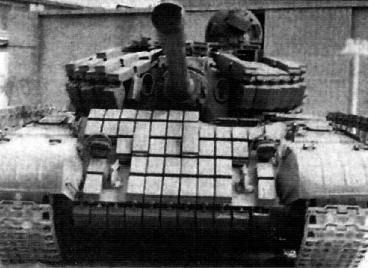
*Основной танк Ирана «Сафир-74» — глубокая модернизация Т-54/55 и разработанных на их основе «Тип 59» и «Тип 69». Устаревшая 100-мм пушка заменена на этих машинах на 105-мм L7, установлена модернизированная СУО и усилено бронирование*
