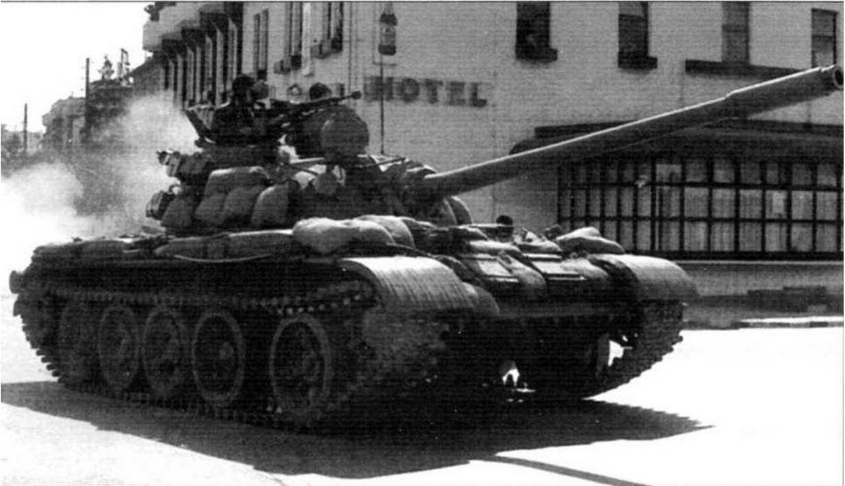
*Танк Т-55А Македонии. Для дополнительной защиты на броню уложены мешки с песком. Март 2001 года*
