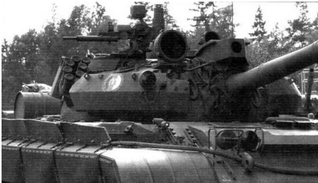
*Передняя часть башни танка «Кладиво» с СУО. Лазерный дальномер на маске орудия*
