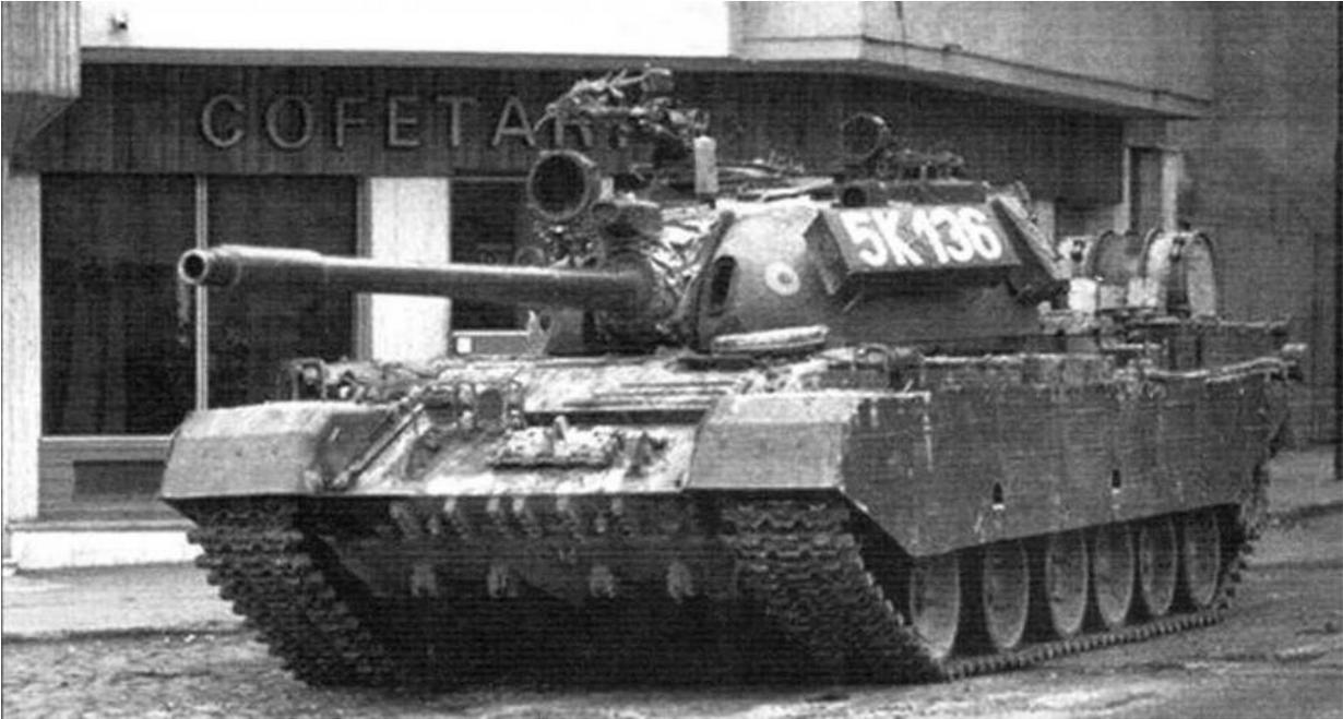
*Румынский танк TR-85. Установка более мощного немецкого дизеля заставила увеличить длину корпуса и поставить подвеску с шестью катками*
