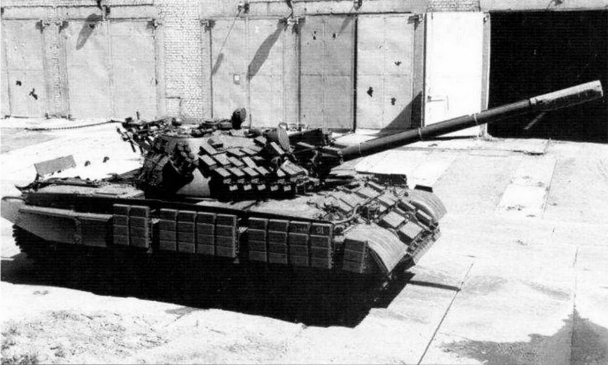
*Модернизированный танк Т-55АМВ с комплексом «Контакт-1»*
