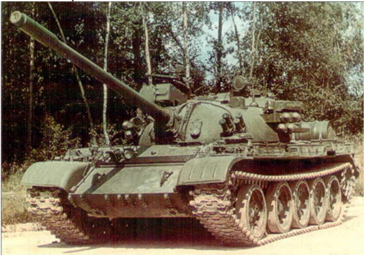
*Танк Т-55АД с комплексом активной защиты «Дрозд»*
