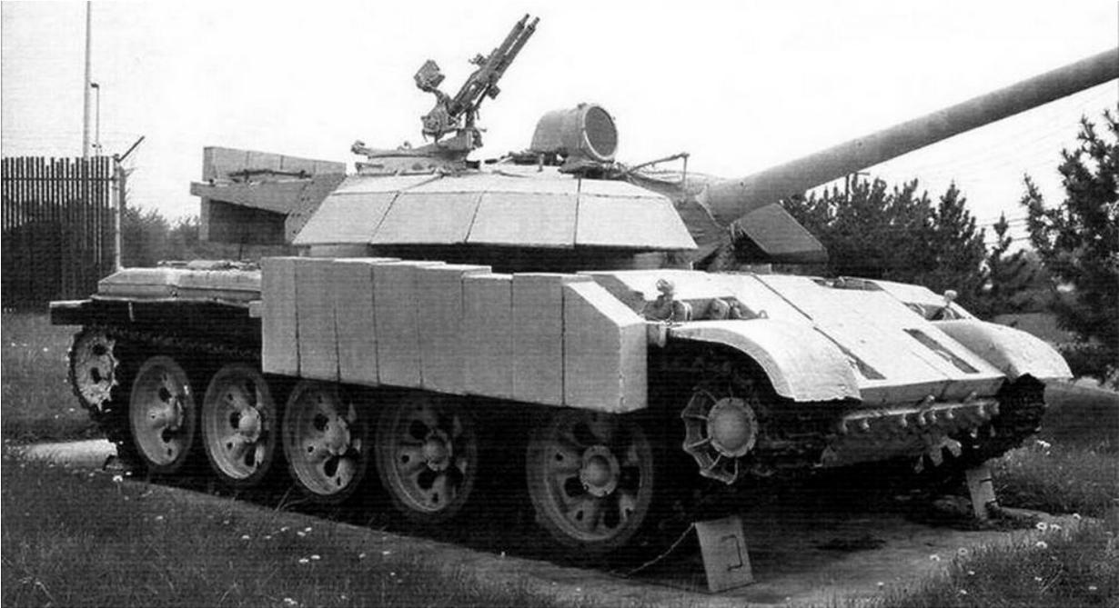
*Иракский Т-55 «Энигма» с дополнительным бронированием корпуса и башни*
