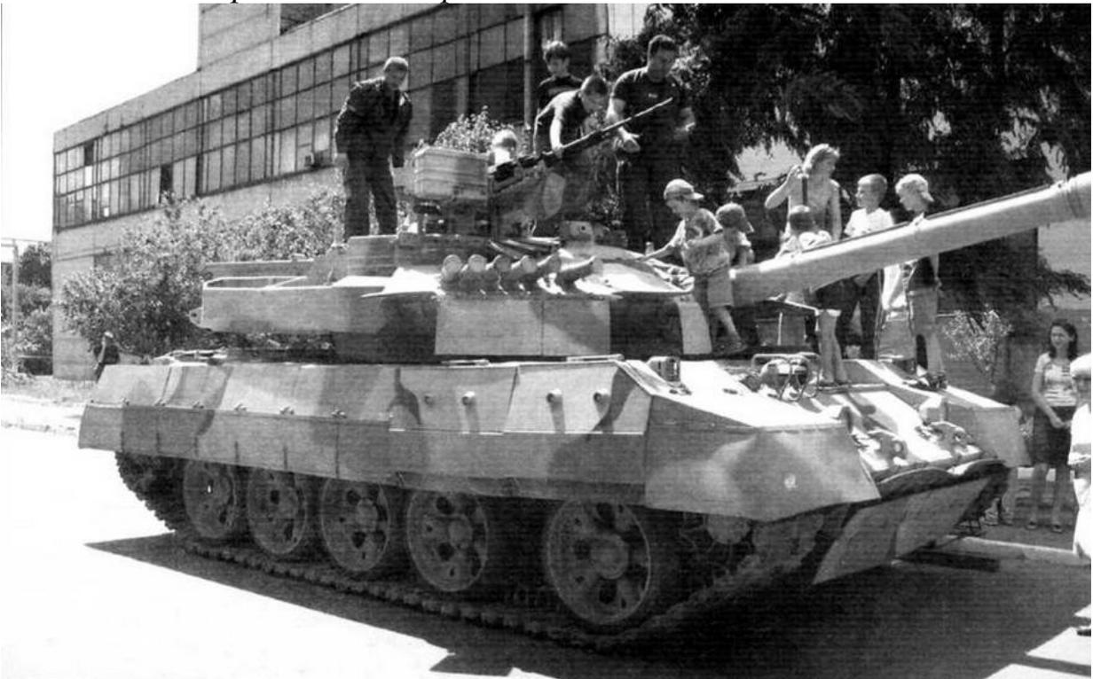
*Танк Т-55АГМ с новым двухтактным двигателем БТД, 125 мм гладкоствольной пушкой, СУО и комплексом динамической защиты «Нож»*
