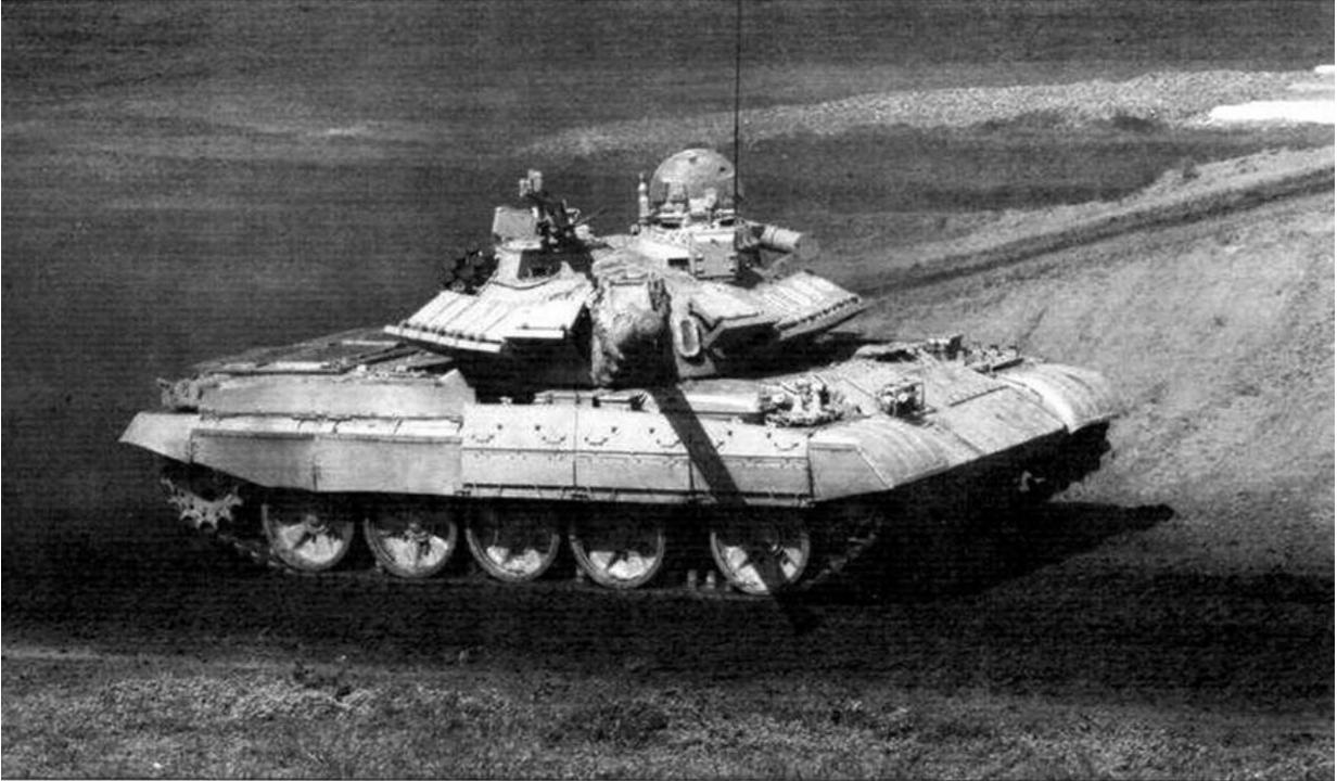
*Танк Т-55М(5) омского завода с комплексом управляемого вооружения и встроенной динамической защитой корпуса и башни*
