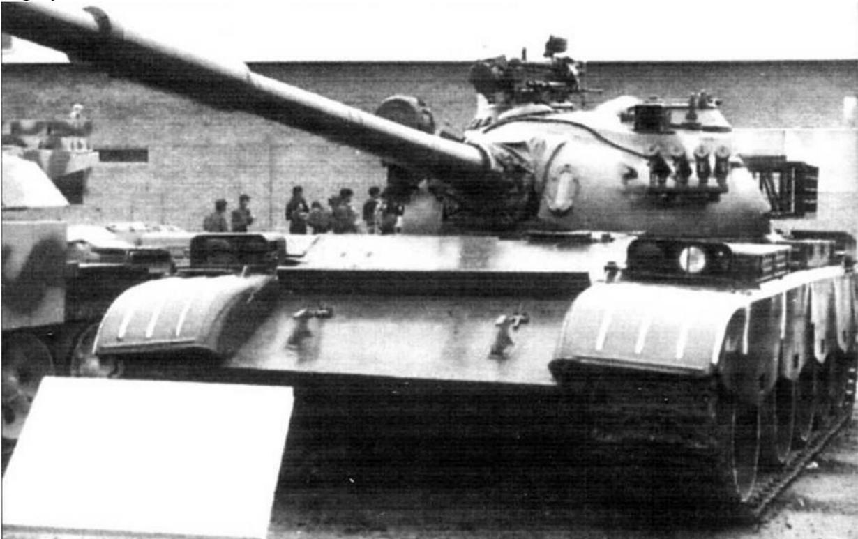
*Иракский вариант модернизации Т-55. Танк оснащен 125-мм гладкоствольной пушкой 2А46 с автоматом заряжания*
