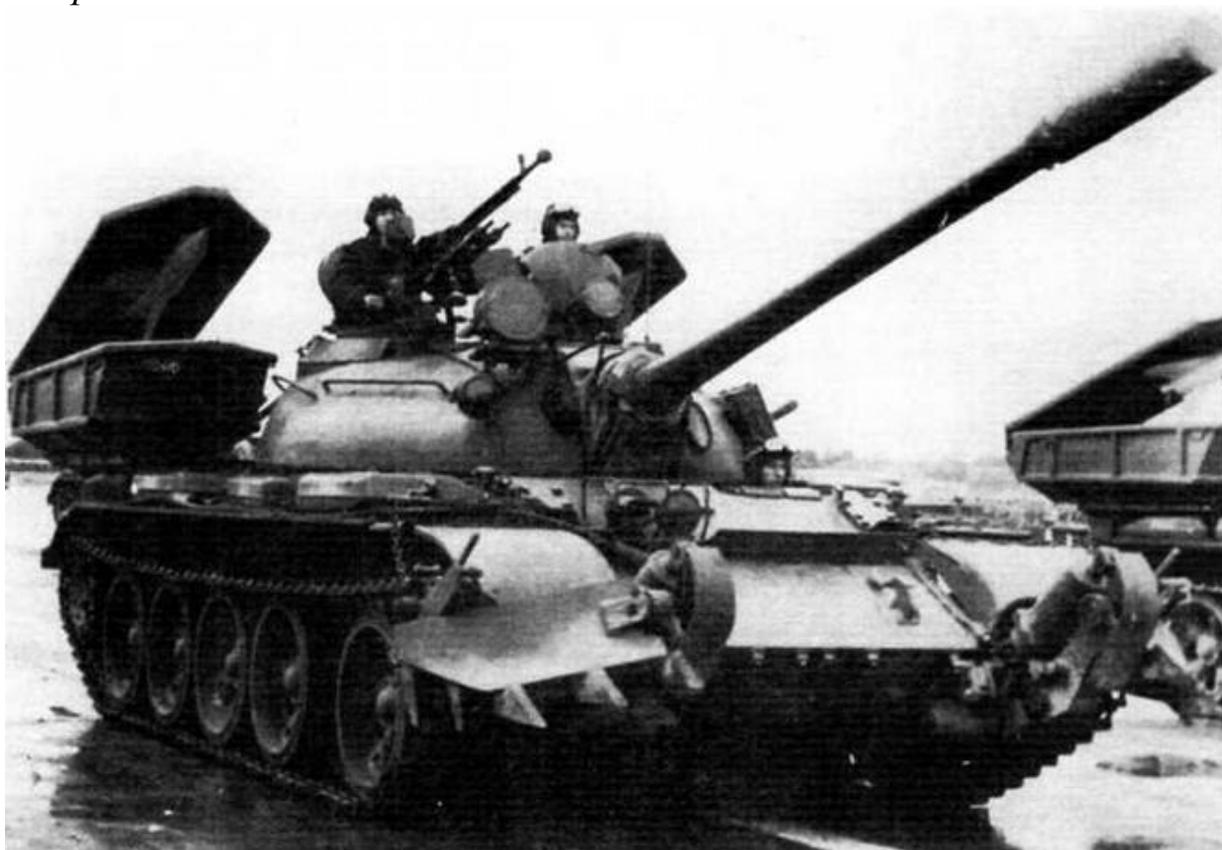
*Польский танк Т-55. Дополнительно вооружен советскими противотанковыми управляемыми ракетами «Шмель»*
