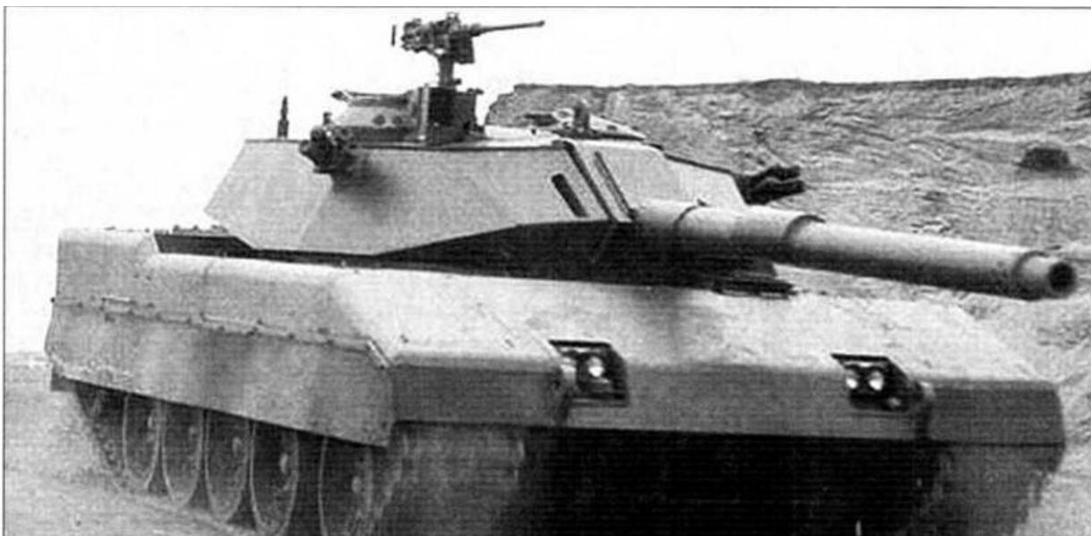
*Американо-китайский «Ягуар» с нарезным 105-мм орудием, электронной системой управления огнем и двигателем, разработанными для легкого американского танка «Стингрей»*
