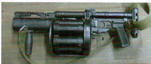
40-мм ручной гранатомет 6-зарядный 6Г-25; справа – заряжание
