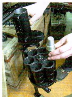
40-мм ручной гранатомет 6-зарядный 6Г-25; справа – заряжание
