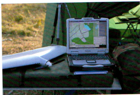
БПЛА «Груша» (слева: аппарат и управляющий ноутбук; справа: отображаемая на мониторах ноутбуков получаемая информация в режиме реального времени)
