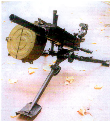
Автоматический гранатомет АГС-30 с ленточным питанием
