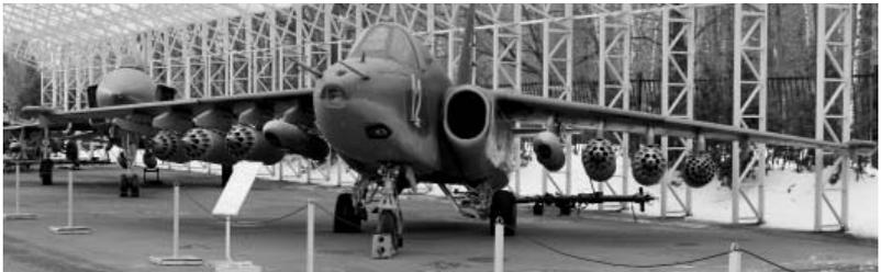
Штурмовик **Су-25** и два **НАРа С-5** калибра 57 мм в блоке **УБ-32-57** и четыре **НАР С-8** калибра 80 мм в блоках **Б-8** и пулемёты **ГШ-23Л** калибра 23 мм в блоках **СППУ-22**. *Фото Геннадий Шубин*
