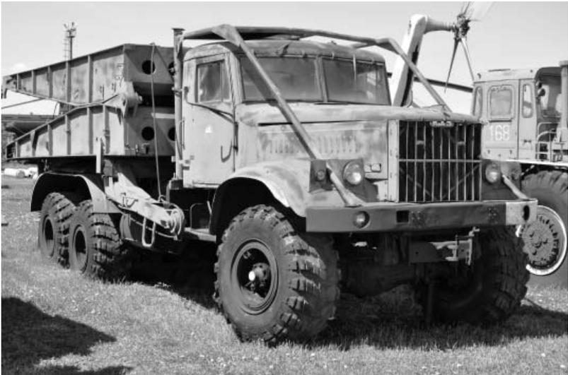
Тяжёлый механизированный мост (ТММ-3) на шасси **КРАЗ-255Б**.
