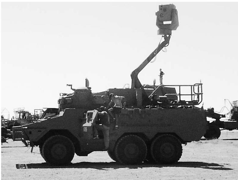
Система управления артиллерийским огнём на шасси бронетранспортёра **Рател** южноафриканского производства. *Фото Ян Либенберг*
