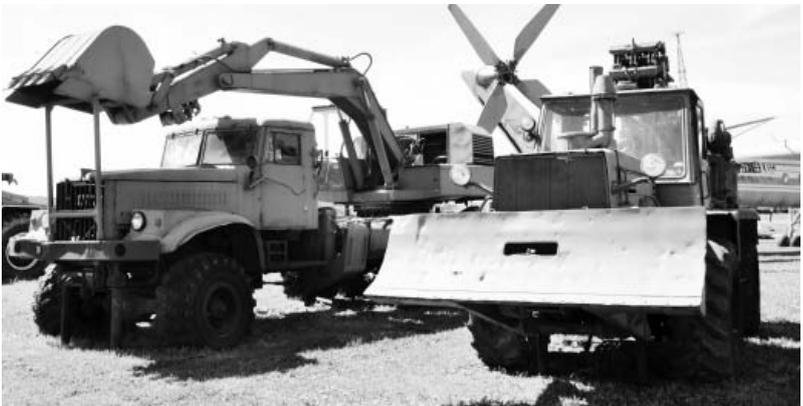
Экскаватор **ЭОВ-4421** (на шасси грузовика **КРАЗ-255Б**) и полковая землеройная машина (**ПЗМ-2**). *Фото Вячеслав Барабуля*
