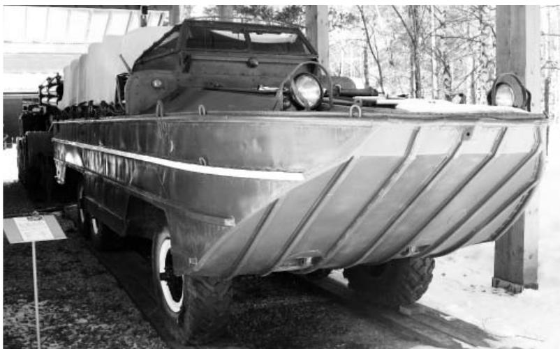
**ЗИС-485.** Большой автомобиль водоплавающий. *Фото Геннадий Шубин*
