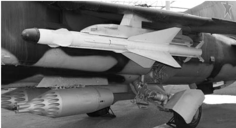
**R-23** (дальность пуска до 35 километров) и **C-8** (20 неуправляемых ракет калибра 80 мм) истребителя-бомбардировщика **Миг-23**. Фото Геннадий Шубин
