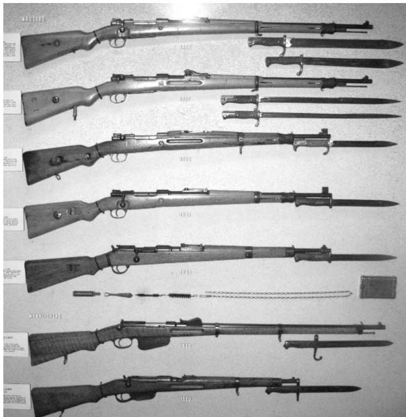
Немецкие винтовки и карабин **Маузер** калибра 7,92 мм; винтовка **Манлихер** калибра 11 мм и карабин **Манлихер** калибра 8 мм. Фото Геннадий Шубин
