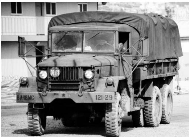
Грузовик **M35** американского производства грузоподъёмностью в 2,5 тонны. Фото из сети Интернет
