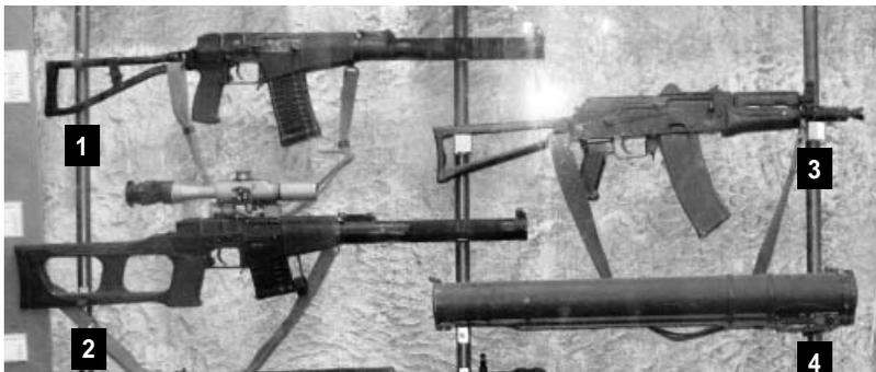
1. Бесшумная снаперская винтовка **Винторез** калибра 9 мм.
