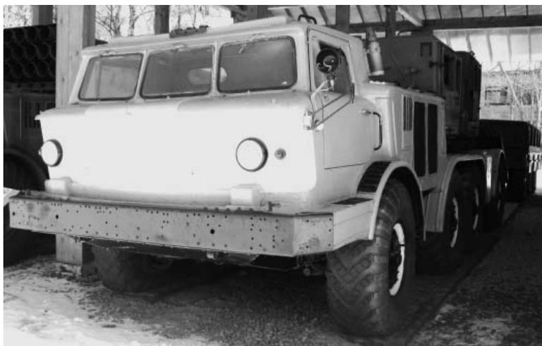
**ЗИЛ135ЛМ.** Грузоподъемность девять тонн, двигатель бензиновый. *Фото Геннадий Шубин*
