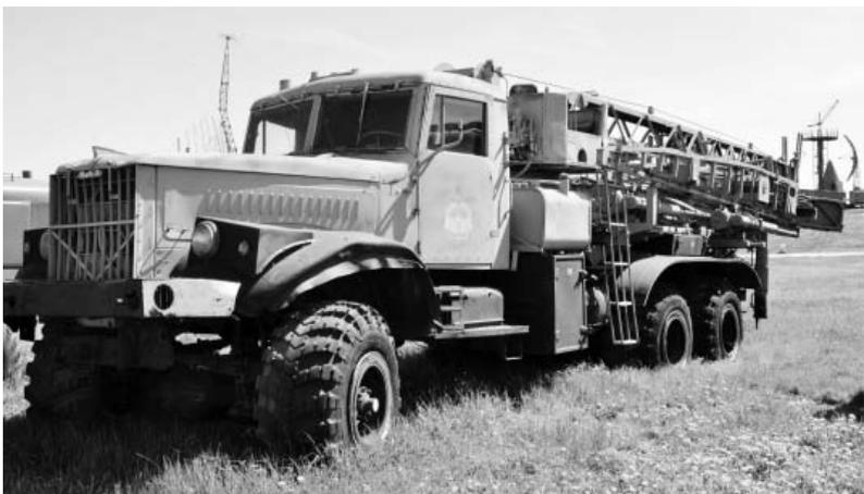
Мостостроительная установка **УСМ** на шасси **КРАЗ-255Б**. *Фото Вячеслав Барабуля*
