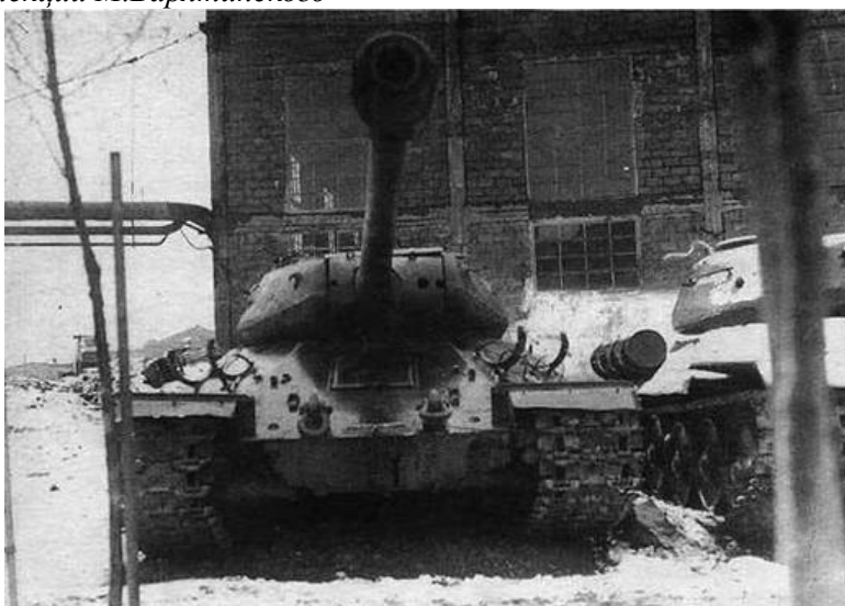
Танк ИС-6 с электротрансмиссией во дворе завода. Интересная деталь: кронштейны для крепления наружных топливных баков располагались и на скошенных передних бортовых листах корпуса. Фото из коллекции Г.Петрова
