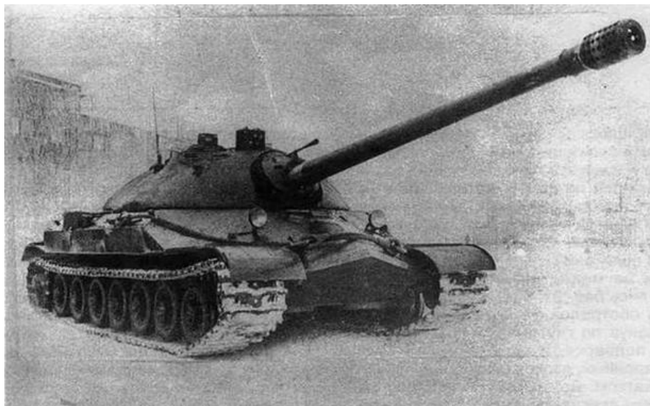
Опытный образец 1948 года во дворе завода. На этой машине отсутствуют пулеметы в корме башни и зенитная установка.
