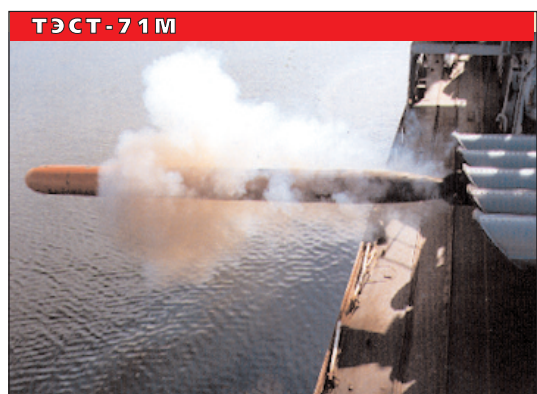
Торпедные аппараты надводных кораблей служат для выстреливания многоцелевых торпед или противолодочных ракет. Основной калибр — 533 мм
