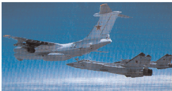
Дозаправка топливом МиГ-31 от танкера Ил-76 в полете
