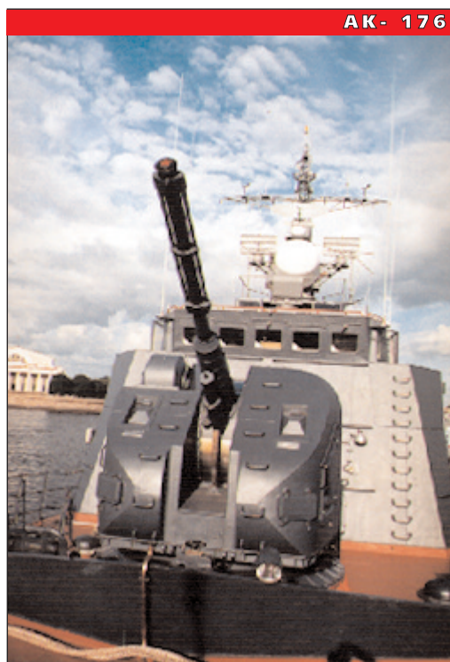
АК-176 — высокоскорострельная артиллерийская установка — 76-мм орудие, главное назначение которой — поражение средств воздушного нападения. Применяется радиовзрыватель, срабатывающий при подходе к цели. Состоит на вооружении большинства надводных кораблей
