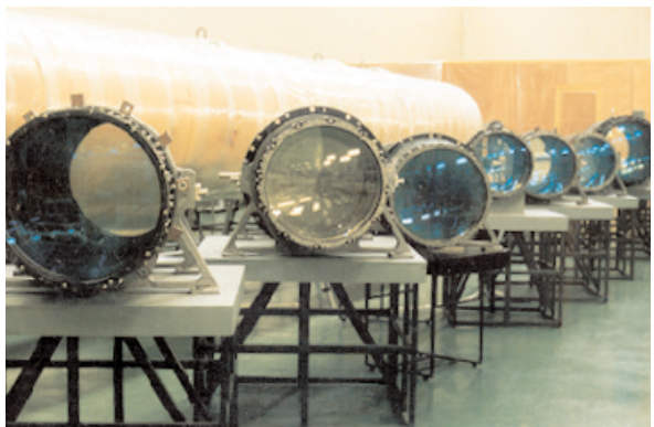
Линзовые объективы космической аппаратуры производства Красногорского завода им. С.А.Зверева
