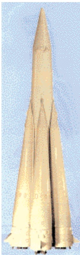
Ракета Р-7 (Р-7А) – первая межконтинентальная баллистическая ракета. Выполнена по пакетной схеме. Система управления комбинированная, с радиоуправлением
