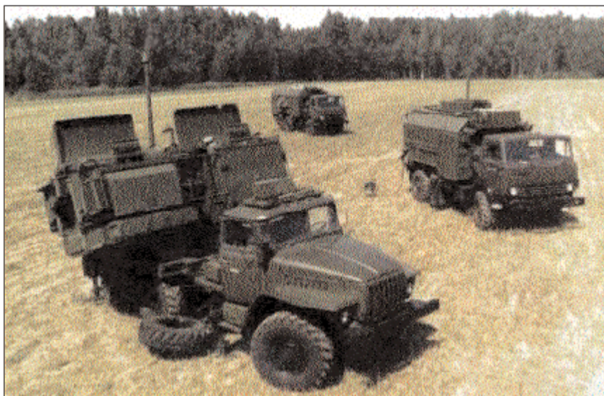
Станция мощных шумовых помех для комплексной защиты наземных систем вооружения от радиолокационной разведки и защиты объектов от нападения с воздуха
