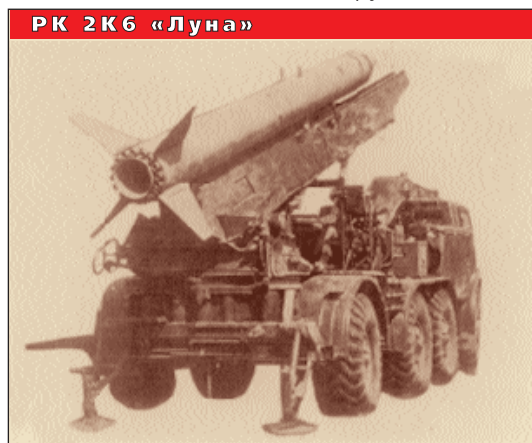
Тактический ракетный комплекс 2К6 «Луна» с ракетой, оснащенной ядерной боевой частью
