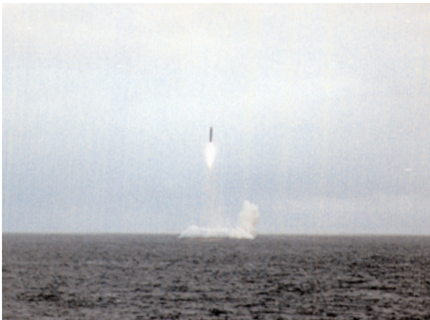
Пуск БРПЛ с РПКСН, находящегося в подводном положении. При залповой стрельбе ракеты стартуют через каждые 7–10 с
