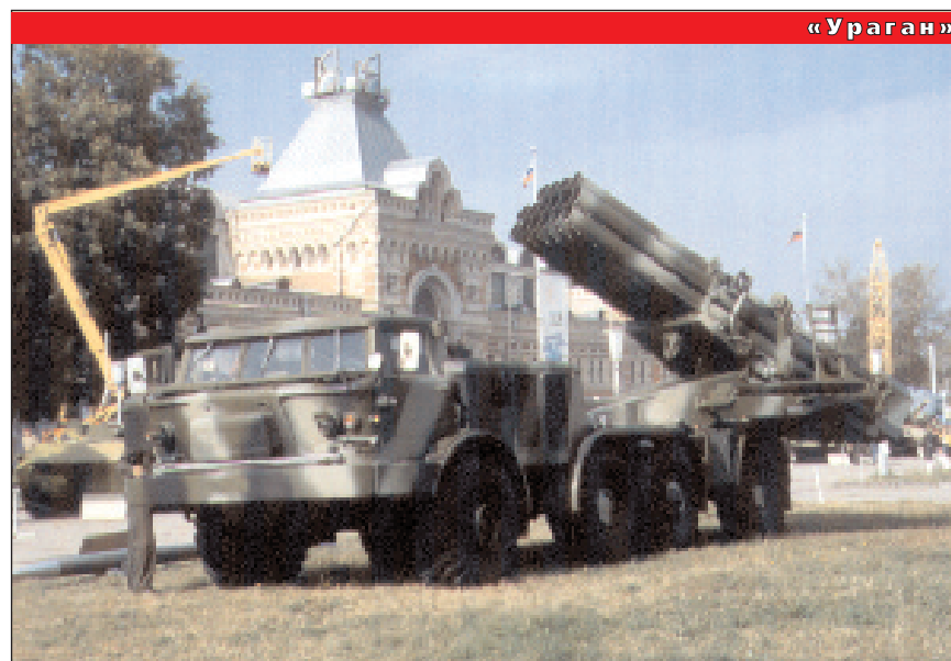
Реактивная система залпового огня «Ураган», обеспечивает дальность стрельбы до 34 км с 16 направляющих; масса реактивного снаряда 280 кг
