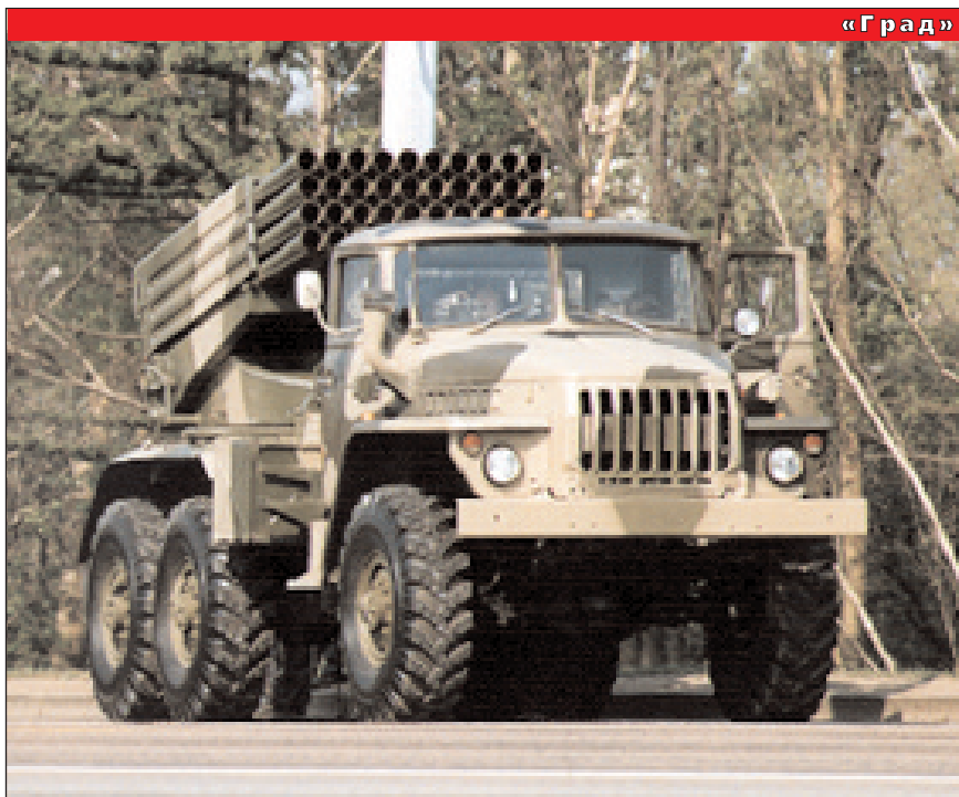
Реактивная система залпового огня 9К51 «Град». С его созданием в 1963 г. начался новый этап в развитии этого вида оружия
