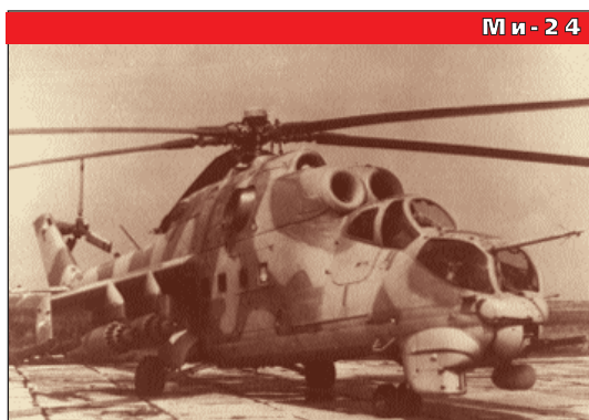
Ми-24 — боевой вертолет, предназначенный для поражения броневой техники и живой силы противника, перевозки десанта и разведки. В серийном производстве с 70-х гг.
