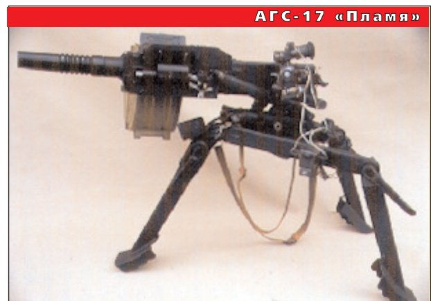
30-мм автоматический станковый гранатомет АГС-17 «Пламя» с прицельной дальностью стрельбы 1700 м. Обеспечивает темп стрельбы 350-400 выстрелов в минуту
