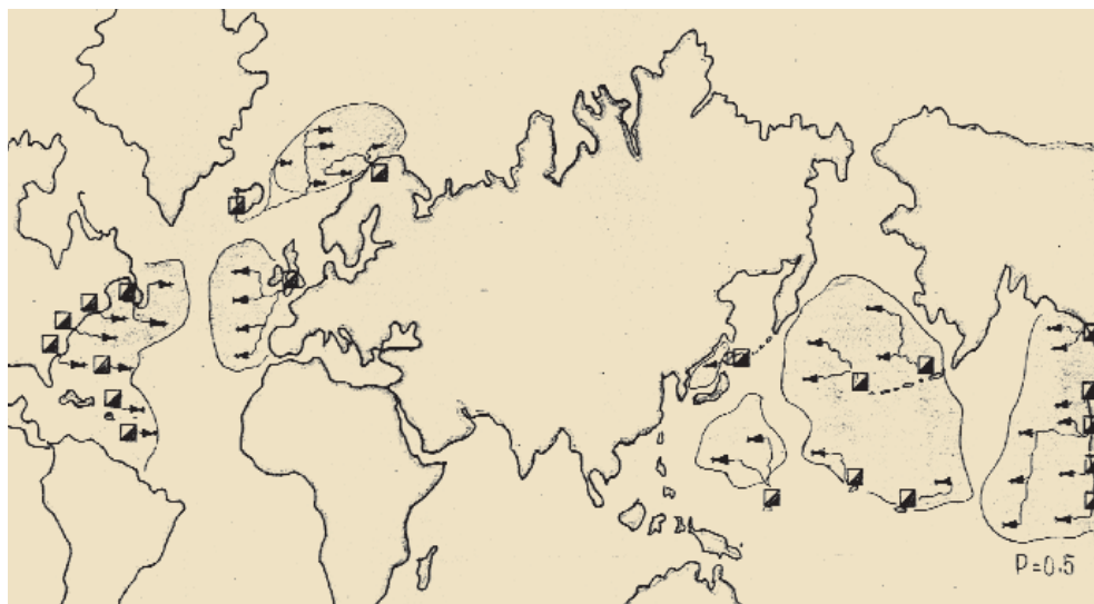
Схема американской системы средств подводного наблюдения «Сосус»
