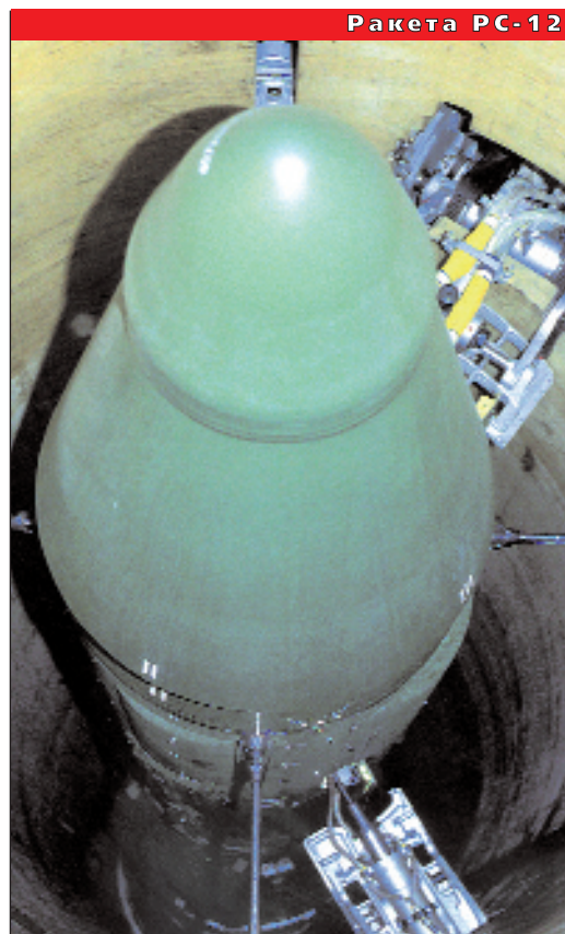
Ракета РС-12 Стратегическая межконтинентальная твердотопливная ракета РС-12 — трехступенчатая, с четырьмя маршевыми двигателями. Оснащена моноблочной головной частью. РС-12 — первая отечественная межконтинентальная ракета на твердом топливе
