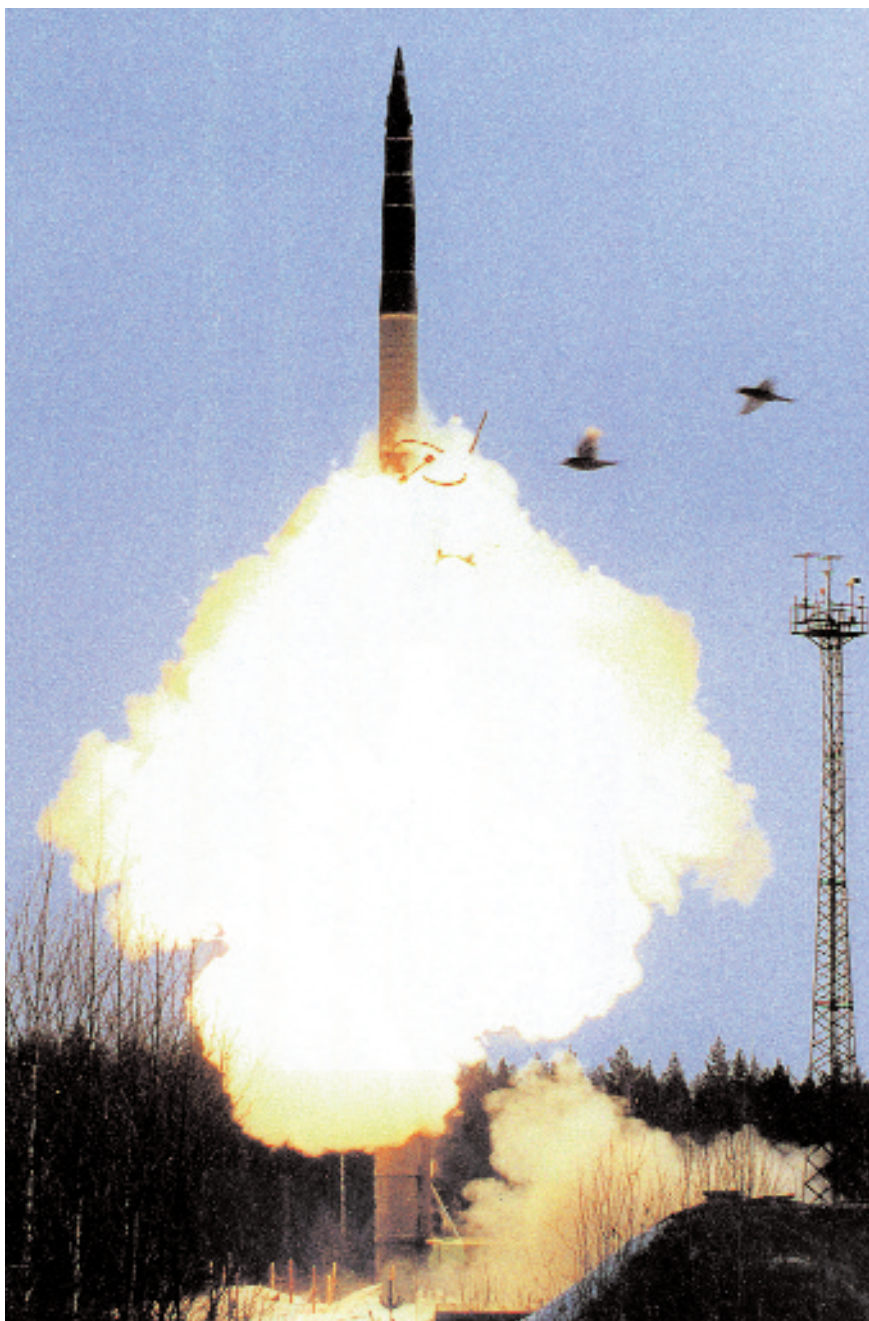
Старт межконтинентальной твердотопливной ракеты «Тополь» (SS-25) подвижного грунтового базирования
