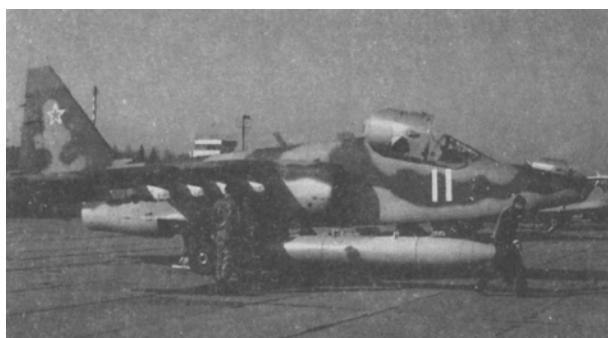
Если по полетному заданию нет необходимости заправлять подвесные баки, их снимают с самолета и усилиями четырех человек переносят на специальные подставки за пределами ЦЗ.
