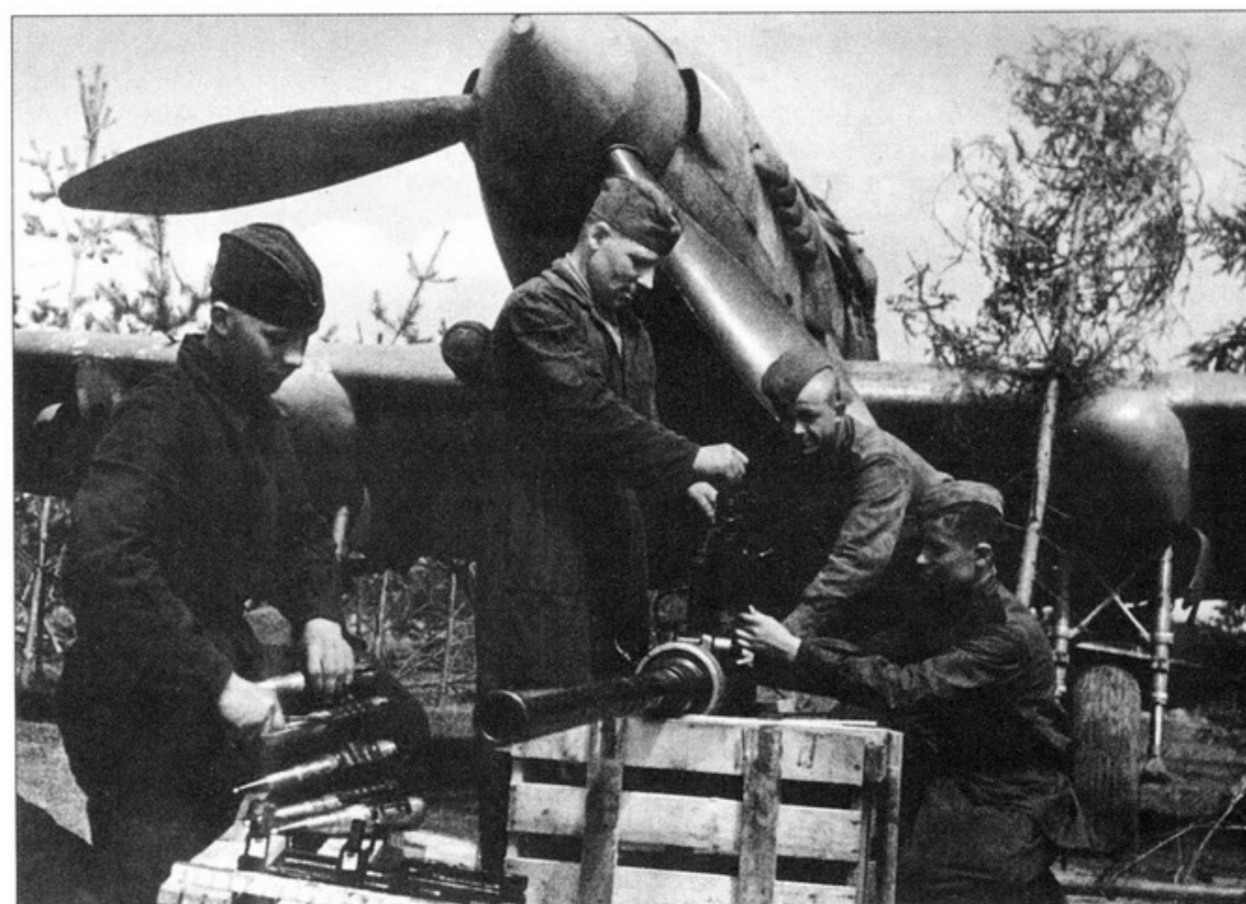
Пушка НС-37. Оружейники за работой. Слева виден обтекатель пушки с откинутой крышкой.
