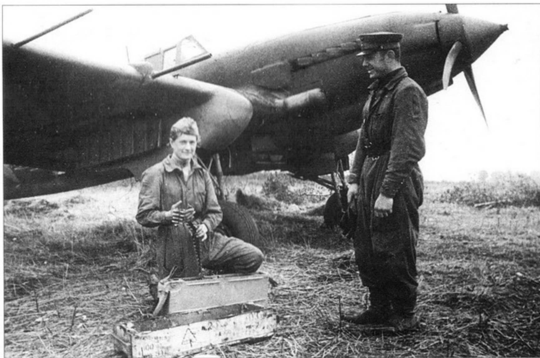
Гвардии ефрейтор Н.Н.Окунева готовит РС к подвеске и укладывает ленту в патронный ящик пулемета ШКАС. 59 Гв.ШАП Центральный фронт, 1 октября 1943 г.
