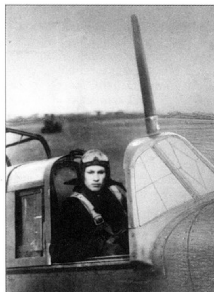
Установка приемопередающей радиоантенны на козырьке фонаря кабины Ил-2КР
