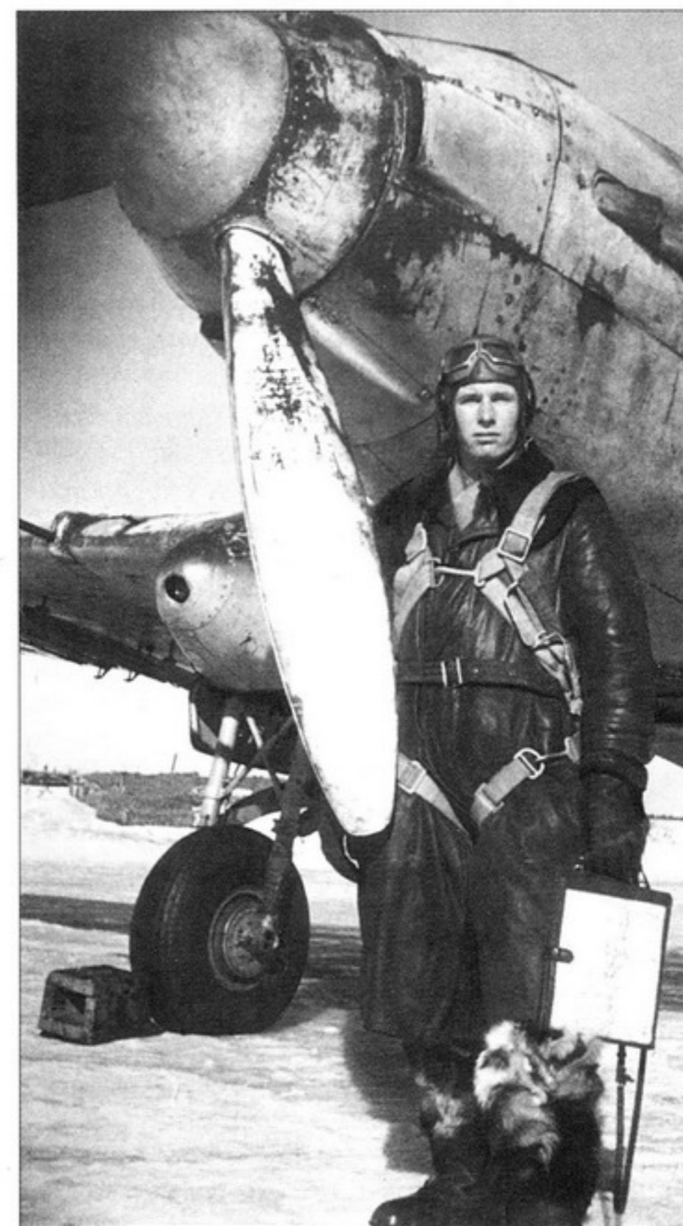
Ст. лейтенант Н.Перелыгин у своего самолета. В правом обтекателе шасси виден установленный там фотопулемет.
