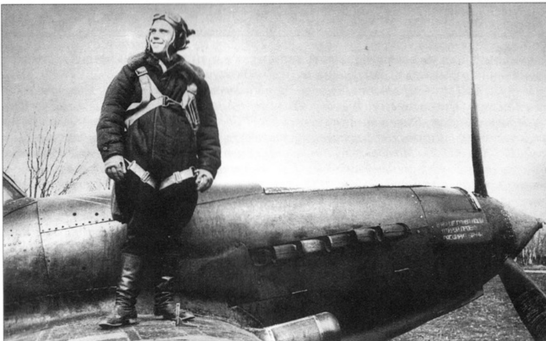
Под ногами летчика виден штырь механического указателя положения шасси.
