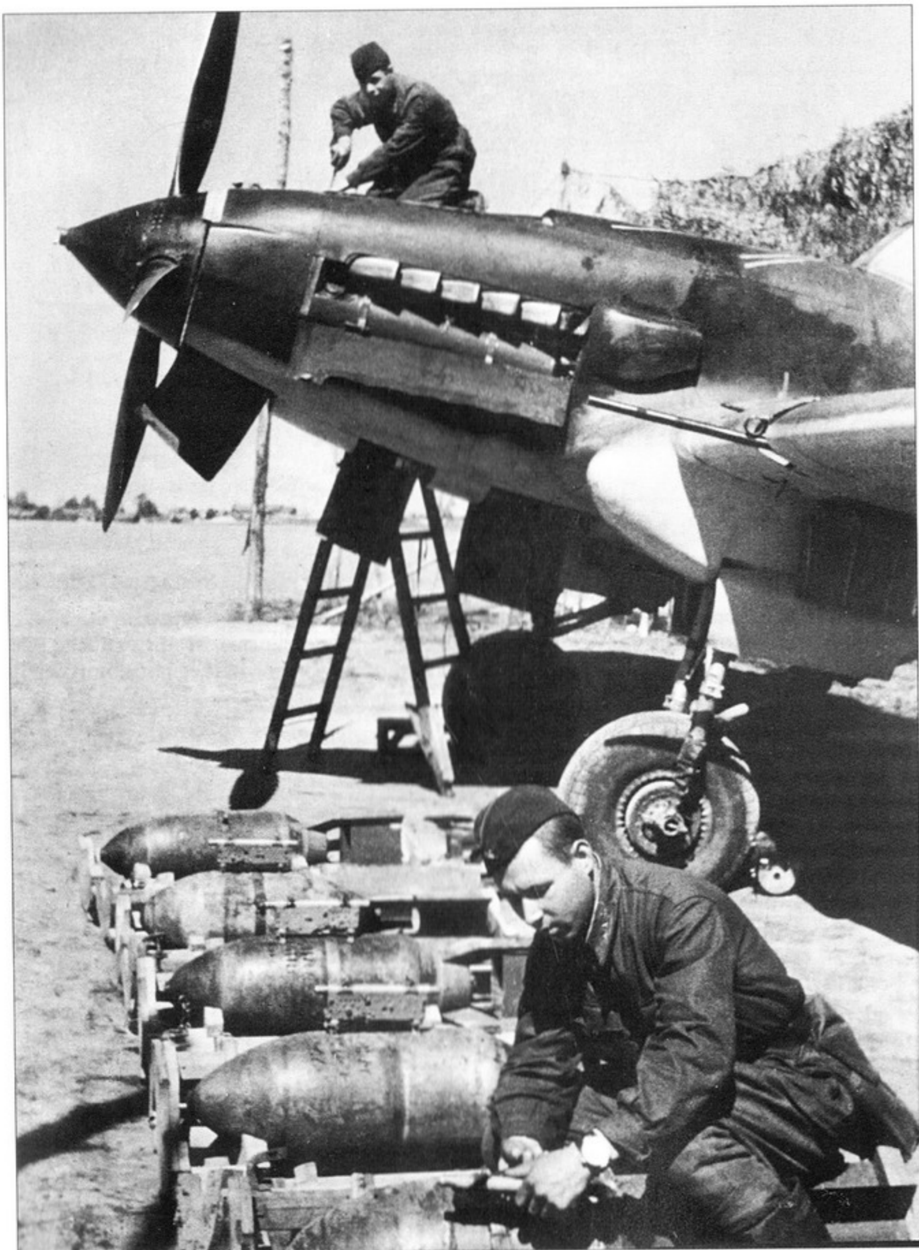
Установка замка ДЕР-21 на бомбу перед подвеской на штурмовик. На снимке хорошо видны откидные панели капота двигателя: три снизу и одна большая для подхода к маслобаку.
