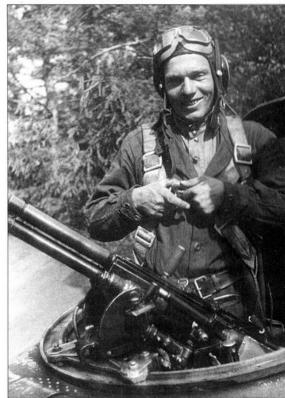
Полутурельная установка крупнокалиберного пулемета в кабине воздушного стрелка.
