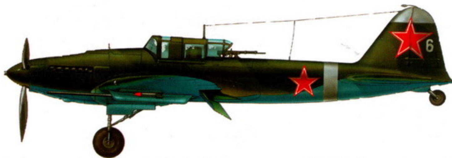
Двухместный штурмовик Ил-2 с 37-мм пушками МС-37. Курская дуга. 1943 г. Щитки отклонены на посадочный угол.
