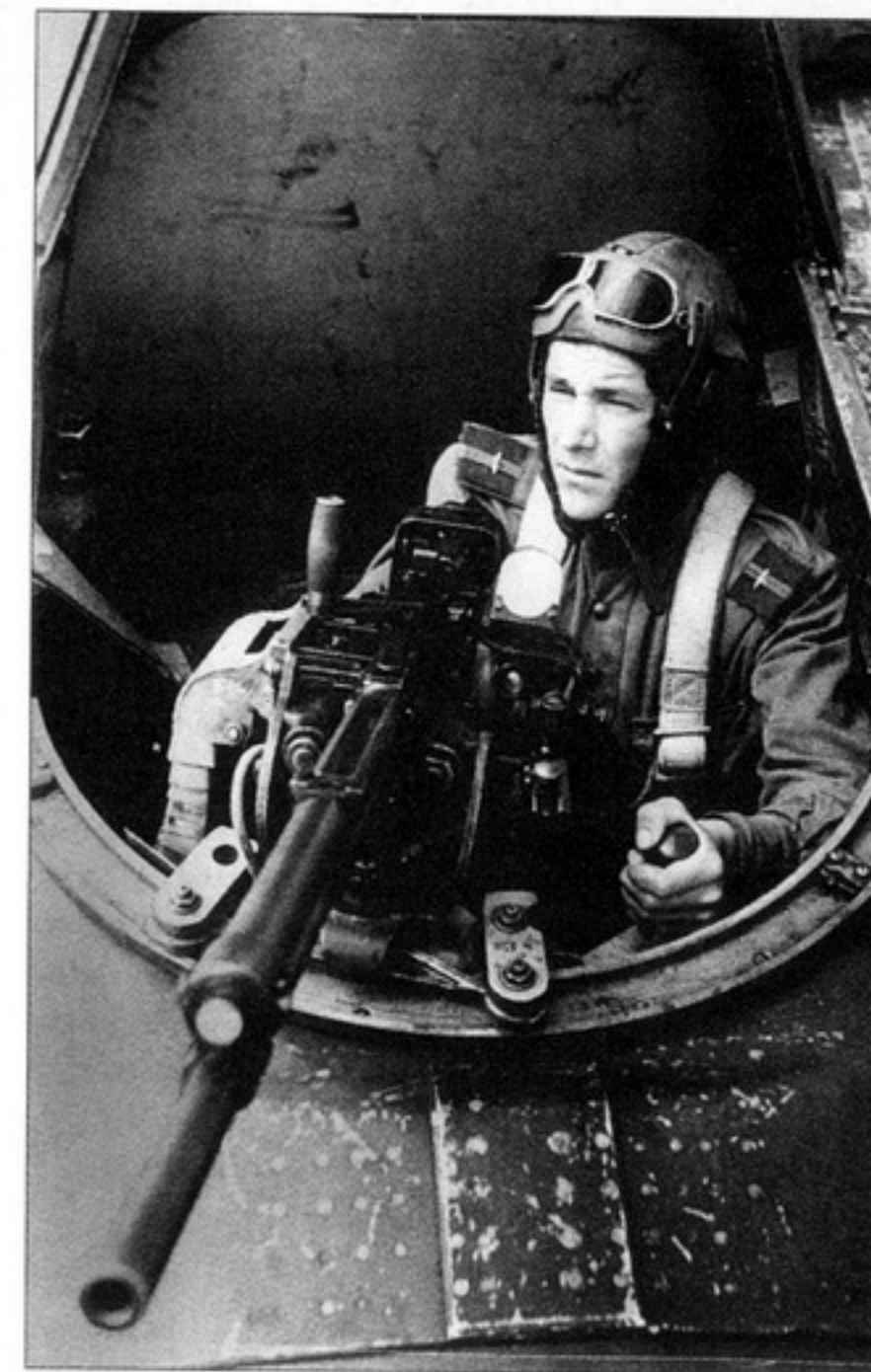
Воздушный стрелок старшина П.Шуляков в кабине за пулеметом УБТ. Справа видны петли снятой прозрачной крышки фонаря. На заднем плане хорошо просматривается бронеплита, закрывающая бензобак, а слева видна лямка и часть брезентового сидения стрелка.
