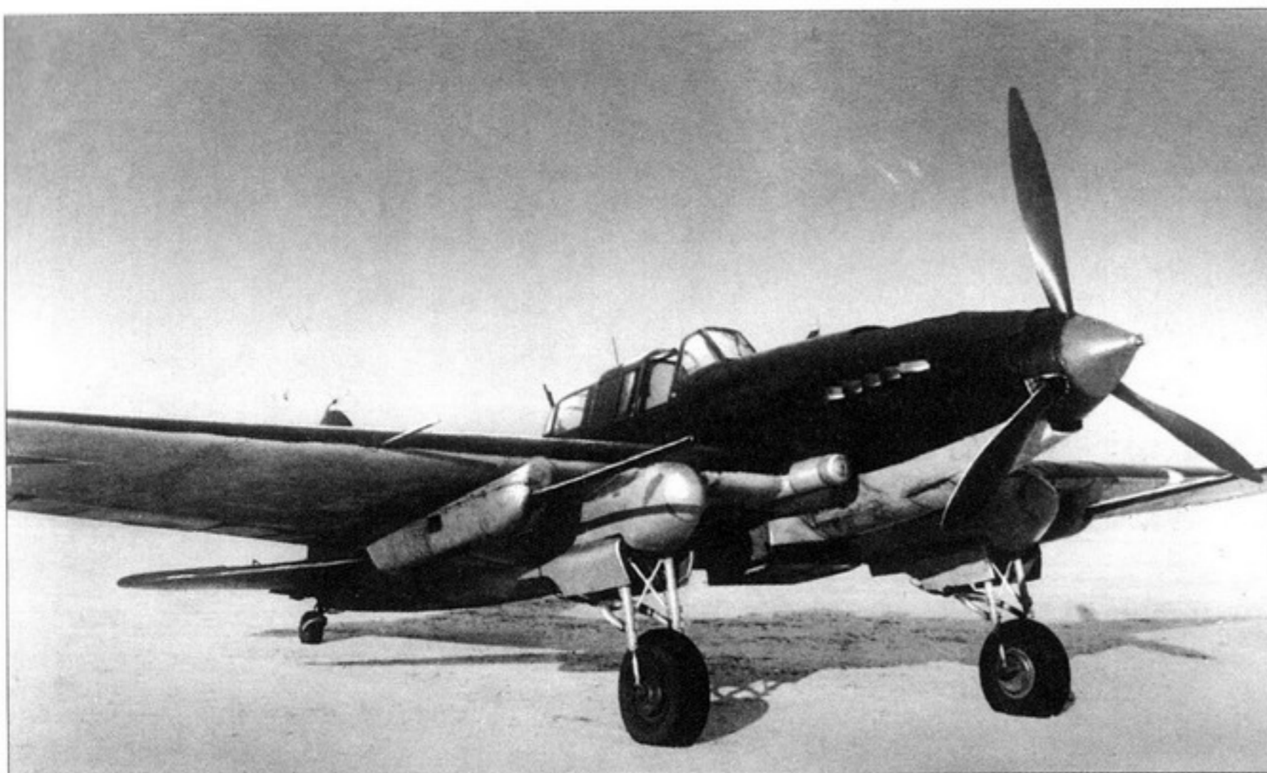
Опытный штурмовик Ил-2 с пушками НС-37. Москва, Центральный аэродром, март 1943 г.
