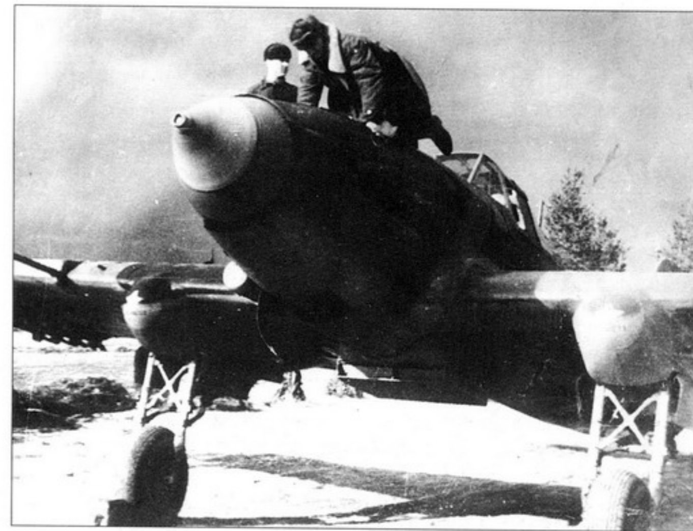
Вверху: Техники осматривают расширительный бочок Ил-2 во время пробы двигателя. (Вдовенко)
