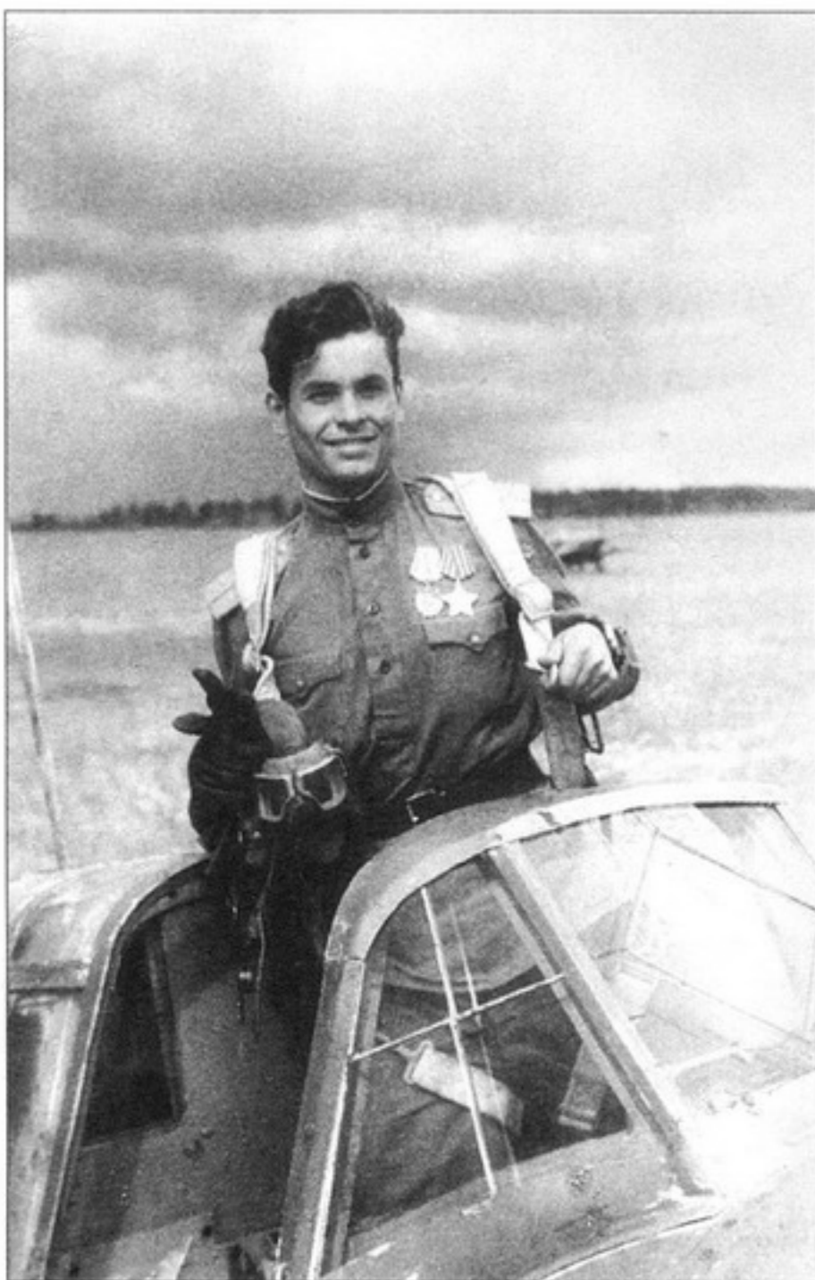
Л-т Г.Денисенко в кабине своего "Ила". В бронеспинке хорошо видно окно для обзора назад в полете.
