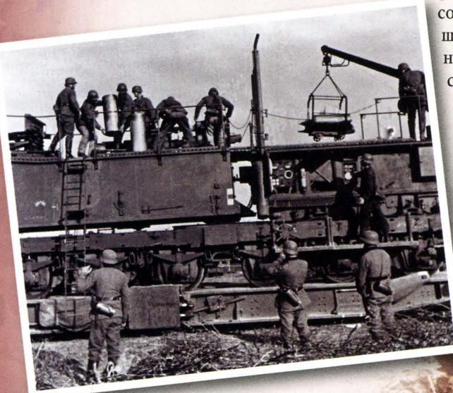
◀ Немецкие артиллеристы перезаряжают железнодорожное орудие «Дора», используя подъемный кран.
