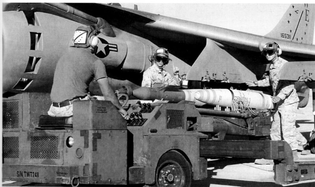
Специальные автопогрузчики облегчают и ускоряют подвеску боеприпасов
