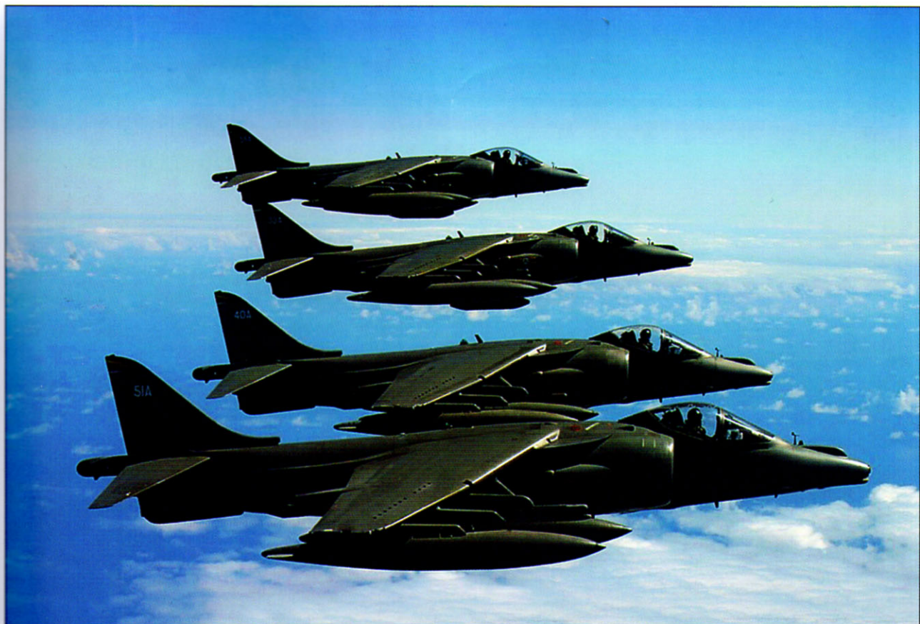
Самолеты «Харриер» GR.7 в дальнем полете. На машины подвешены дополнительные топливные баки
