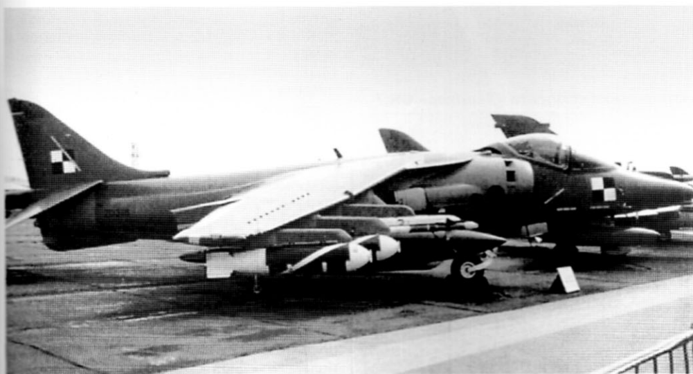
«Харриер» GR.7 с полной боевой нагрузкой: пять бомбовых кассет BL 755 (четыре на подкрыльевых узлах и одна на подфю- зеляжном), две УР «Сайдвиндер» и два дополнительных топливных бака
