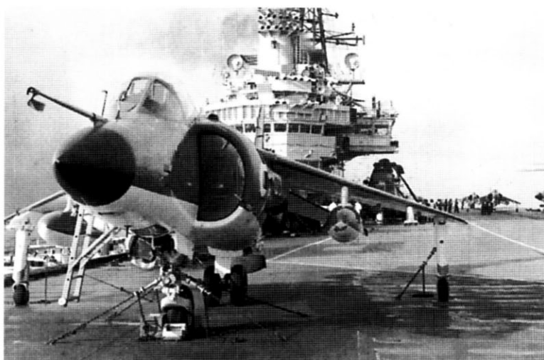
При нахождении авианосца в открытом море «Си Харриеры» на его палубе надежно расчаливались
