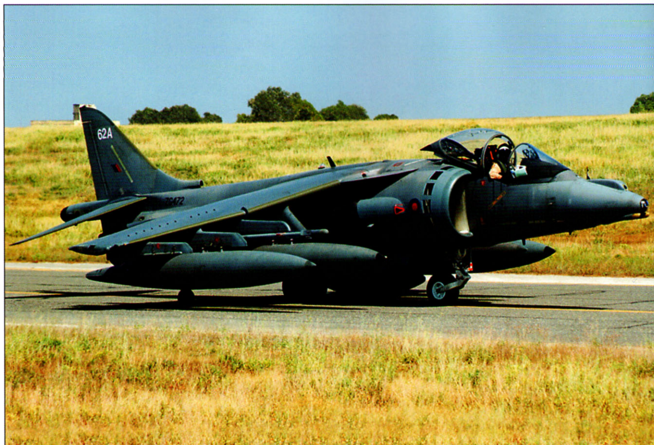
«Харриер» GR.7 в перегоночной конфигурации (с четырьмя подвесными топливными баками)
