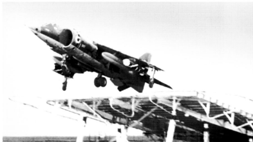
Отработка взлета с трамплина на наземном испытатель- ном комплексе
