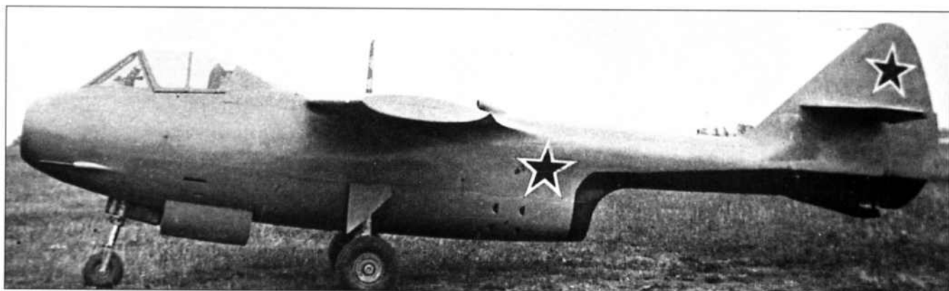
Доработанный Ла-150 с отогнутыми законцовками крыла и ТРД с форсажной камерой
