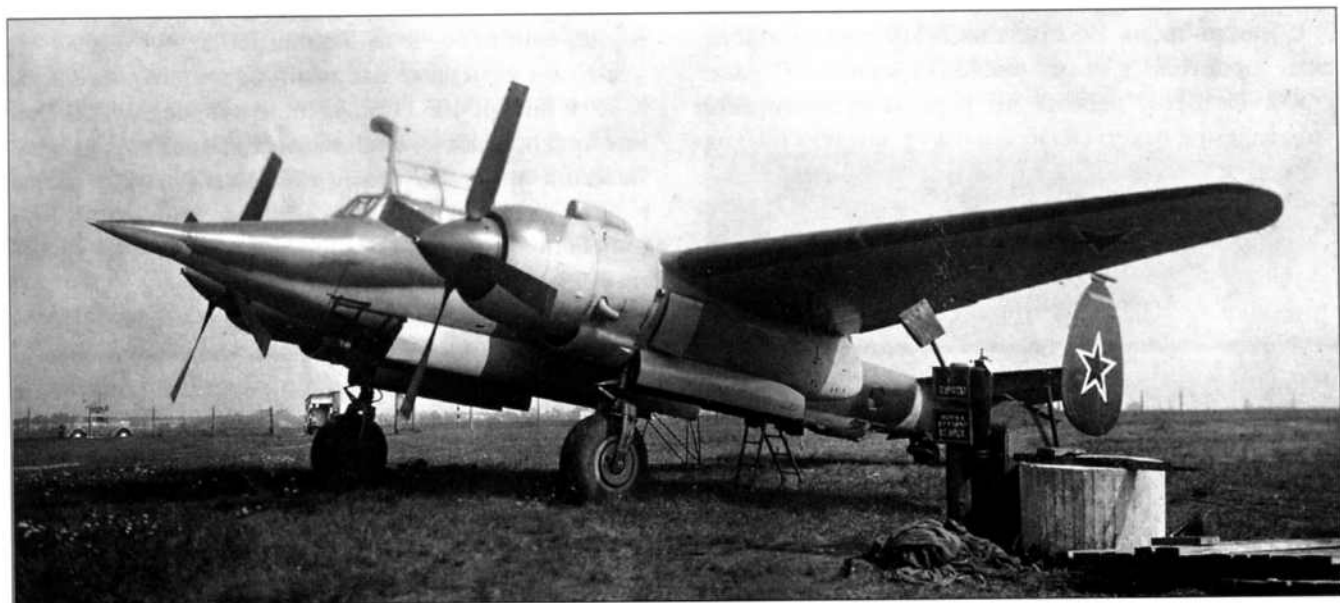
Летающая лаборатория Ту-2 для отработки системы наведения ракеты Г-300
