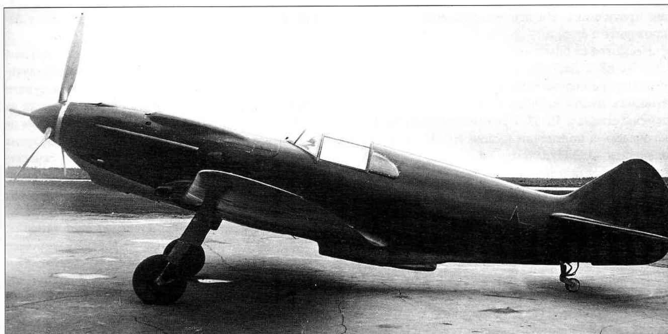
Первый самолет К-37, переделанный из третьего серийного ЛаГТ-3 завода № 23
