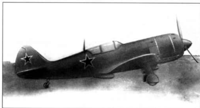
Самолет «126» — модификация Ла-7 с деревянным крылом ламинарного профиля
