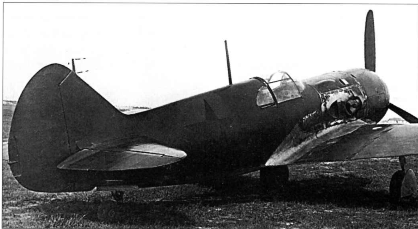
Опытный Ла-5 с двумя турбокомпрессорами ТК-3, 1943 год
