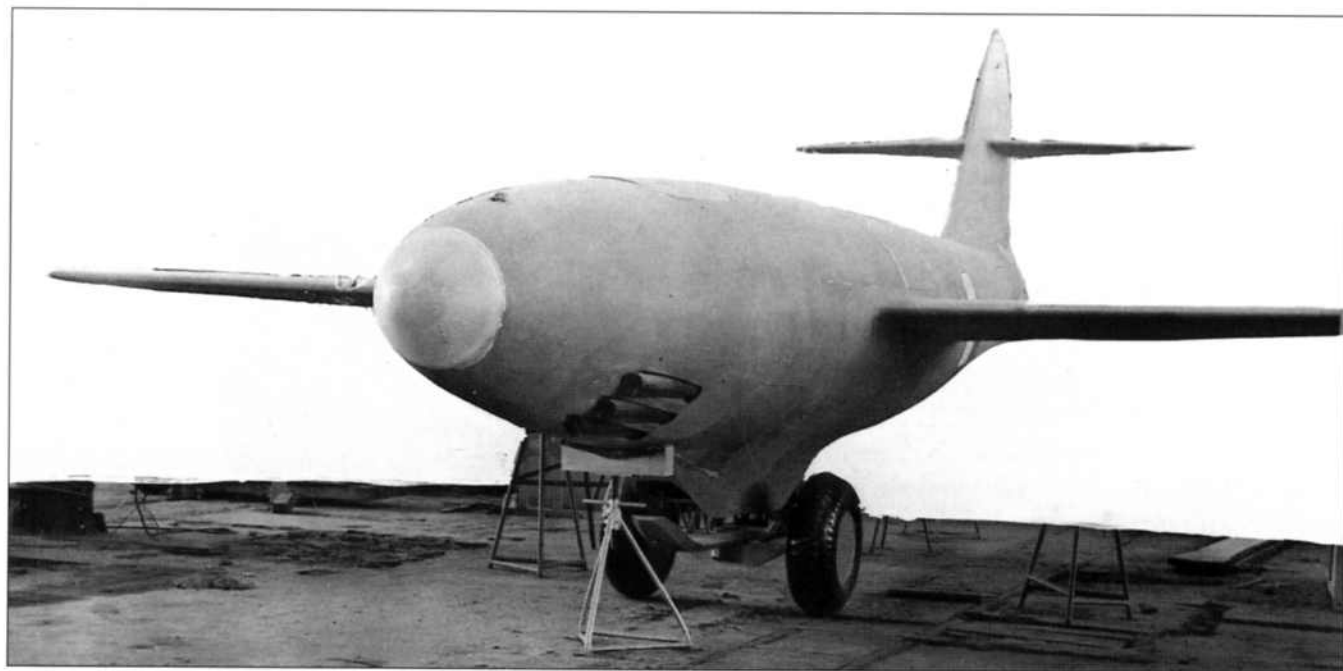
Макет самолета «162» без фонаря кабины летчика
