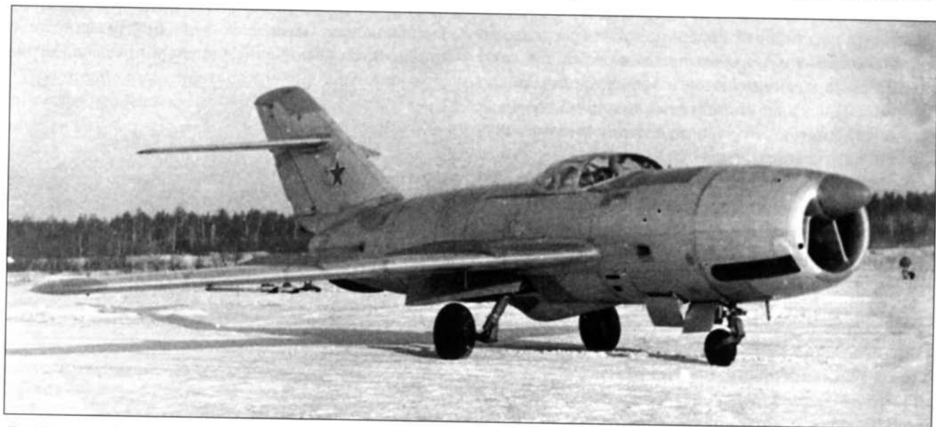
Ла-200 с модифицированной носовой частью под РЛС «Коршун»
