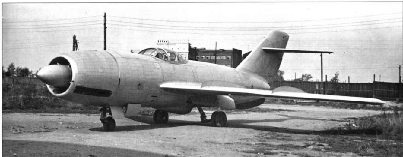
Первый опытный экземпляр самолета «200» с РЛС «Торий» и двоянными колесами основных опор шасси
