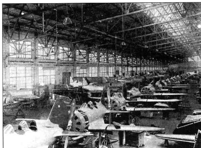
Линия сборки самолетов И-16 на 21-м заводе
