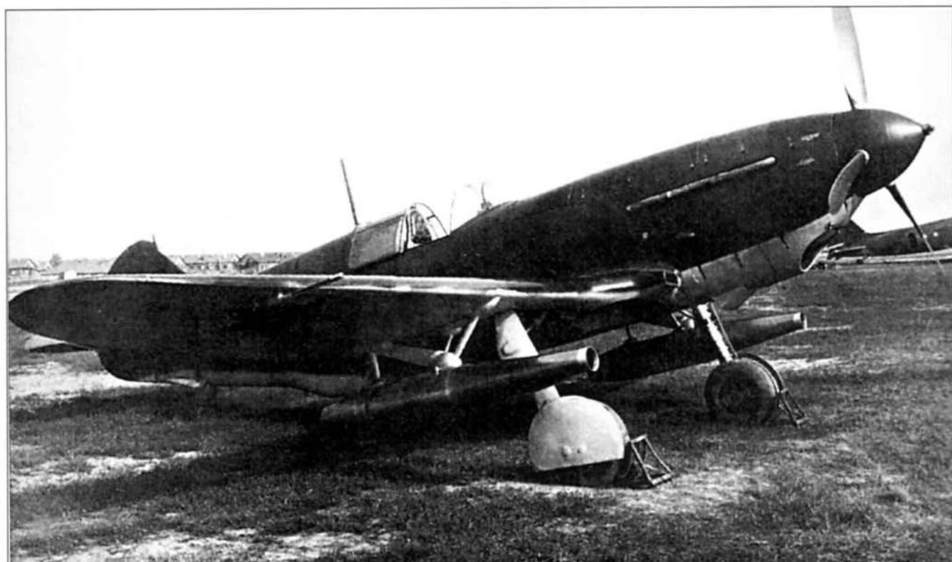
ЛаГГ-3 с прямоточными двигателями М.М.Бондарюка
