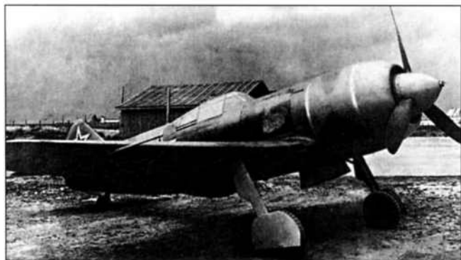
Ла-7 с двумя турбокомпрессорами ТК-3, 1944 год
