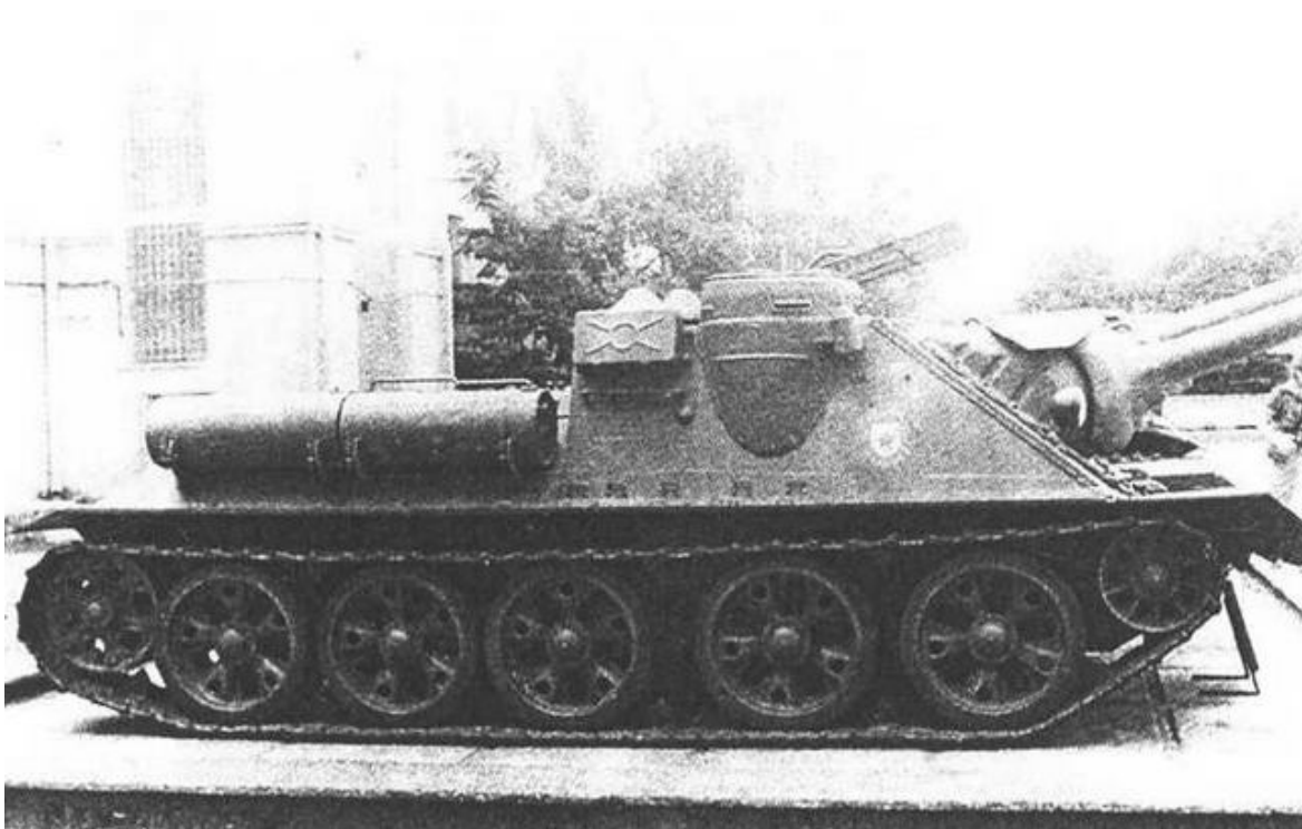
СУ-100, прошедшая модернизацию в послевоенные годы. Хорошо видны штампованные опорные катки от танка Т-44М.
