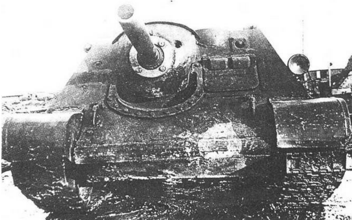
Опытная САУ СУ-122-III со 122-мм гаубицей Д-6 перед испытаниями. Июль 1943 года.
