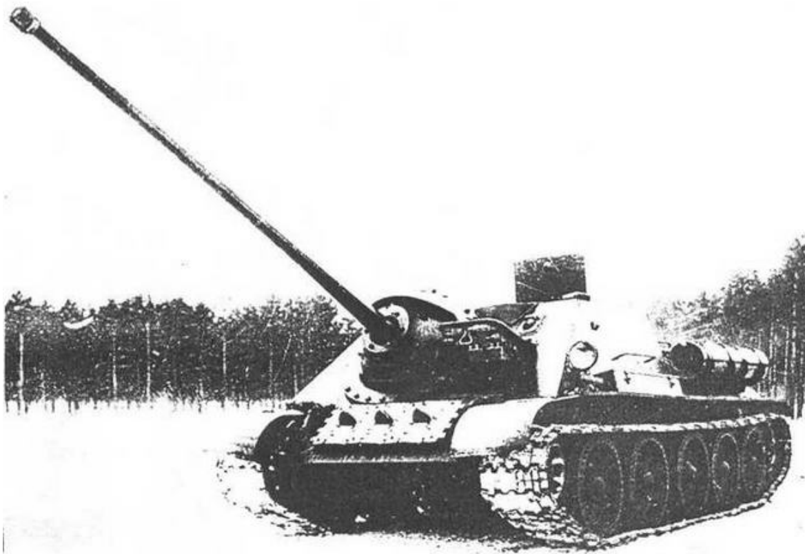
САУ СУ-85 КМ с пушкой большой мощности на испытаниях. Январь 1943 года.
