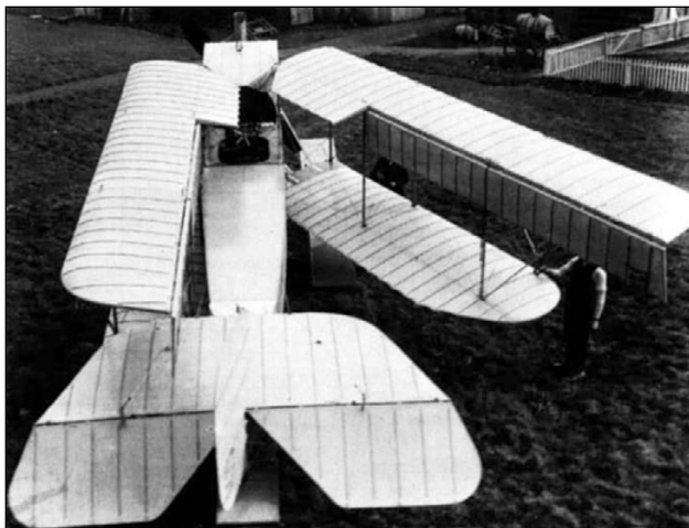
Гидросамолет Шорт тип 81 «Складной» (Folder). Первая разработка самолета для базирования на авиатранспортах
