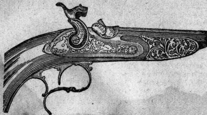
Рис. 13. Ударно-капсюльный замок пистолета XIX в.
