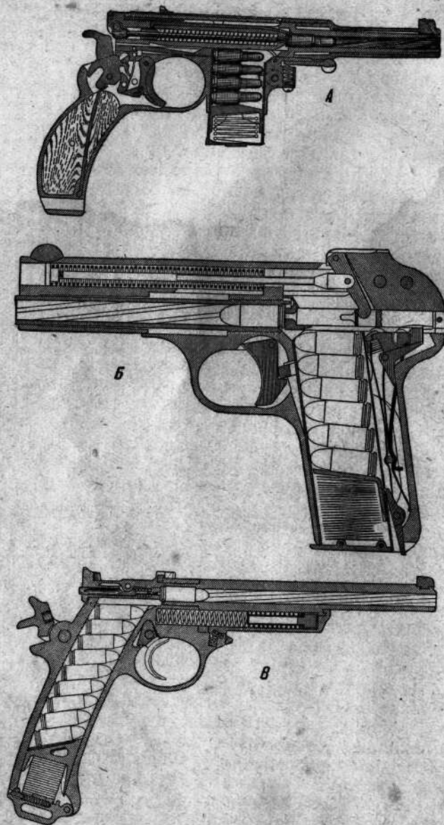
Рис. 16. Схематический разрез самозарядных пистолетов разных систем:
