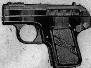
Р и с. 25. Пистолет военного образца сист. Байарда 1908 г. (Дания), кал. 9 мм.
