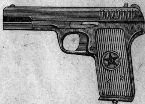
Рис. 33. Пистолет военного образца сист. Токарева („ТТ“) 1933 г. (СССР), кал. 7,62 мм.
