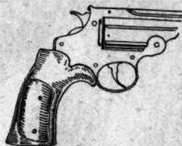
Рис. 91. Крючок на спусковой скобе для задержки среднего пальца правой руки.
