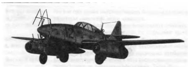
Ночной истребитель-перехватчик Me-262B-1a/U1 с радиолокатором в носовой части фюзеляжа
