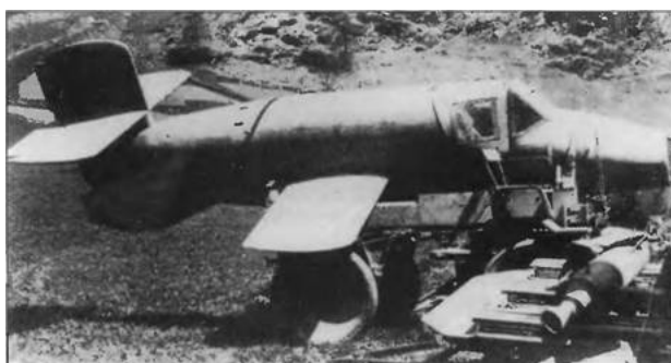
Один из экземпляров самолета «Наттер», захваченный американскими войсками в апреле 1945 года на заводе в Вальдзее. Самолет находится на транспортной тележке, в правом нижнем углу снимка виден стартовый пороховой двигатель «Шмиддинг».
