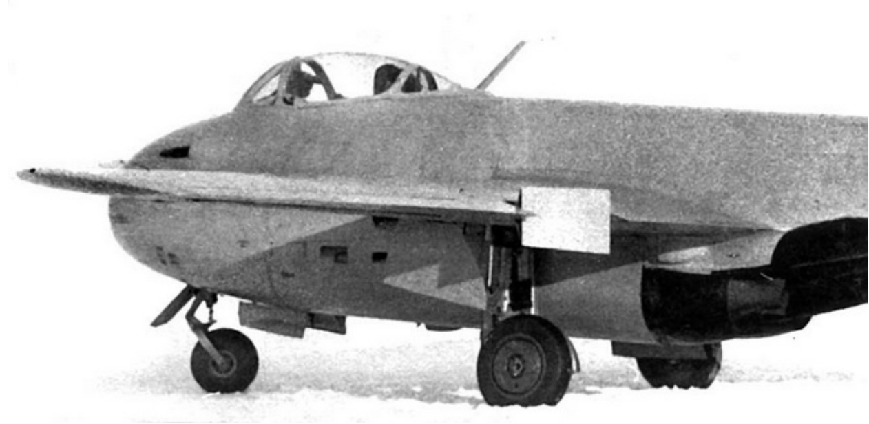
Тормозной щиток на крыле самолета.
