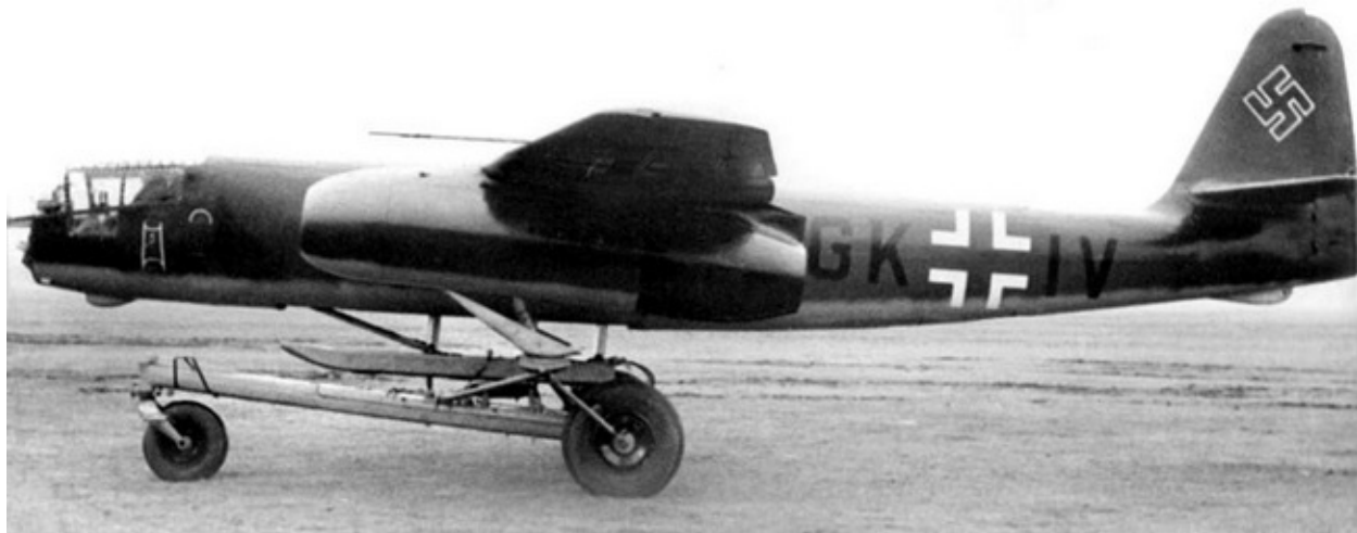
Один из самолетов опытной серии «Арадо-234V» с двумя ТРД и взлетной тележкой.
