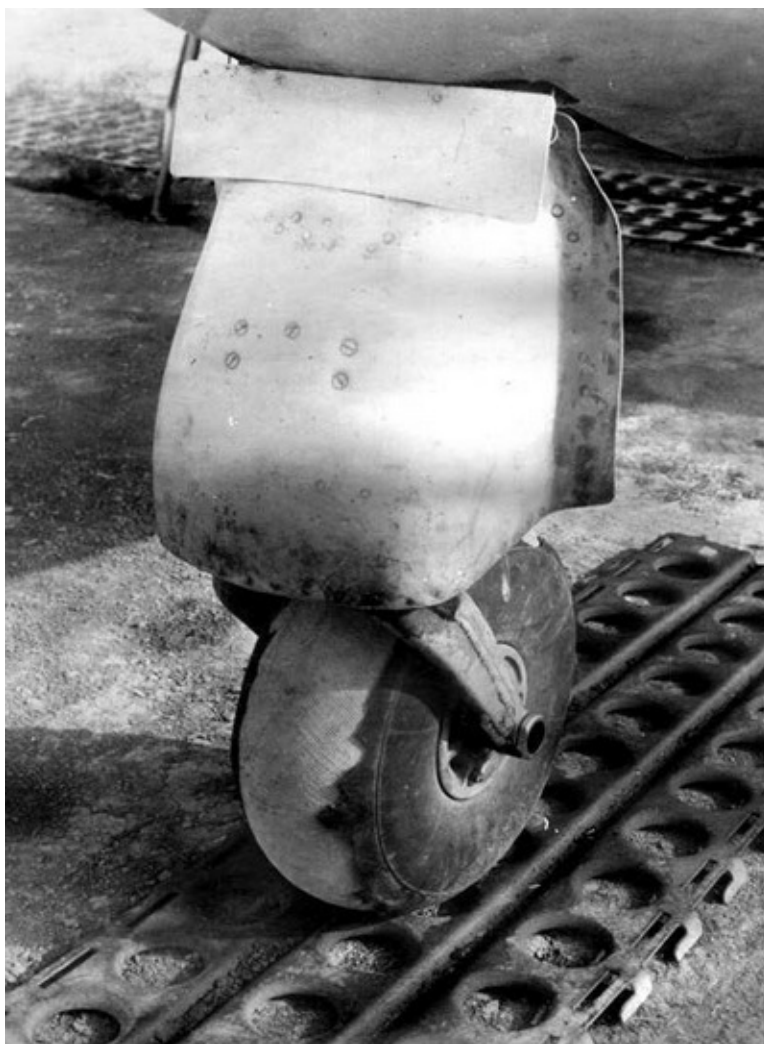
Срыв протектора колеса носовой опоры шасси на самолете № 3120002.
