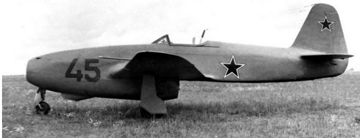
Первый опытный экземпляр истребителя Як-15У с носовой опорой шасси, предшественник Як-17.
