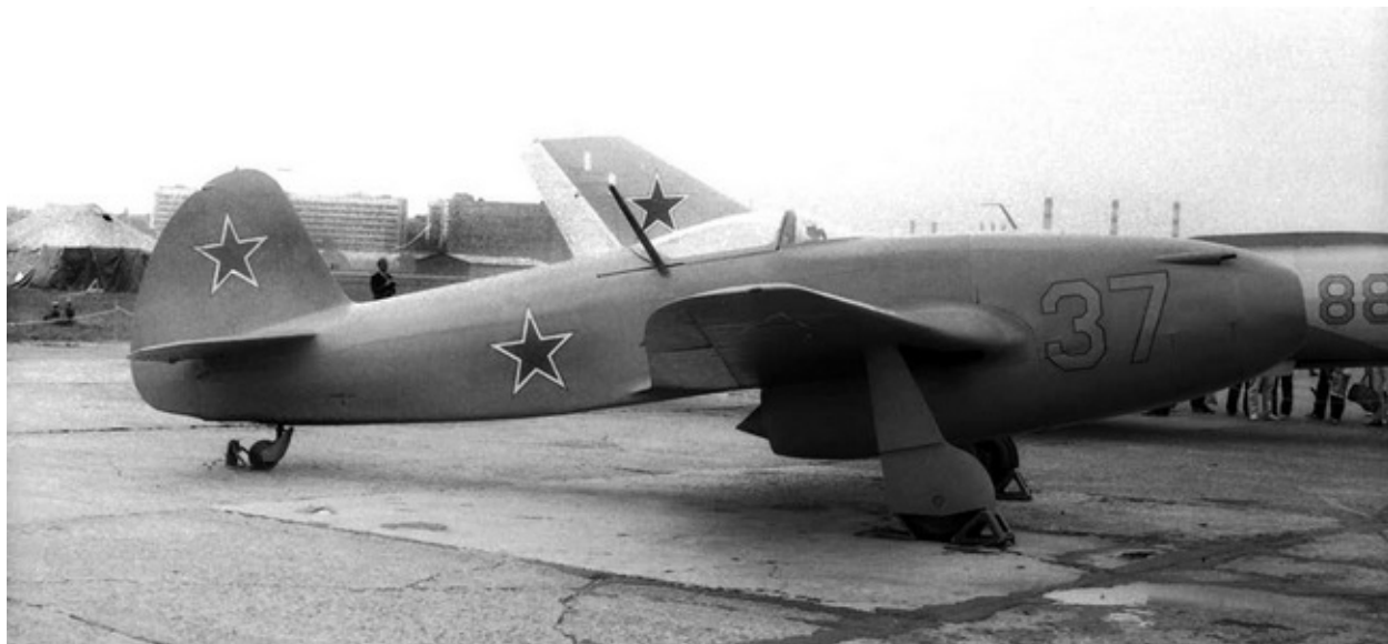
Единственный дошедший до наших дней истребитель Як-15 с бортовым номером 37. Видимо, это машина первой опытной серии, доработанная под установку вооружения.
