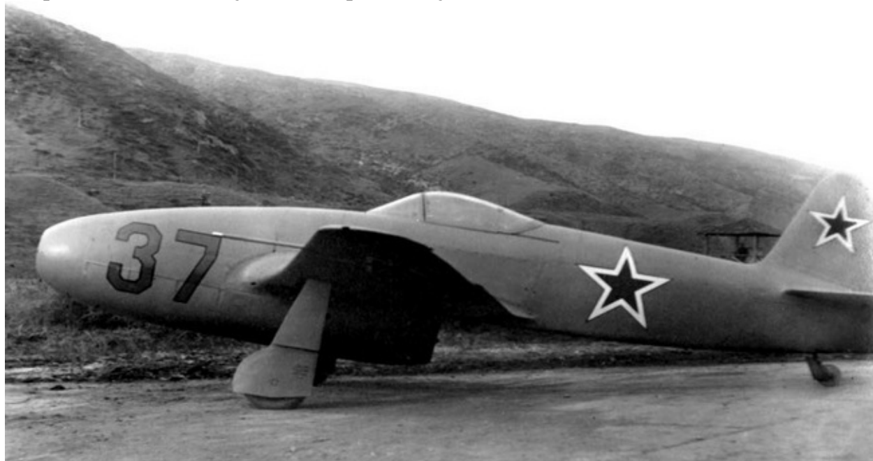
Як-15 опытной серии без вооружения и радиооборудования.
