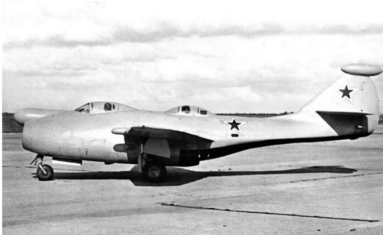
Летающая лаборатория СДК-9А, предназначенная для испытаний системы наведения
