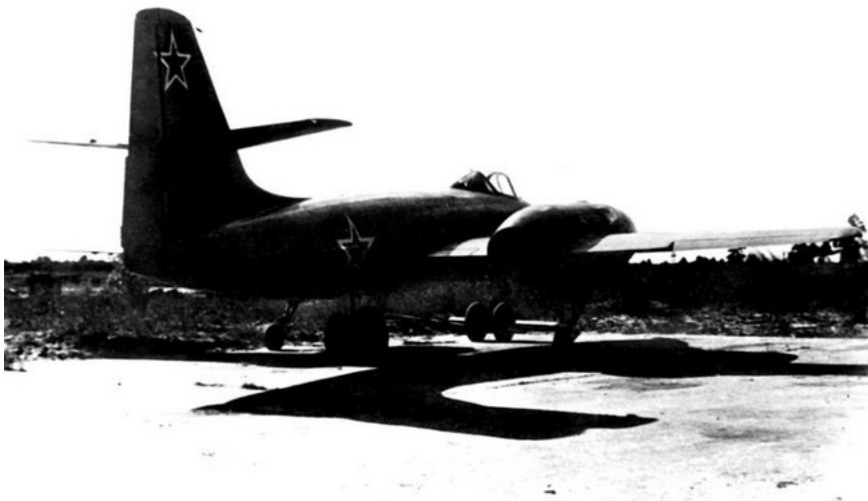
Летающая лаборатория на базе И-215 с велосипедным шасси.
