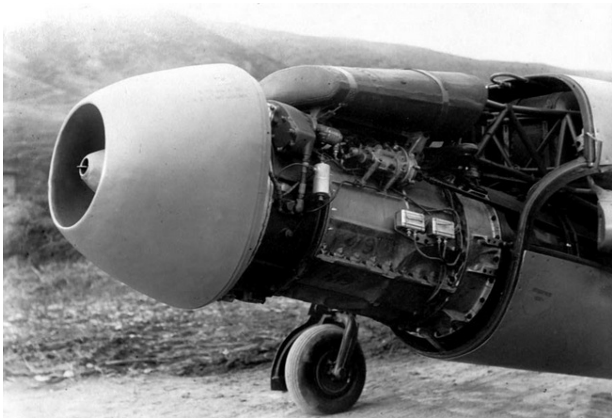
Носовая часть Як-15 без вооружения со снятыми капотами.
