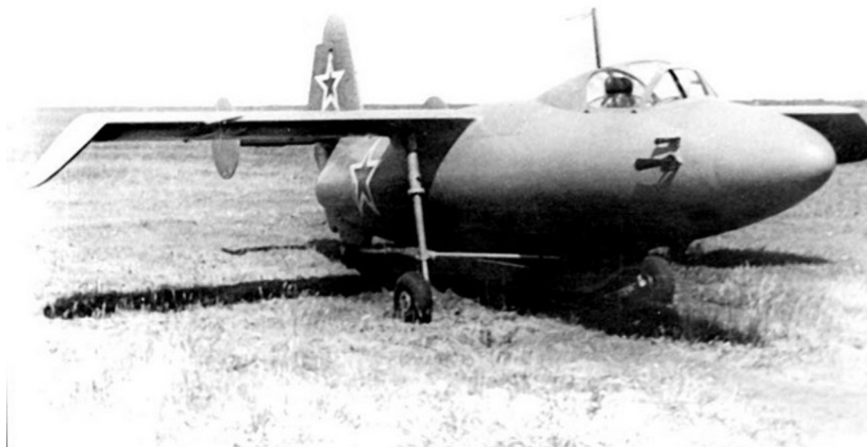
Планер самолета «4302» с колесами от истребителя Ла-5.
