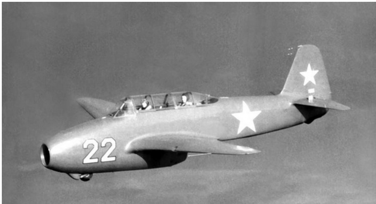
Первый опытный экземпляр учебно-тренировочного самолета Як-21Т с носовой опорой шасси, предшественник УТИ Як-17.
