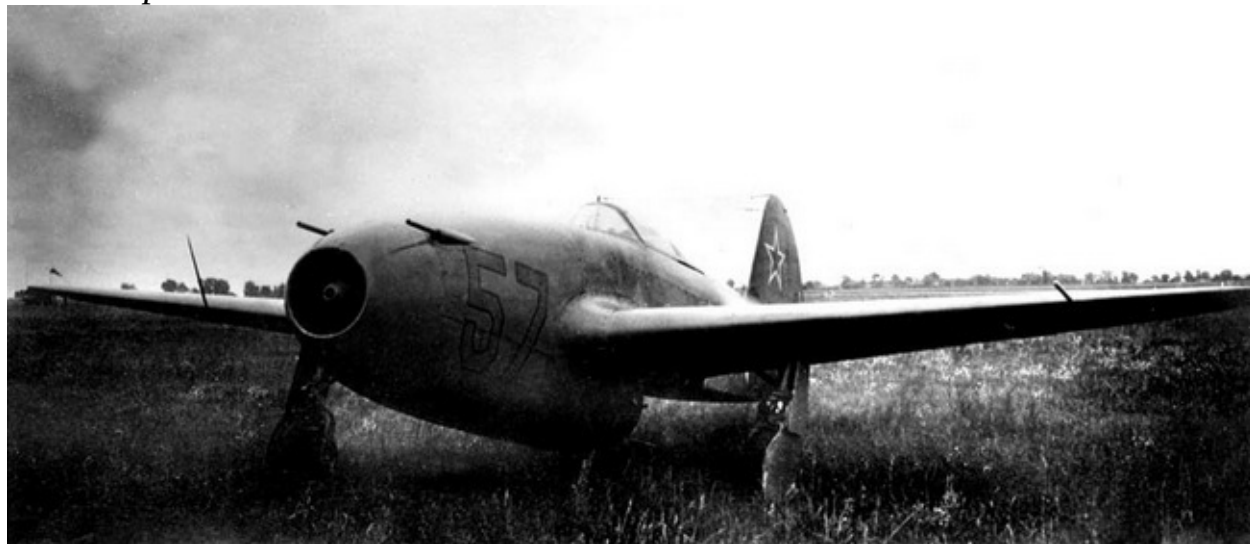
Общий вид истребителя Як-15 с вооружением из двух пушек НС-23.
