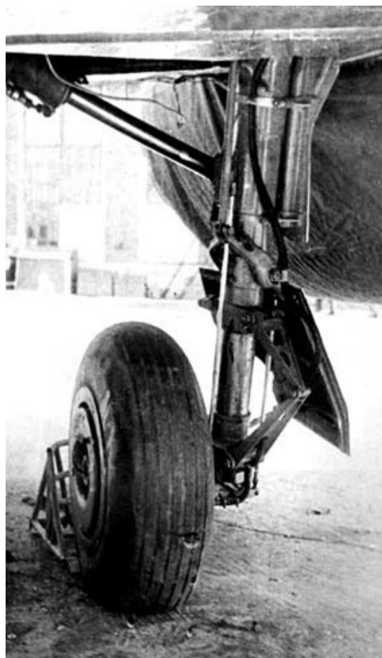
Основная опора шасси Су-9.
