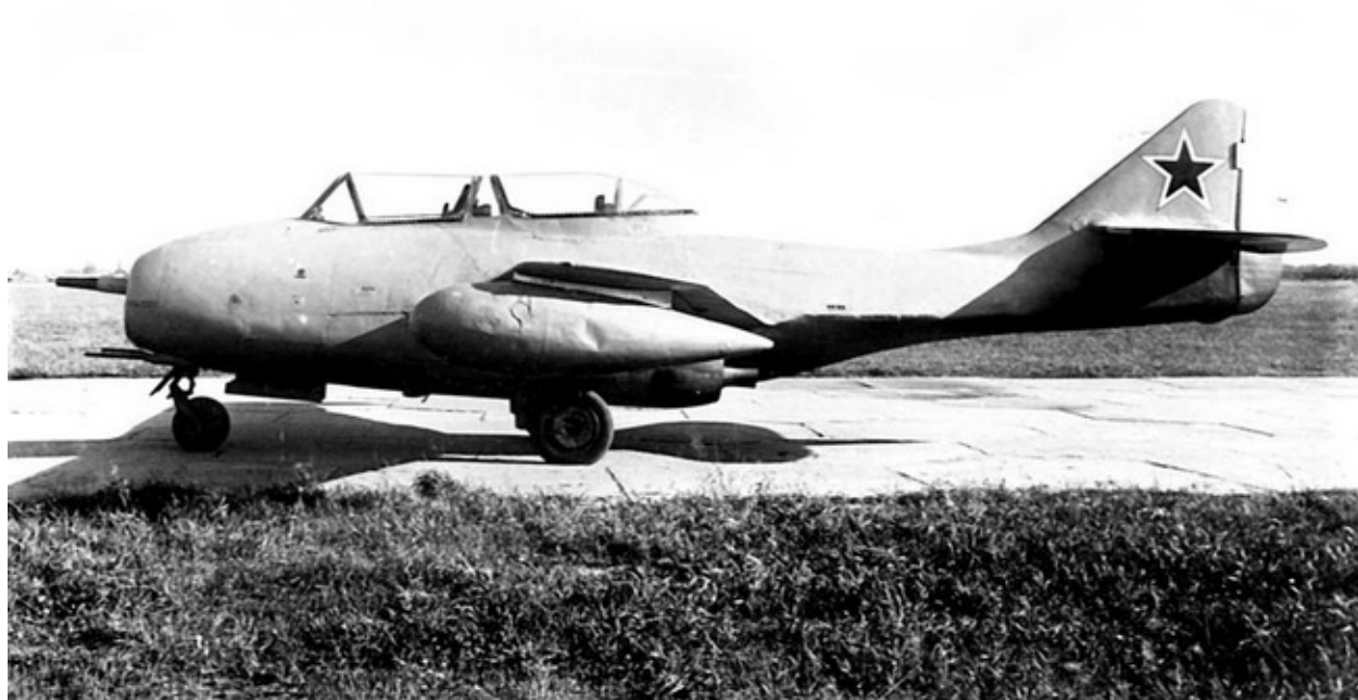
ФТ-2 с подвесными топливными баками на аэродроме НИИ ВВС.
