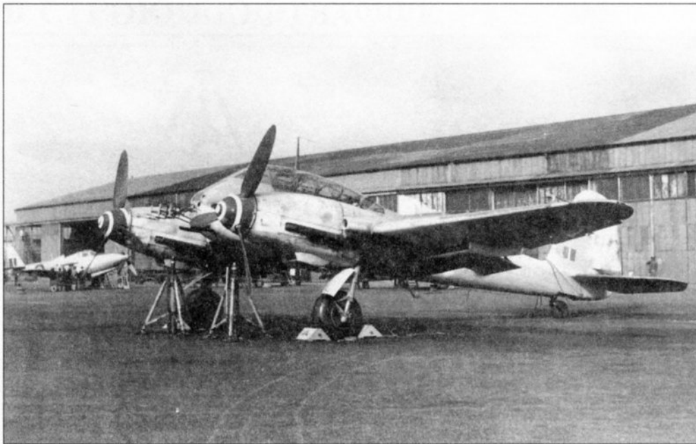
Морской разведчик Me 410B-6 с РЛС FuG 200 и усилен- ным вооружением (две 20-мм и две 30-мм пушки)
