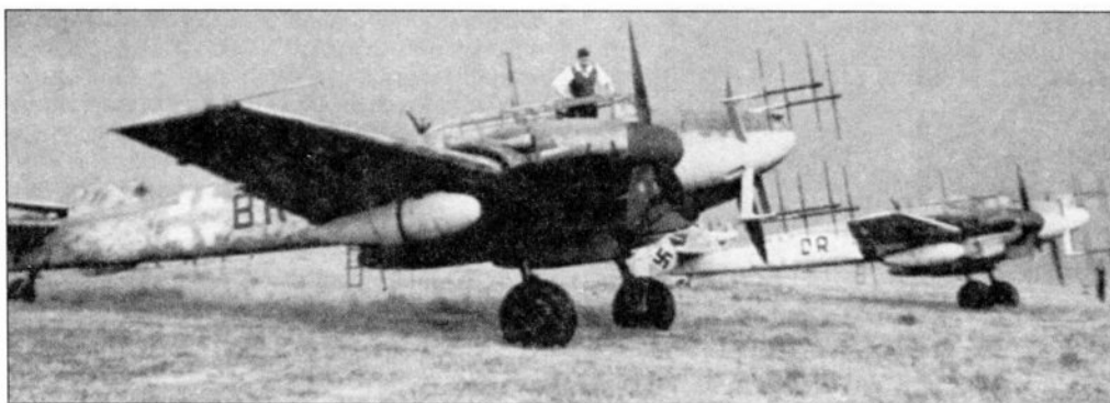
Оборудованные радаром ночные истребители Bf 110G-4/R3/B2. 1944 г.
