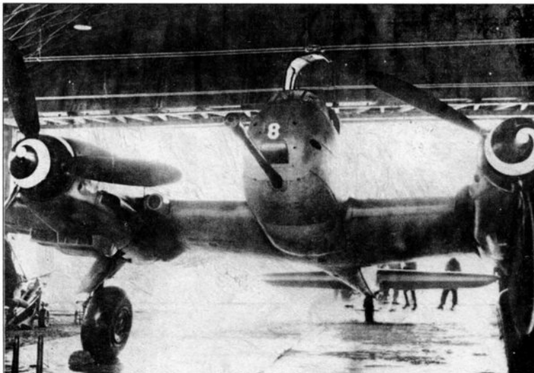
Me 410A, вооруженный 50-мм пушкой ВК 5
