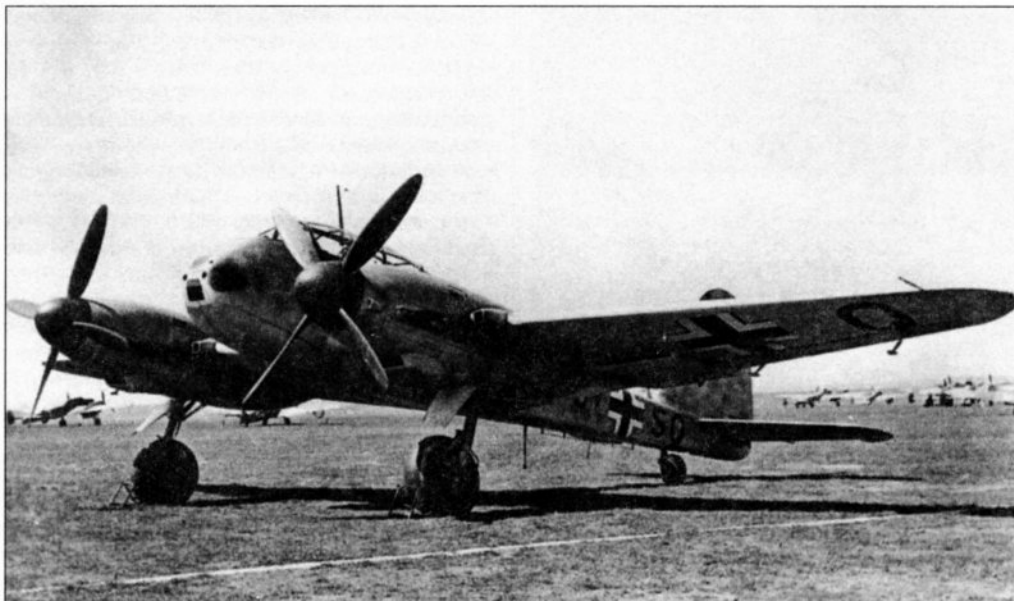
Предсерийный самолет Me 210V13, использовавшийся для испытаний противообледенительной системы и автоматических жалюзи радиаторов. Рехлин, 1941 г.
