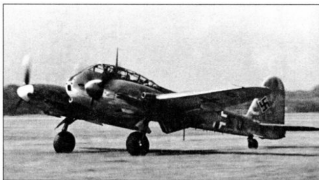
Me 210A имел характерный «головастый» силуэт благодаря сдвинутой вперед кабине экипажа
