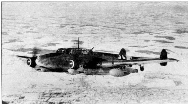
Bf 110G-2/R7/R8/M5 в полете. Самолет несет подкрыльевые ПТБ и пусковые установки для 210-мм ракет WGr.21
