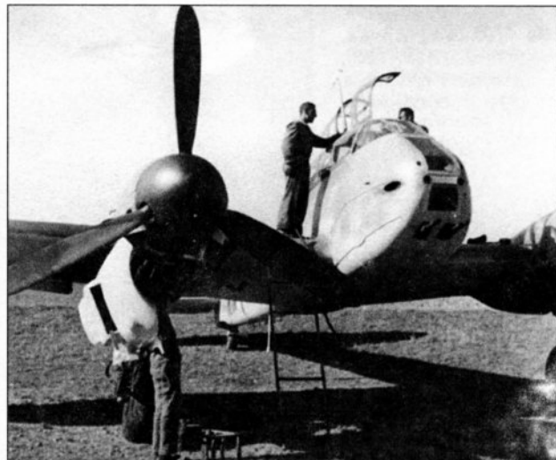
Me 410 с подфюзеляжным контейнером WB 151 с двумя дополнительными 20-мм пушками MG 151/20
