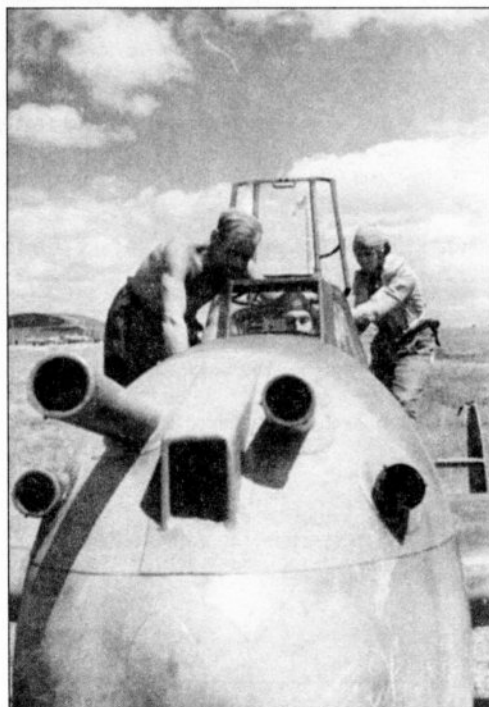
Носовая часть Bf 110G-2 из группы III/ZG 26. Видны стволы пулеметов MG 17
