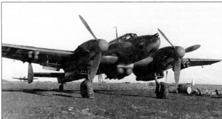
Vf 110F-2 из 8./ZG 26. Под фюзеляжем — 2 250-кг АБ SDe 250, под крылом — 4 кассеты AD 23 (в каждой — 23 2-кг осколочные бомбы). Африка, июнь 1942 г.
