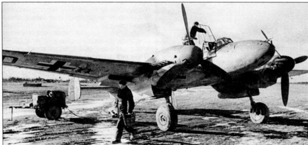
Bf 110G на полевом аэродроме. Самолет оборудован подкрыльевыми бомбодержателями ETC 50
