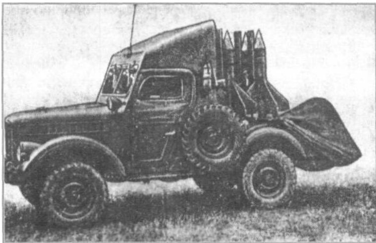
Боевая машина 2П26 комплекса «Шмель» в походном положении (тент опущен)
