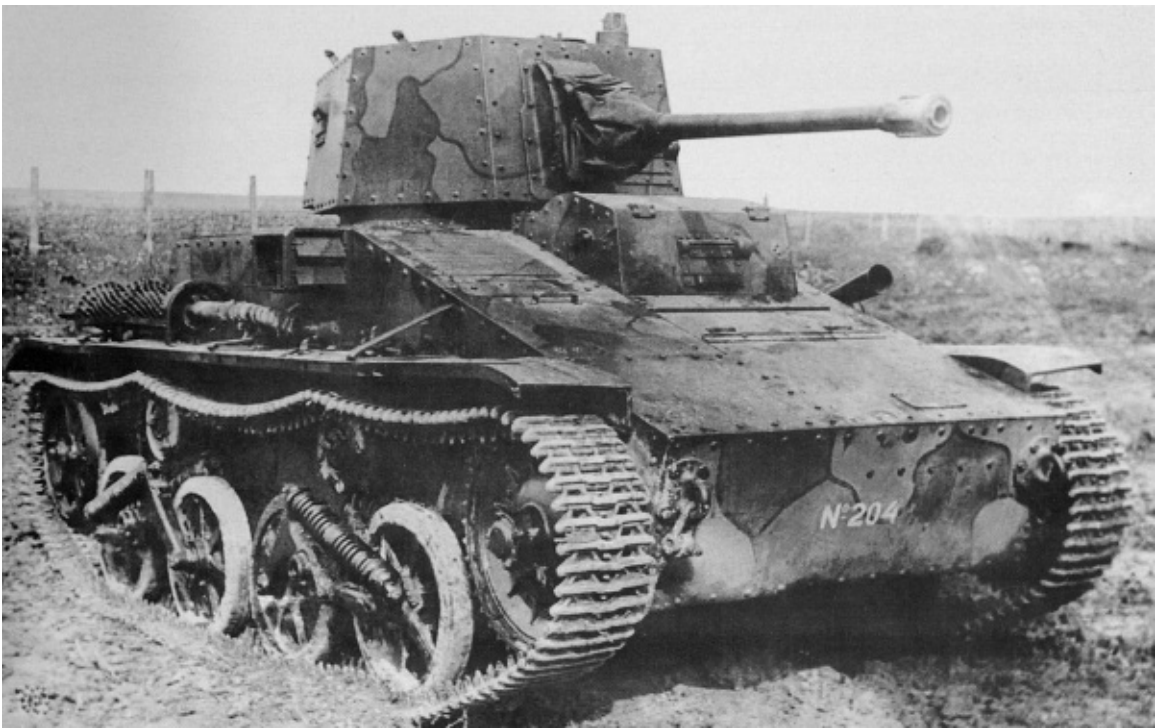
Легкий танк Vickers-Garden-Lloyd с 40-мм пушкой, состоявший на вооружении Латвийской армии
