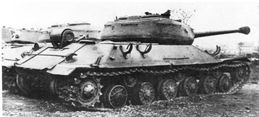
Опытный тяжелый танк ИС-6 (объект 253). На корме корпуса хорошо виден дополнительный электровентилятор для обдува агрегатов трансмиссии
