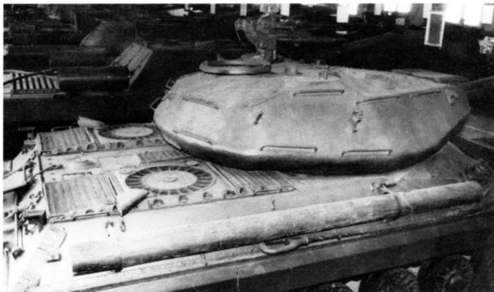
Вид сверху на башню и корму корпуса танка ИС-4. Хорошо видны выхлопные патрубки и надвентиляторные плиты
