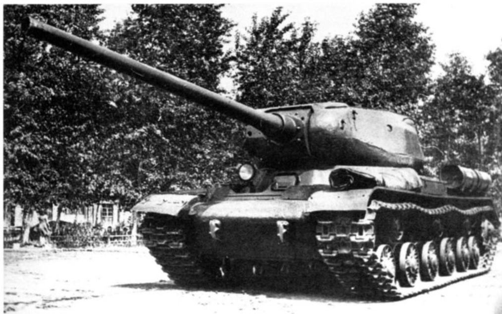
Танк ИС-5 (объект 248), вооруженный 100-мм пушкой С-34. Челябинск, июнь 1944 года (слева и внизу)
