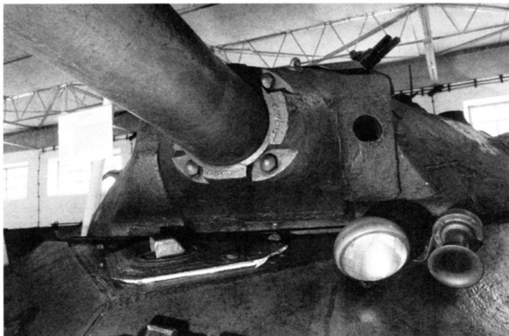
Вид на маскировочную установку танка ИС-3, находящегося в музее военной академии в Познани. На этой машине сохранились даже такие детали как «родная» фара и сигнал
