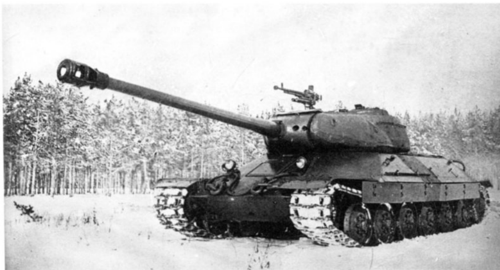
Танк ИС-6 (объект 252) с механической трансмиссией во время испытаний
