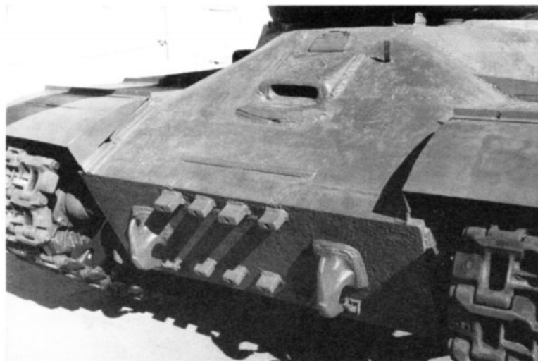
«Спрямленный» сварной нос танка ИС-2
