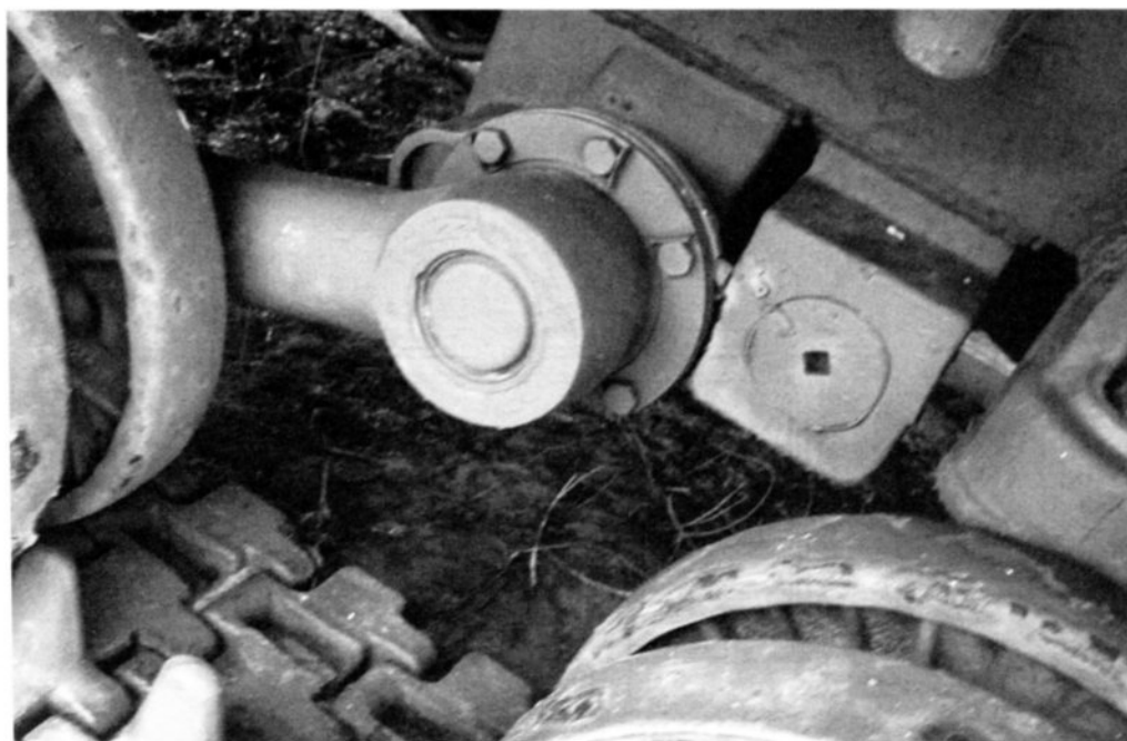
Балансир опорного катка и броневая коробка котелка обогревателя
