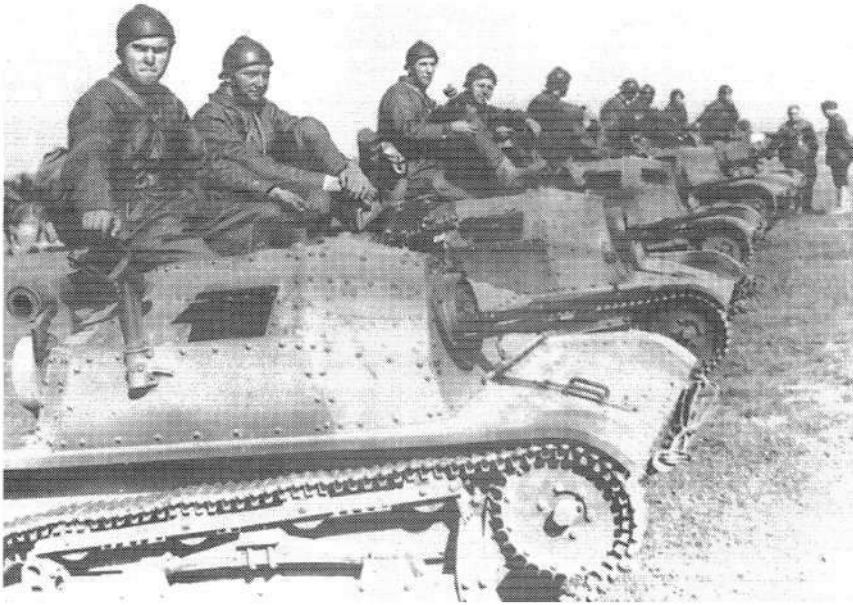
Рота танкеток TKS в ожидании приказа, район Варшавы, 13 сентября 1939 г. Танкисты носят обычные комбинезоны цвета хаки и защитные танковые шлемы французского образца. Танкетки TKS, наиболее многочисленные бронированные машины польской армии, были вооружены только одним пулеметом «Гочкис».
