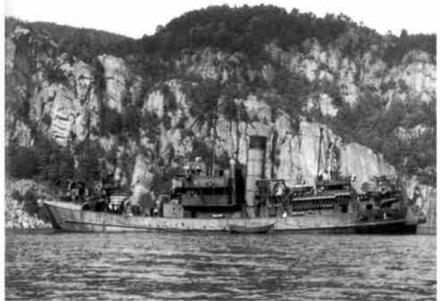
Большой охотник UJ-1709 (бывший траулер "Westpreussen") в Феде-фьорде. После гибели UJ-1708 в артиллерийском бою с советской ПЛ К-3 3 декабря 1941 г. немцы стали усиливать вооружение эскортных кораблей. К концу 1943 г. UJ-1709 нес 1 88-мм орудие, 1 37-мм зенитку и 4 20-мм автомата
