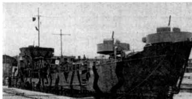
Sp-141 (б. "Lies") Водоизмещение: 465 брт Размерения: 51х8х2,9 м Скорость: 8,5 уз. Вооружение: 3х1 — 37-мм/83, 2х1 — 20-мм/65
