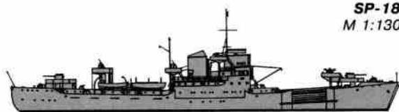
Sp-187 (б. "Almeria") Водоизмещение: 1821 брт Размерения: 94,42х13,3х5,5 м Энергетическая установка: 2 диз. MWM, 1620 л.с.; 280 т соляра Скорость: 11,5 уз. Вооружение: 2х1 — 105-мм/45, 2х2 — 37-мм/83, 1х4 и 3х1 — 20-мм/65
