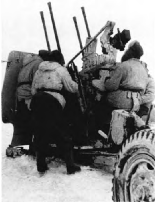
Немецкая 20-мм счетверенная зенитная установка готовится открыть огонь по частям Красной армии. Декабрь 1941 года. Каждое орудие обладало скорострельностью 600 выстрелов в минуту и дальностью поражения на расстоянии 1800 м
