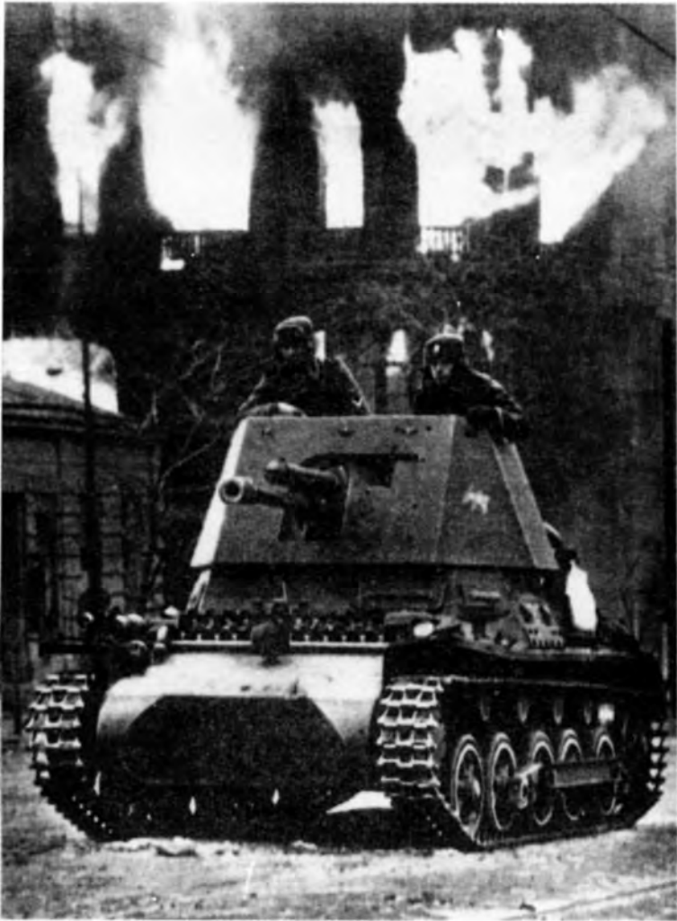
Немецкая самоходная артиллерийская установка — «истребитель танков» — продвигается по улице горящего Ростова. Вооруженная 47-мм пушкой, она впервые активно использовалась в Бельгии в 1940 году. Во время операции «Барбаросса» 1-я танковая группа имела в своем составе 670-й батальон «истребителей танков», который был оснащен этими машинами
