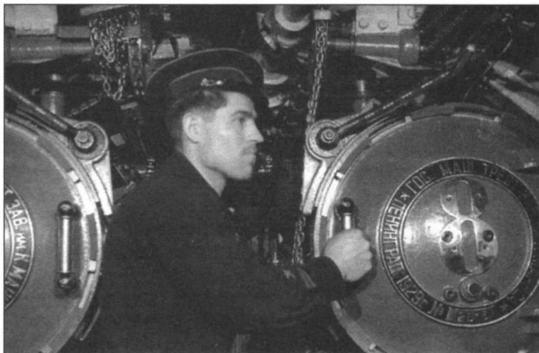
Кормовые торпедные аппараты подводной лодки типа «Д»
