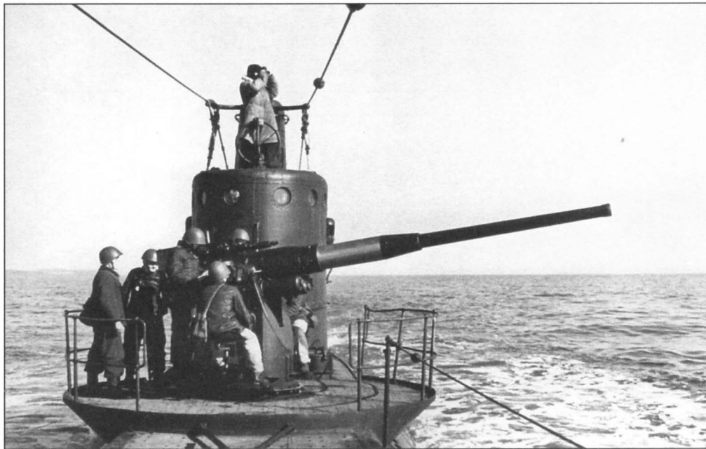
100-мм орудие Б-24ПЛ подводной лодки типа «Л» XIII серии ТОФ
