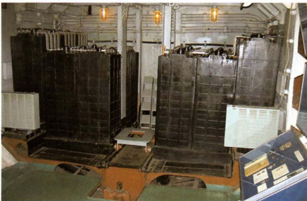
Аккумуляторная яма с аккумуляторами
