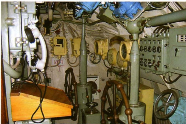
Пост управления горизонтальными и верт рулями в центральном посту
