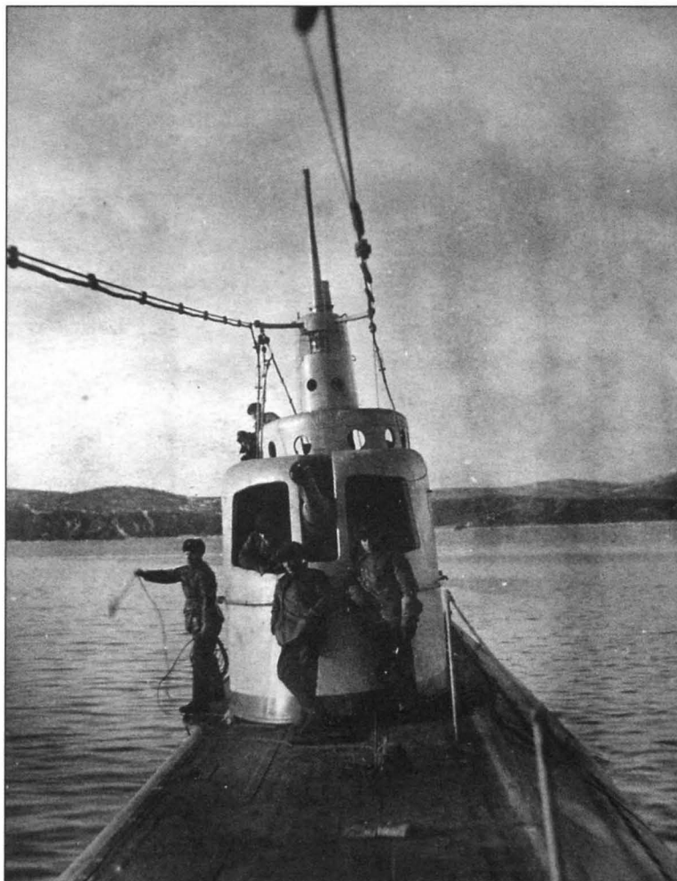
Первый из тихоокеанских «ленинцев» вскоре после вступления в строй, 1936 г. Обратите внимание на первоначальный дизайн рубки, обтекаемый щит 100-мм орудия и отсутствие 45-мм пушки
