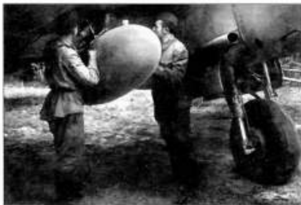
Под центроплан «пешки» подвешивают внешний топливный бак. По инструкции разрешалось использование такого бака не более чем в двух полетах: фактически он был картонным и не выдерживал длительного контакта с бензином
