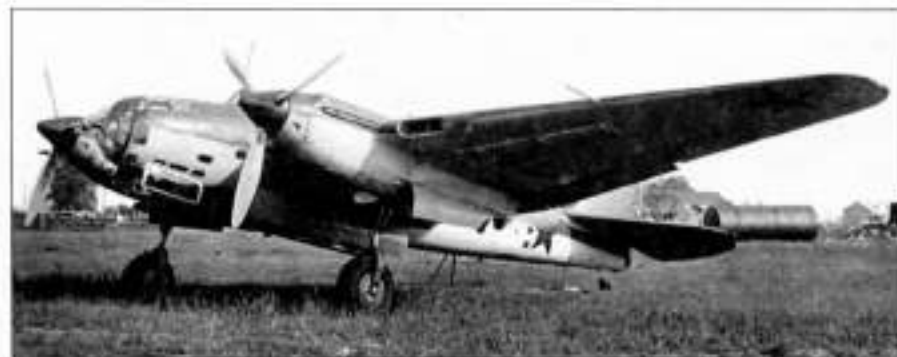
Пикирующий бомбардировщик Ар-2 с моторами М-105 был создан на основе СБ-РК. Площадь крыла была уменьшена, под консолями появились тормозные решетки, иными стали носовая часть фюзеляжа и хвост
