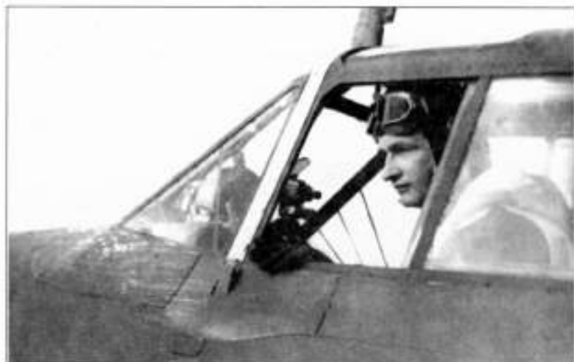
Командир 12-го гв. бап майор Василий Раков в кабине Пе-2. На боковых стеклах козырька фонаря кабины видны нарисованные линии, с помощью которых пилот выдерживал заданный угол пикирования, совмещая их с линией горизонта
