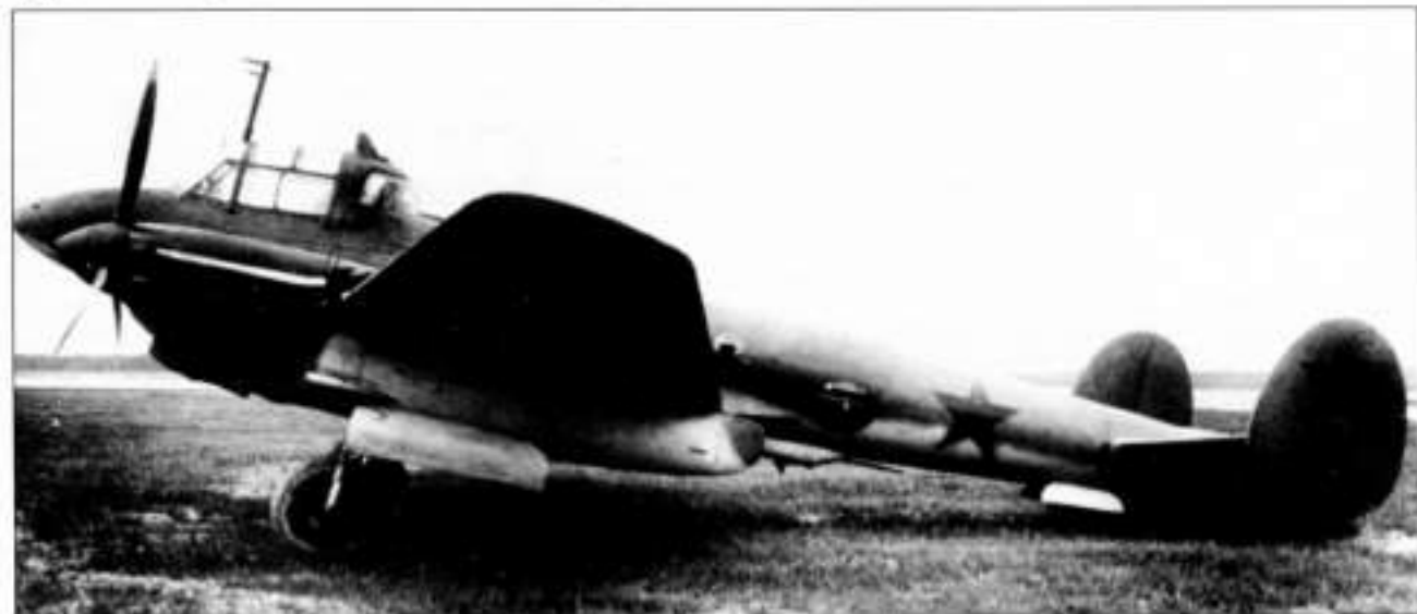
Эта машина с усовершенствованной кабиной летчика-штурмана «ФЗ» («фронтное задание») обладала лучшими аэродинамическими свойствами и была более «эргономичной». Однако внедрять «ФЗ» в серию не стали, опасаясь даже временного снижения производительности завода № 22
