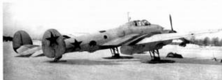
Зимой 1941/42 г. производилась оценка возможности полетов Пе-2 с лыжным шасси. Впрочем, оно практически не понадобилось — взлетные полосы и рулежные дорожки аэродромов стали укатывать катками. «Зимние» машины покрывались смываемой белой краской для снижения заметности на земле
