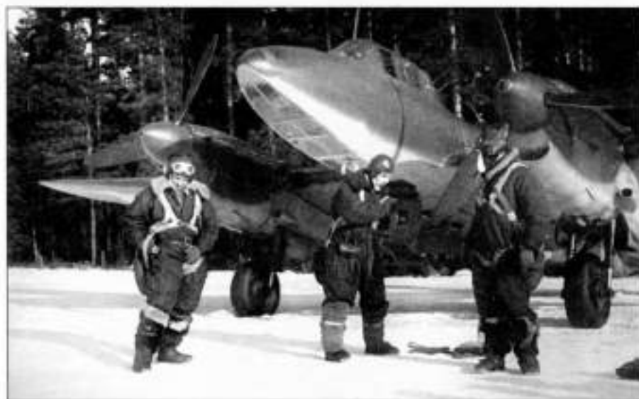
Экипаж самолета-разведчика поздней серии выпуска собирается в путь. Виден открытый люк кабины летчика и штурмана, а позади него два отверстия для объективов фотоаппаратов в створках отсека полезной нагрузки. Антенна радиополукомпаса РПК-10 «Чайнок» имеет форму кольца
