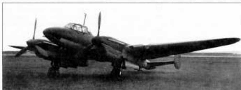
Тяжелый истребитель Пе-3бис выпускался малой серией весной и летом 1942 г. на иркутском заводе № 39. Он получил пушку ШВАК, смонтированную в носовой части фюзеляжа, а также штурманскую экранированную турель ВУБ-3 с пулеметом УБК. В хвостовом коке монтировали «пугач» — неуправляемый пулемет ШКАС, стрелявший назад
