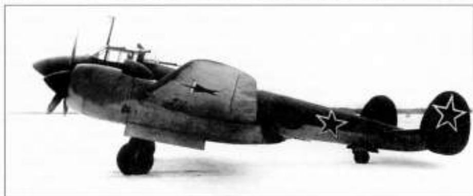
Серийный самолет Пе-2 с мощными моторами воздушного охлаждения М-82Ф. Вопреки ожиданиям, самолет не получил широкого распространения из-за недостаточной надежности винтомоторной установки и слишком большого расхода топлива, серьезно ограничившего радиус действия машины. К тому же было решено использовать эти моторы для бомбардировщиков и разведчиков Ту-2
