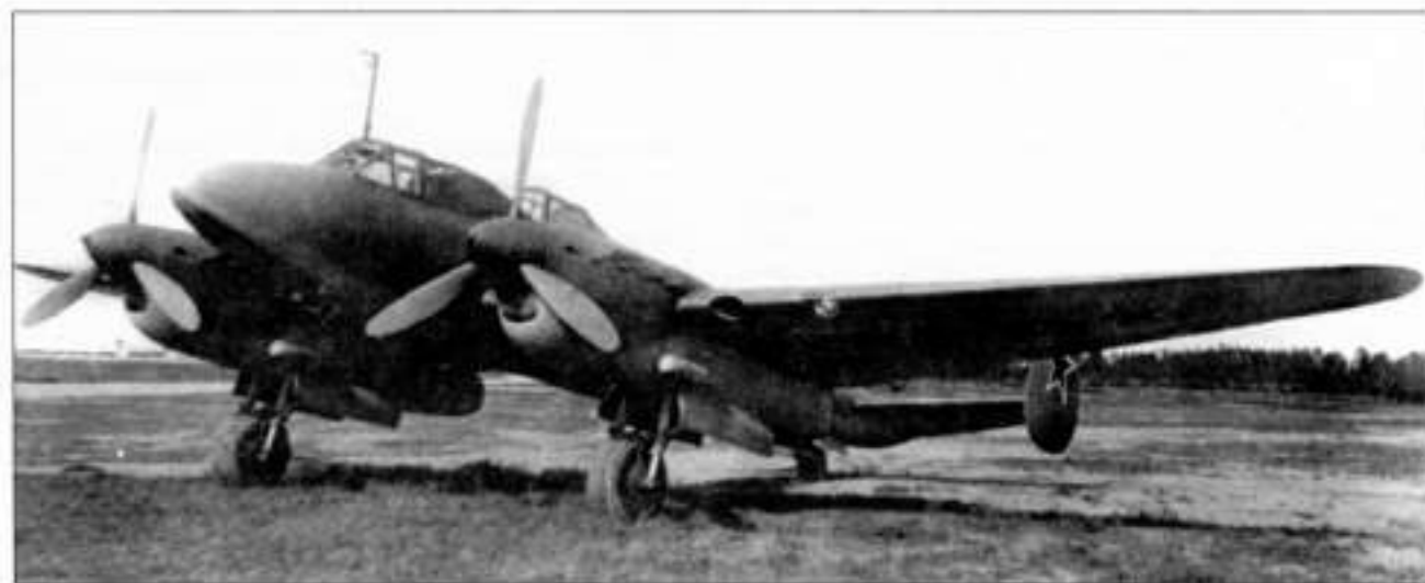
Учебный самолет УПе-2 с кабиной инструктора, смонтированной позади кабины курсанта. Особое распространение учебные самолеты получили во второй половине войны, когда требования к уровню подготовки молодого пополнения повысились
