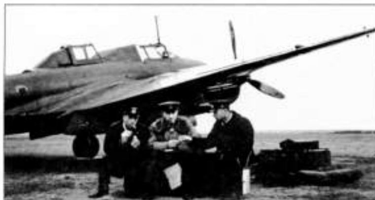
Начиная с конца 1942 г. в каждом бомбардировочном авиаполку имелись один-два учебных самолета УПе-2 с кабиной инструктора, смонтированной позади кабины обучаемого
