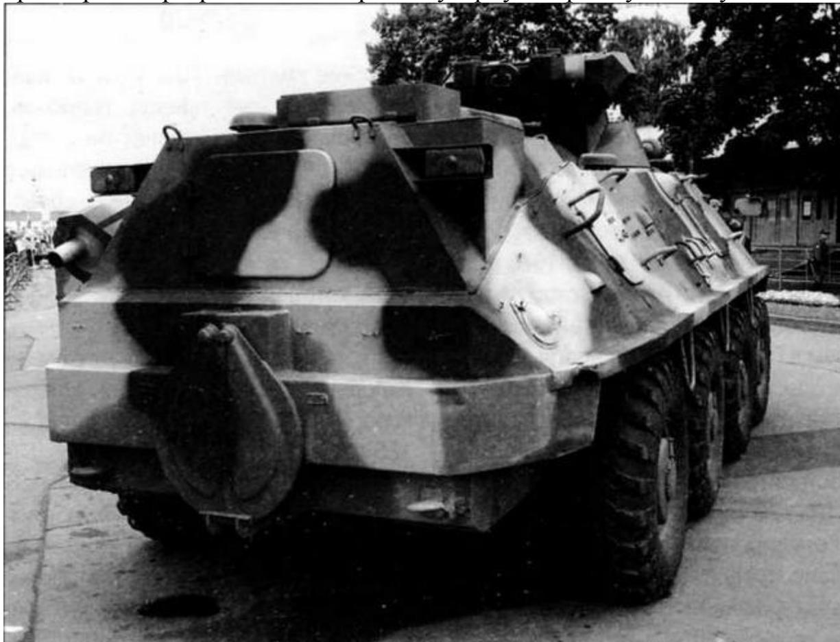
*Этот вариант модернизации бронетранспортера БТР-60ПБ, демонстрировавшийся на выставке МВСВ-2006 в Москве, предложен ОАО «Муромтепловоз». На машине установлен дизельный двигатель ЯМЗ-236А мощностью 195 л.с. Из-за размещения двигателя больших габаритов пришлось нарастить объем МТО*
