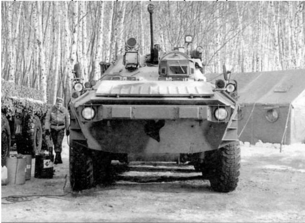
*Доработанный вариант БТР-90 на выставке военной автомобильной техники в 21 НИИ МО РФ. Бронницы, 2001 год. Обращает на себя внимание бампер с фарами на нижнем лобовом листе корпуса машины*
