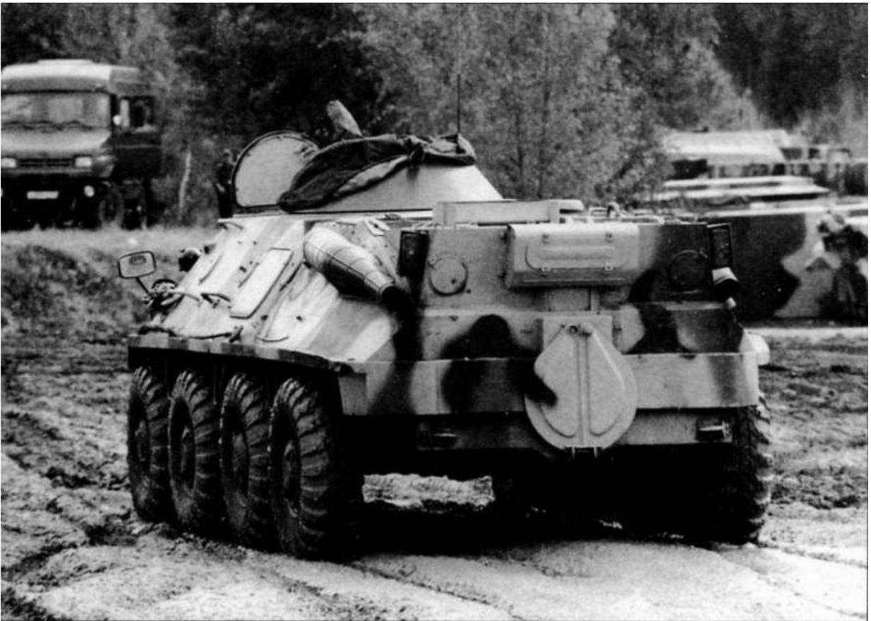
*В центре и справа: модернизированный образец бронетранспортера БТР-60ПБ. На машине использованы двигатель и трансмиссия от БТР-80. Этот вариант модернизации предложен Арзамасским машиностроительным заводом. Полигон 21 НИИ МО РФ, Бронницы, 2003 год*
