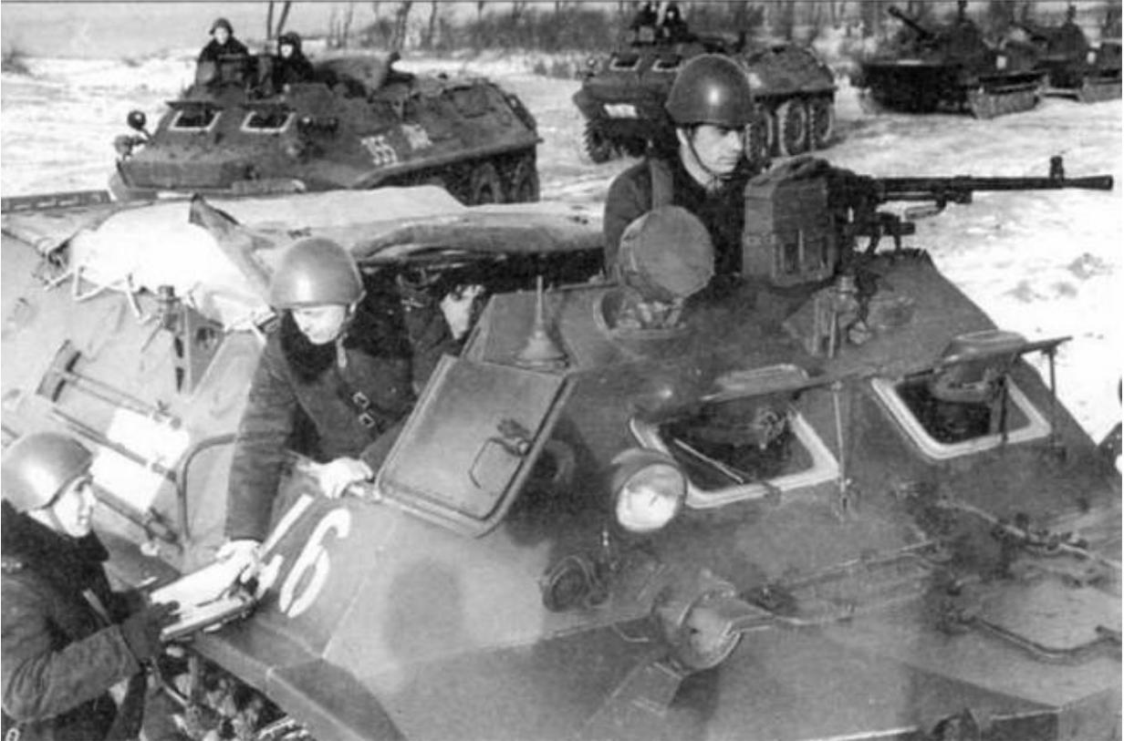
*Бронетранспортер БТР-60П морской пехоты. Январь 1969 года. Десантное отделение машины закрыто брезентом. Штатный пулемет СГМБ установлен на носовой шкворне. На правом борту машины виден бортовой шкворень, еще один установлен на левом борту*
