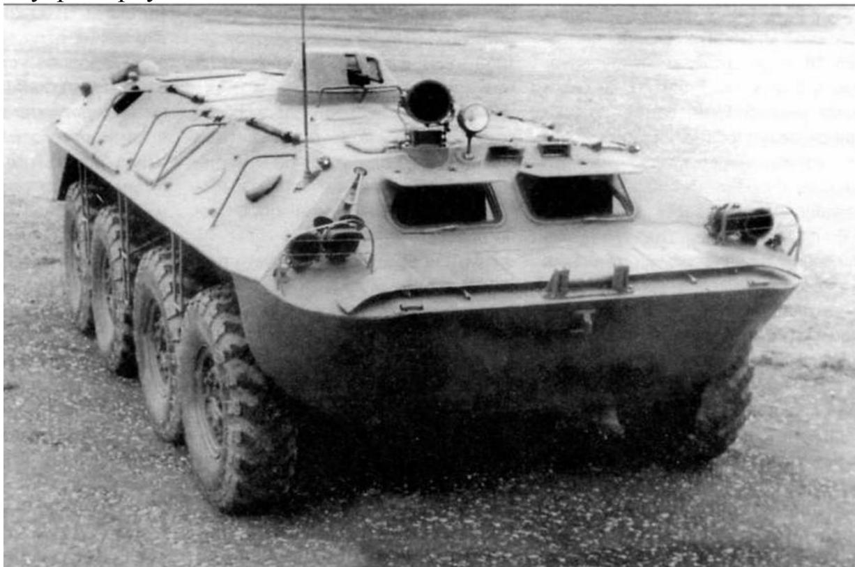
*Опытный образец бронетранспортера «1015-Б» Кутаисского автозавода. Хорошо видна ложкообразная форма нижней носовой части корпуса*
