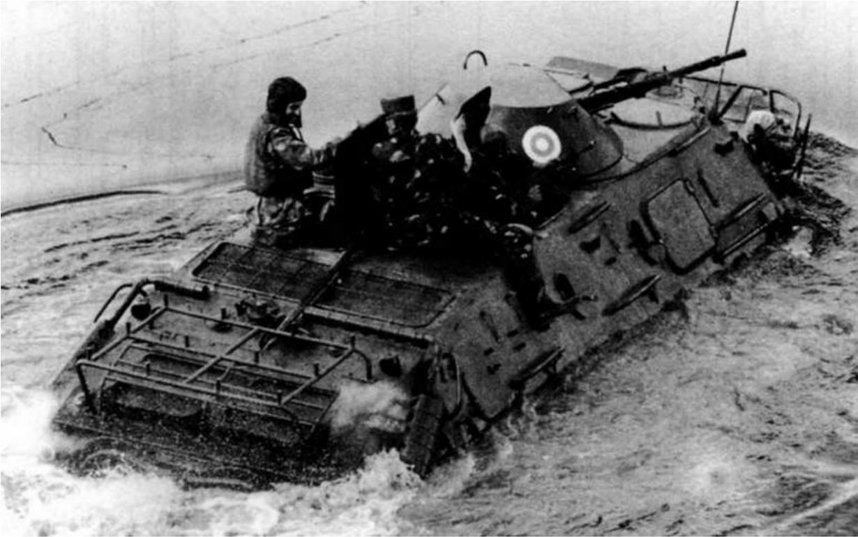
*На плаву — бронетранспортер БТР-60ПБ финской армии. Лето 1978 года. На корме машины установлена рама для крепления металл и чес кого грузового кузова — финская доработка*
