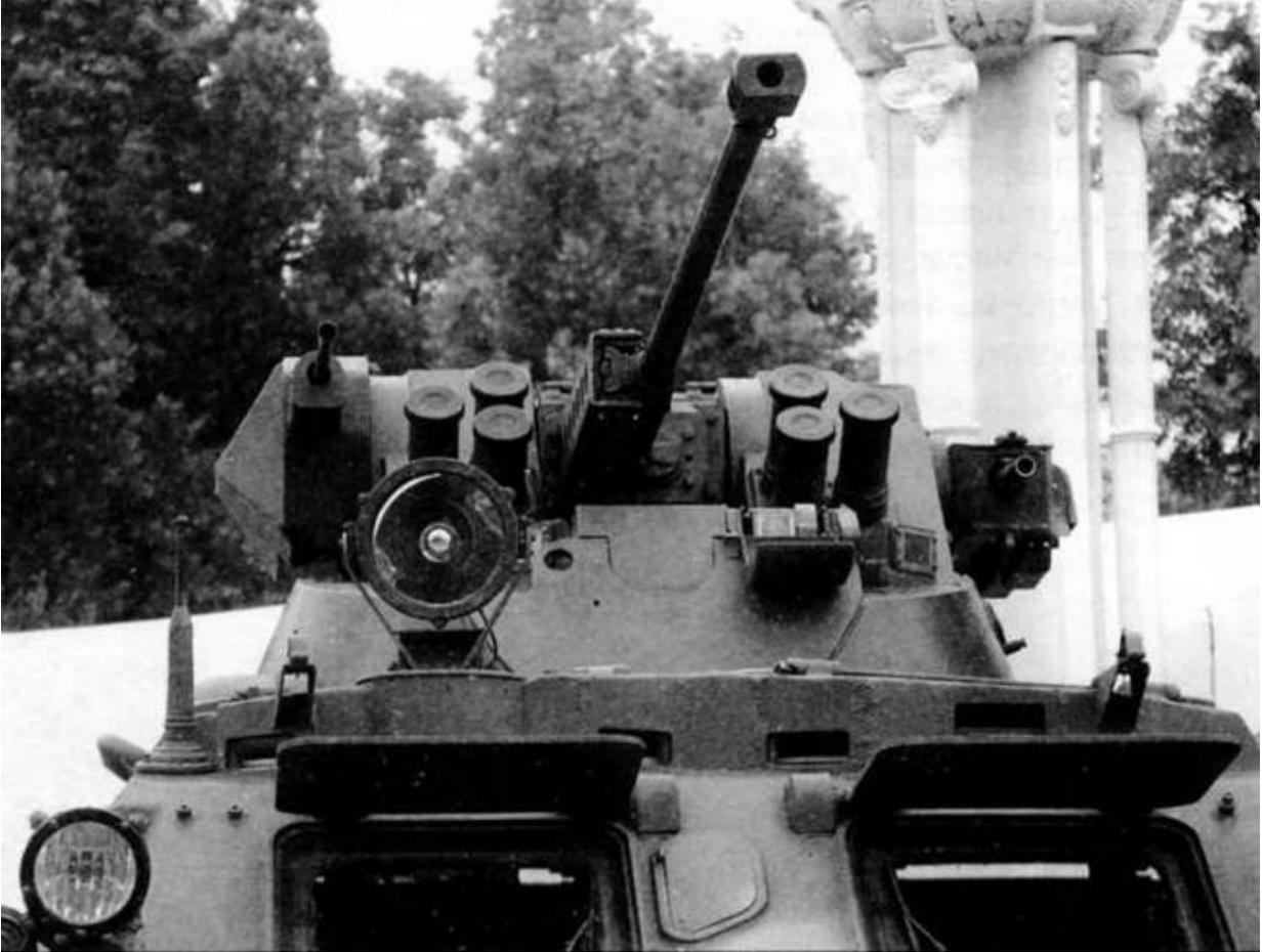
*Боевой модуль, использованный на этой машине, в целом подобен таковому у БТР-80А. В нем размещены: 30-мм автоматическая пушка 2А42, 7,62-мм пулемет ПКТМ и 30-мм автоматический гранатомет АГ-17*
