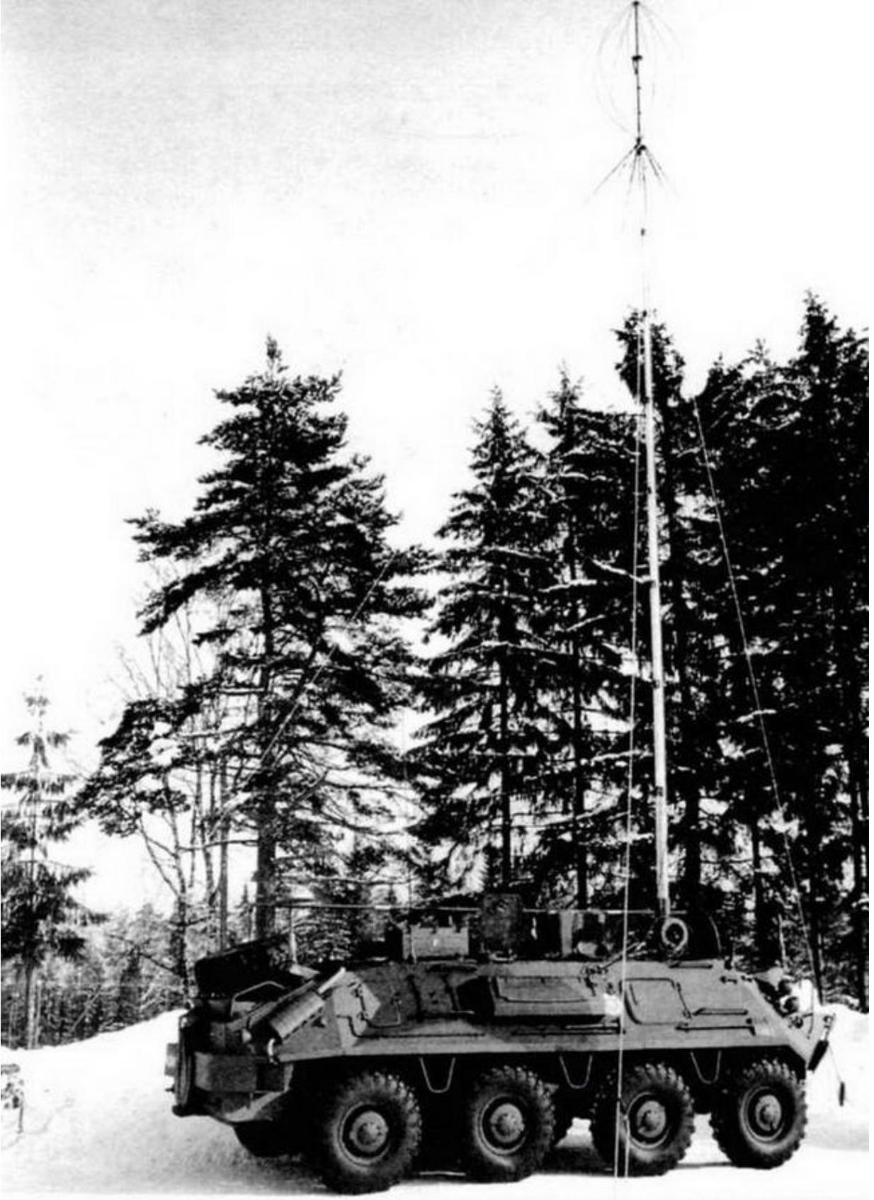
*Радиомашина БТР-60Р-145БМ в развернутом положении, 1984 год. Обращает на себя внимание 16-метровая телескопическая мачта для антенны радиостанции Р-111*
