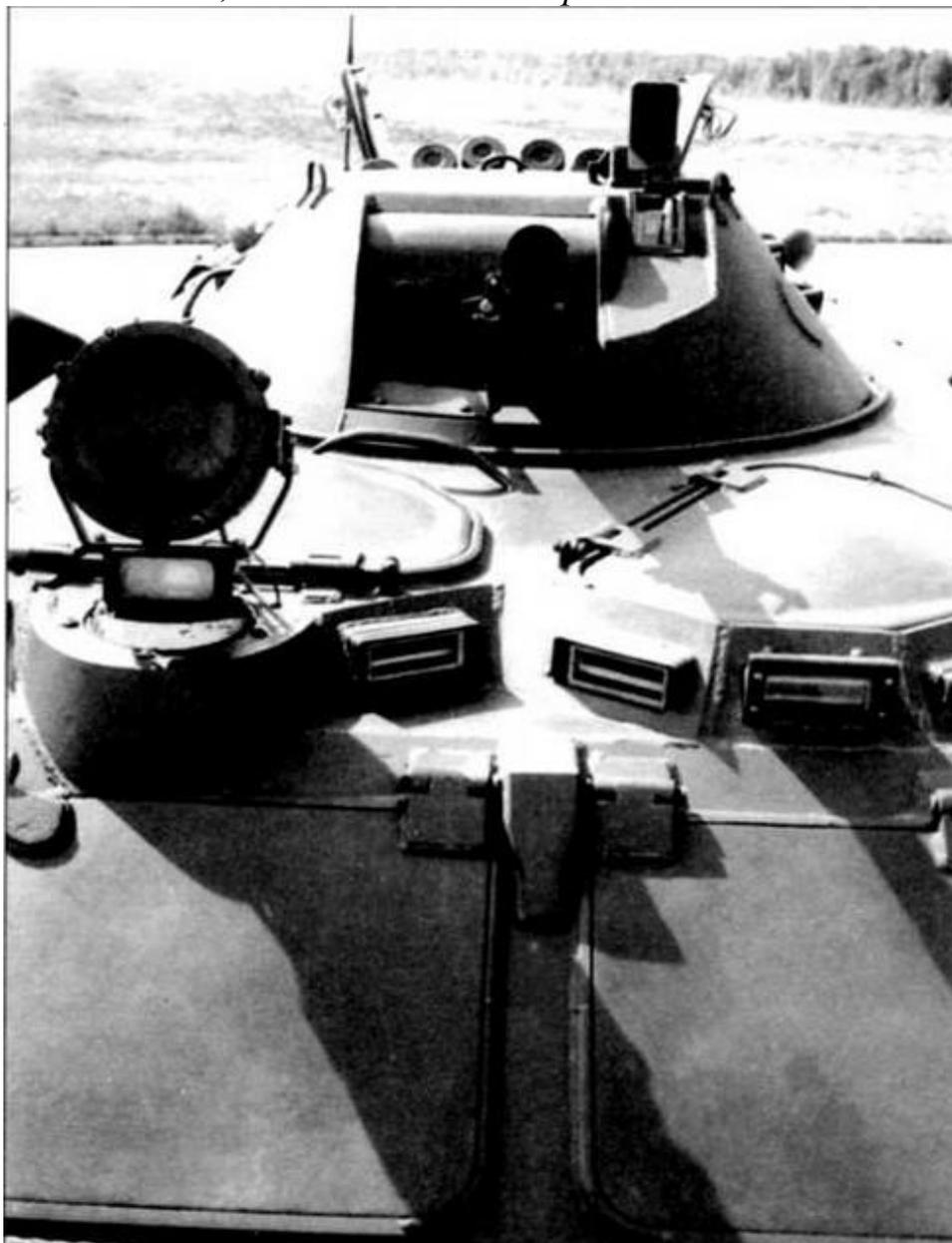
*Вид спереди на башенную пулеметную установку БПУ-1. Справа от маск-установки пулеметов — амбразура прицела ППЗ-2 с откинутой вверх броневой крышкой. На переднем плане, перед люком*
