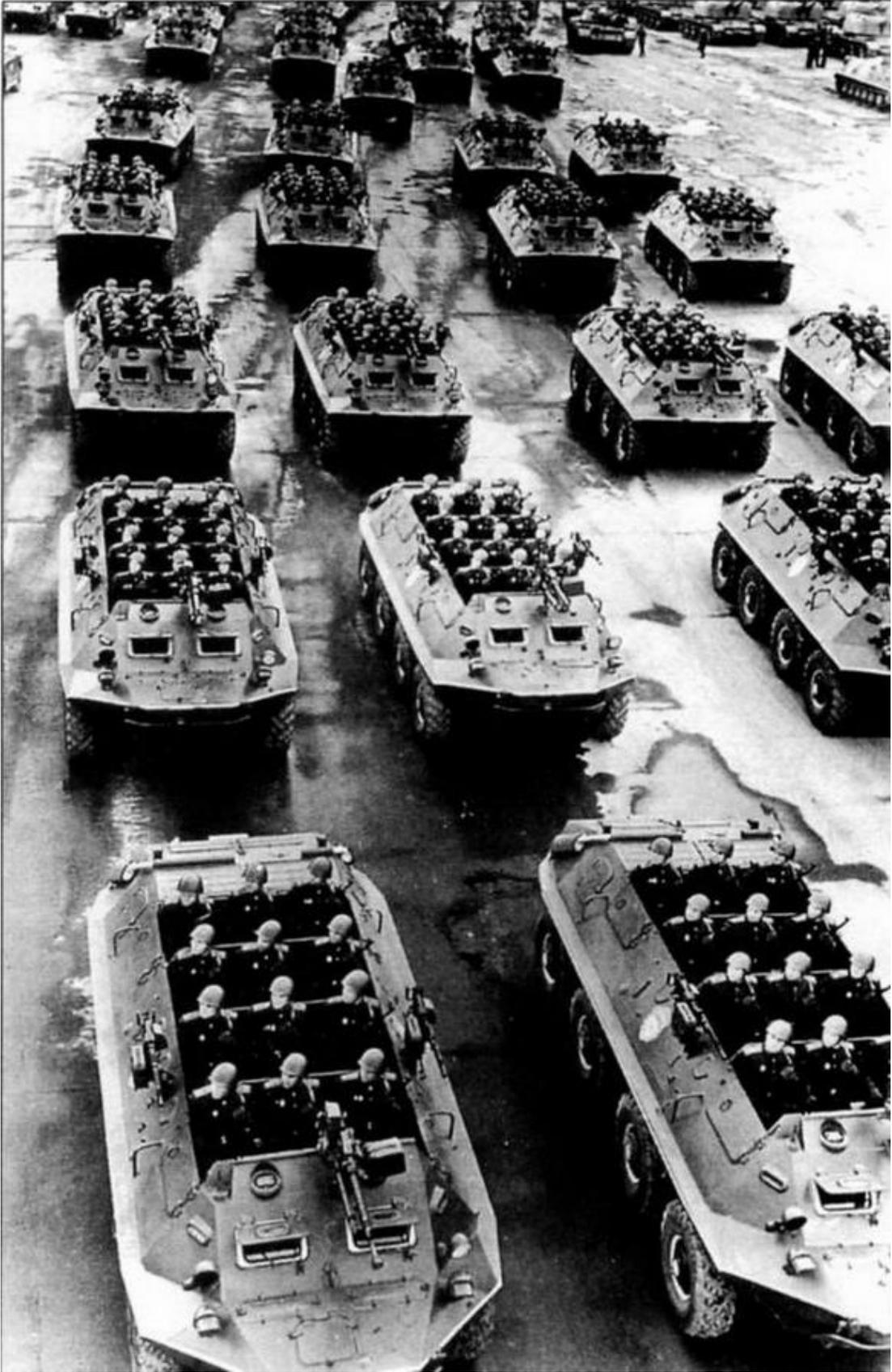
*Колонна бронетранспортеров БТР-60П перед парадом. Хорошо видны парадное размещение мотострелков-десантников и штатное парадное вооружение из крупнокалиберного пулемета ДШКМ и двух пулеметов СГМБ*
