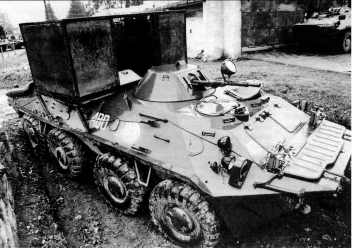
*БТР-70 одного из саперных подразделений российских миротворческих сил в Абхазии, 1998 год. Размещение личного состава в металлическом ящике на крыше машины обеспечивало ему относительную безопасность в случае подрыва БТР на mine*
