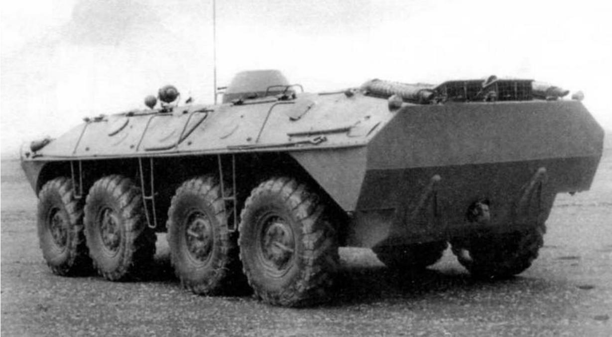
*Бронетранспортер «1015-Б». Хорошо видны заслонки водометов на нижнем кормовом листе корпуса*
