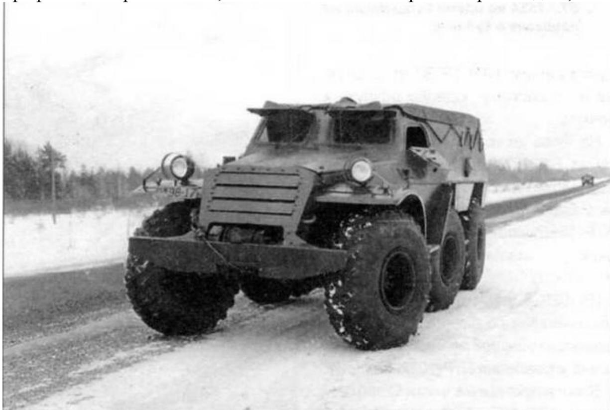
*Опытный образец бронетранспортера БТР-Э152В с равным расположением осей. Управляемыми были колеса переднего и среднего мостов*
