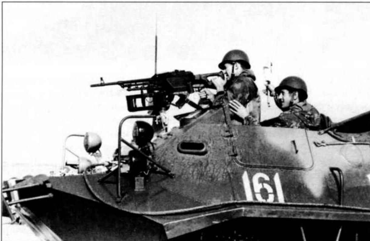
*На этом БТР-60П установлен 7,62-мм пулемет ПКБ. 1971 год*
