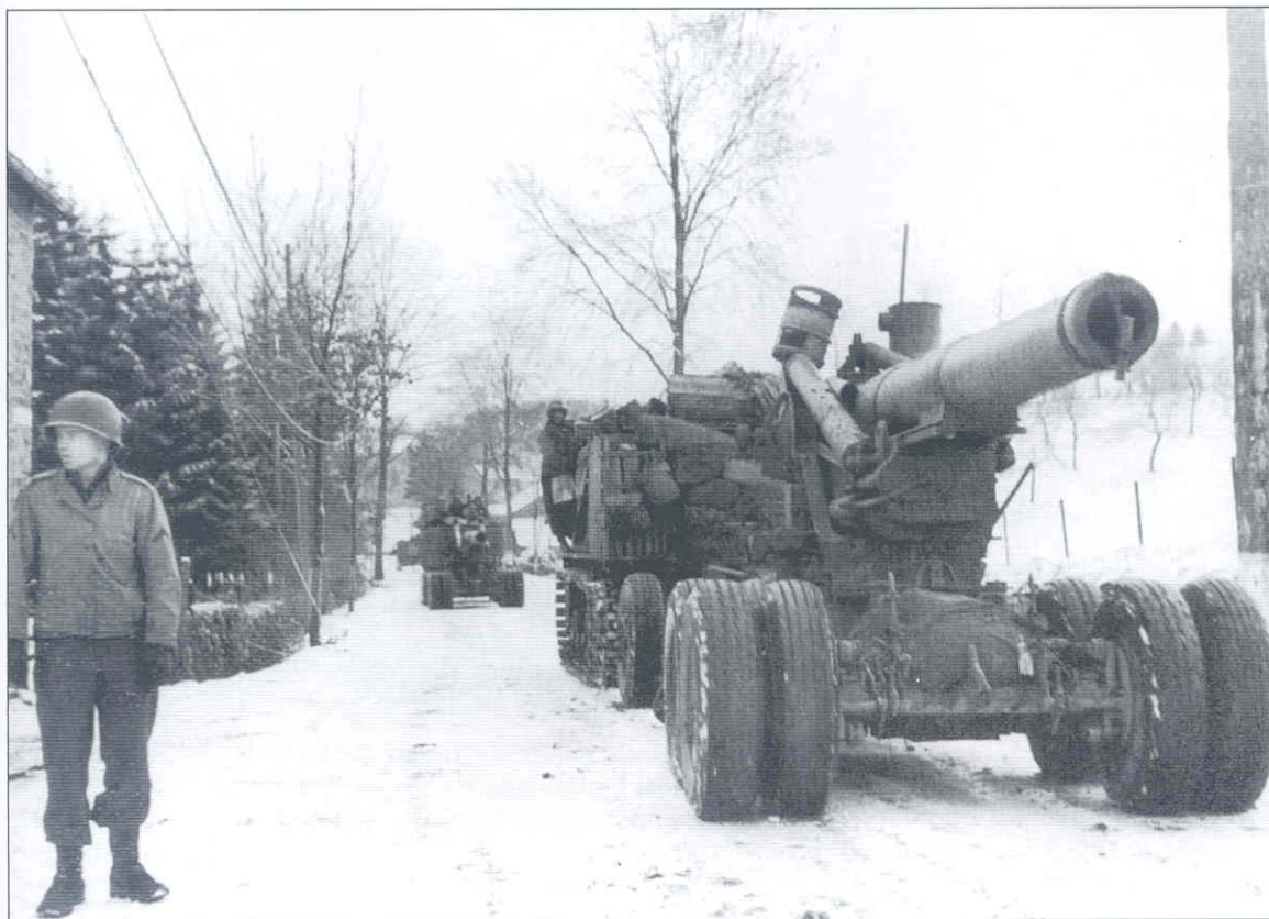
Колонна 203-мм дальнобойных гаубиц М1 из состава 1-й армии США перемещается на новые позиции. Артсистемы буксируются гусеничными тягачами М5, которые оборудованы специальными уширенными гусеницами. Арденны, декабрь 1944 года (АВЛ).
