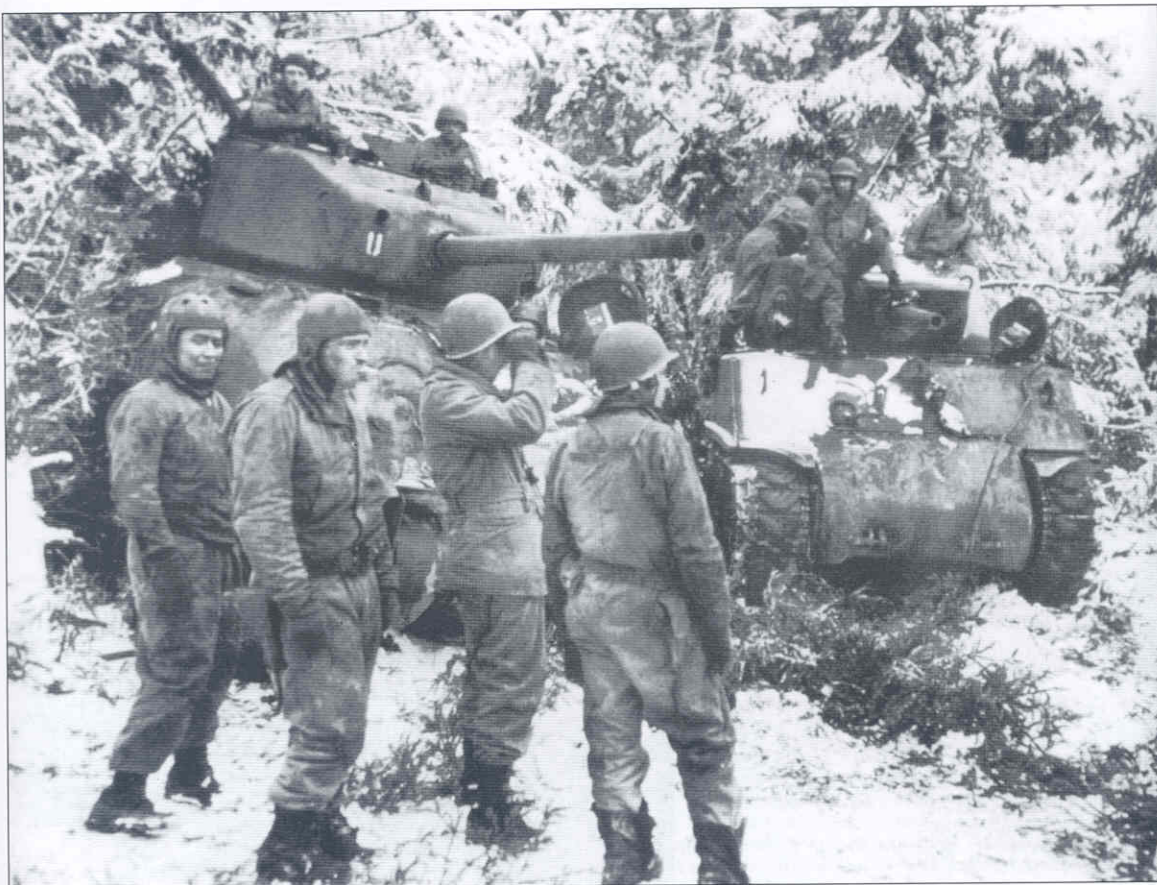
Американские танки "Шерман" M4A1(76)W (слева) и M4A3E2 "Джамбо" со 105-мм пушкой (справа) из 3-й танковой дивизии армии США. Экипажи в ожидании атаки противника. Арденны, декабрь 1944 года (АВЛ).
