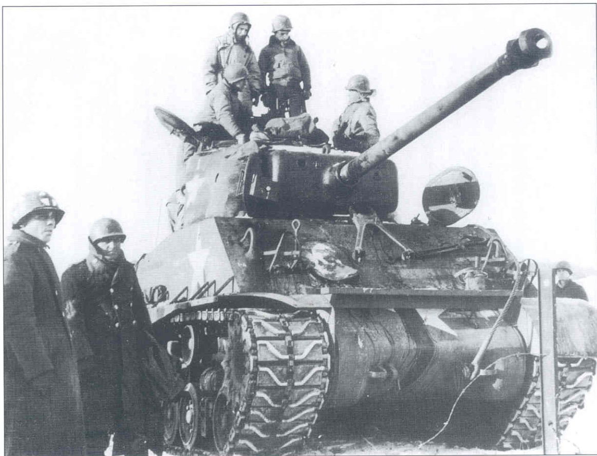
На снимке одна из самых последних и технически проработанных модификаций "Шермана" – модель М4А3Е8, с новой подвеской и более широкими гусеницами. В конце 1944 года эти машины только начали поступать в американские части. Арденны, январь 1945 года (АВЛ).
