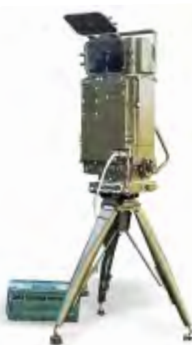
Лазерный целеуказатель- дальномер 1D22
