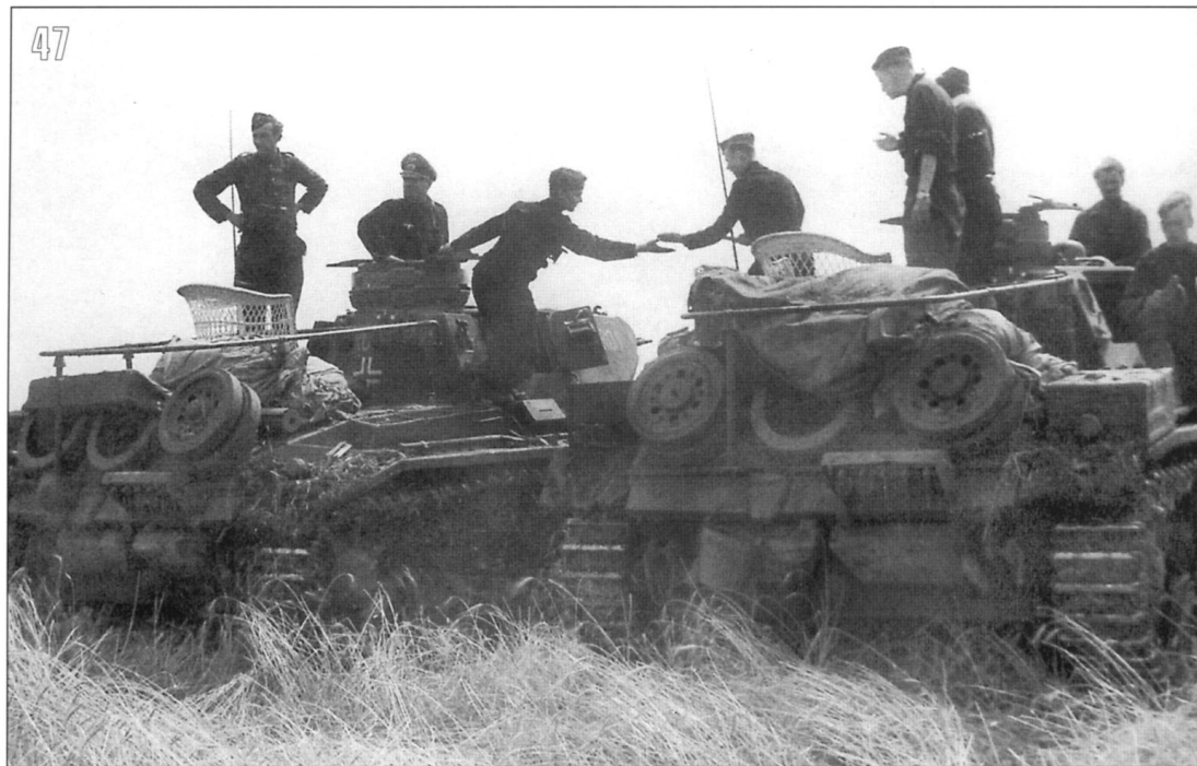
47. Командирские танки Pz. Kpfw. III. Ausf. H, оснащённые поручневой антенной дальней связи и креслами для удобства открытого наблюдения за местностью. Машины принадлежат 33-му полку 9-й танковой дивизии вермахта. Украина, август 1941 года (Bundesarchiv).
