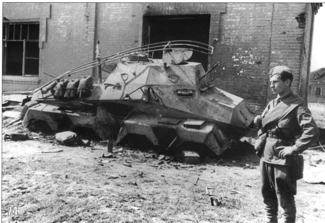
74. Бронеавтомобиль управления Sd. Kfz. 263, подбитый бойцами Юго-Западного фронта. Оснащён поручневой радиоантенной для передатчика дальнего действия. Украина, август 1941 года (АВЛ).
