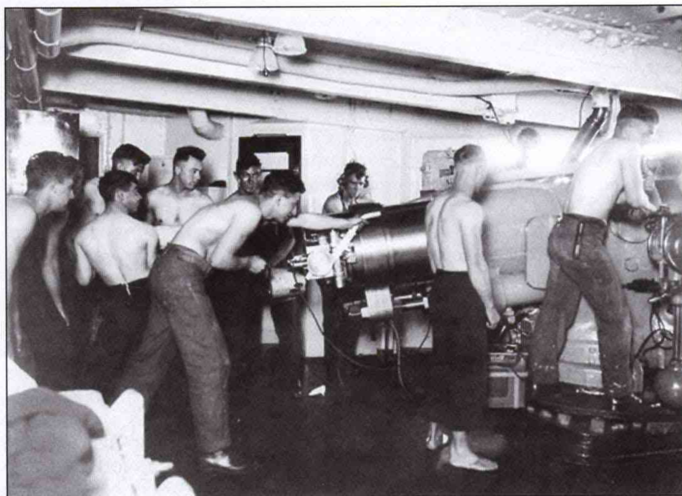
Противоминное 127-мм/51 орудие линкора «Невада»
