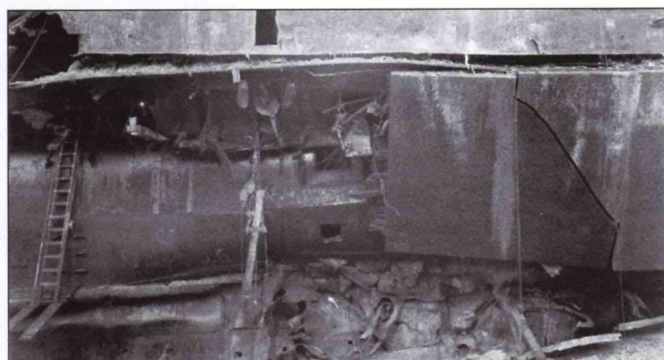
«Оклахома» в доке, 31 декабря 1943 г. Хорошо виден характер разрушений
