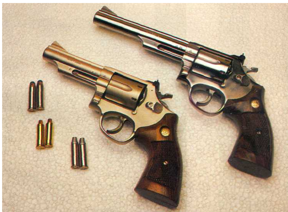
1 Бразильский револьвер «Таурус» очень похож на «Смит-Вессон», однако имеет отличия в конструкции замка.
