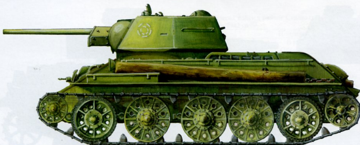
Т-34/76 выпуска 1942 года с увеличенной башней. Сталинградский фронт, 90-я танковая бригада, ноябрь 1942 года. A T-34/76 vintage 1942 tank with an enlarged turret. Stalingrad Front, 90th armoured brigade, November 1942.
