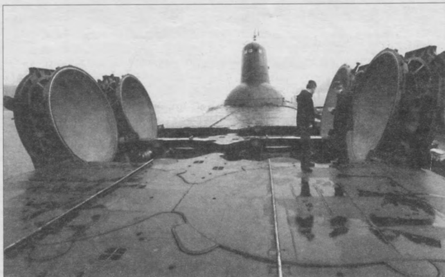
Крышки ракетных шахт РПКСН проекта 941.
