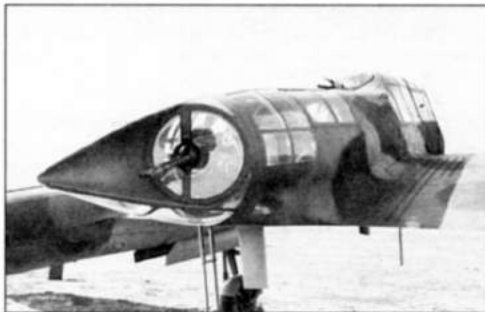
Хвостовой поворотный конус Fw 189A-2 со спаренной пулеметной установкой MG 81
