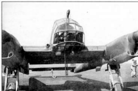
Fw 189A, вид спереди. Хорошо видна хвостовая стойка шасси под стабилизатором
