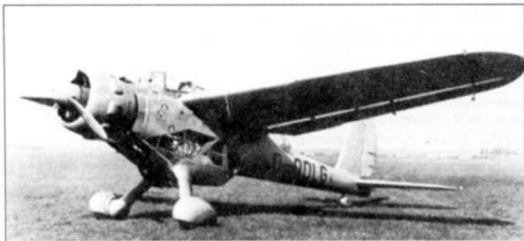
Неудачливый конкурент «рамы» — ближний разведчик «Арадо» Ar 198V1, построенный в единственном экземпляре. Самолет имеет гражданскую регистрацию D-ODLG. Весна 1938 г.
