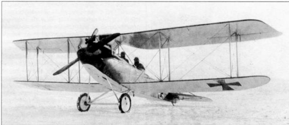
Самолеты-разведчики фирмы «Румплер» отличались обтекаемыми формами фюзеляжа. На снимке — самолет модификации C.IV, январь 1917 г.
