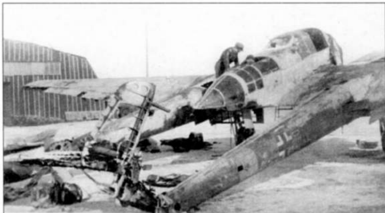
Сильно поврежденный Fw 189A-1 из отряда 12.(Н)/AufklGr 13. Машина имеет усиленное вооружение: в верхней установке сохранен одиночный пулемет MG 15, но в хвостовой конусе установлена спарка MG 81Z от самолета Fw 189A-2. Восточный фронт, конец 1943 г.
