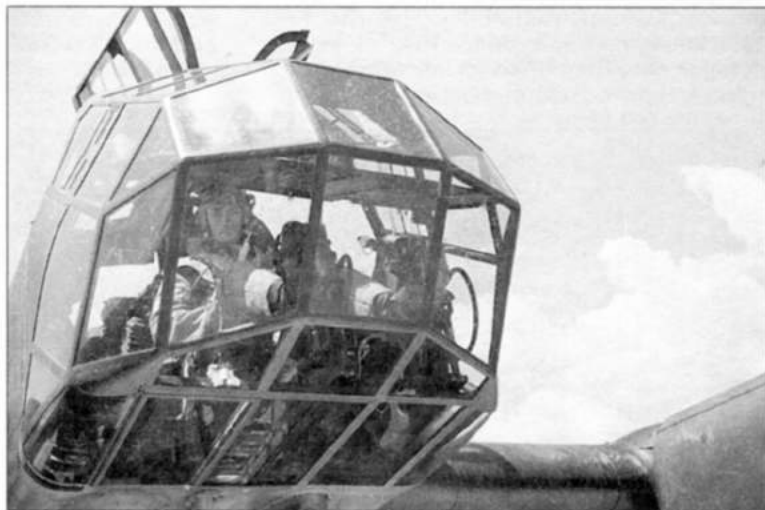
Богато остекленная кабина Fw 189 обеспечивала прекрасный обзор. Все остекление набрано из плоских панелей, дабы не искажать изображение
