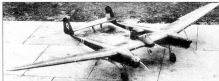
Опытный бронированный штурмовик Fw 189V1b, созданный в конце 1938 г. Испытания показали полную несостоятельность этой машины
