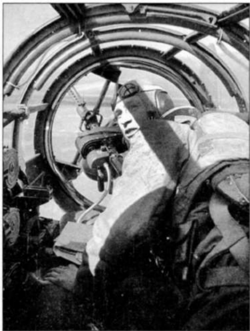
Стрелок на своем рабочем месте в хвостовом конусе Fw 189. Хорошо виден пулемет MG 15, а слева — магазины к нему
