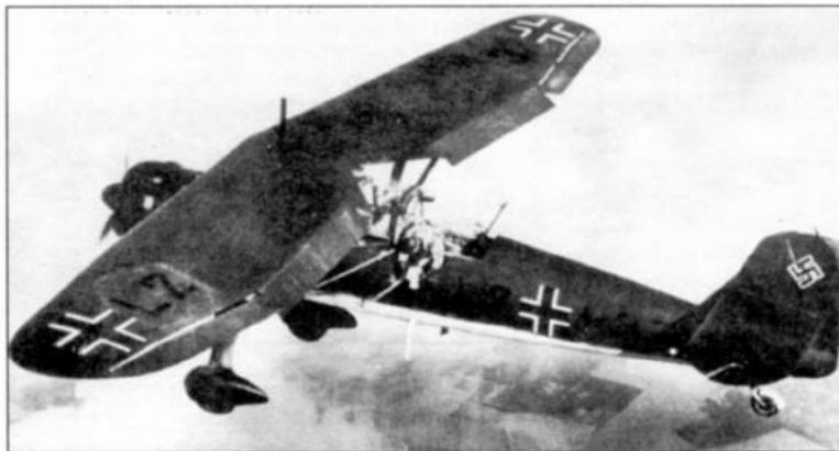
Hs 126 в полете. Хорошо заметна стреловидность передней кромки крыла
