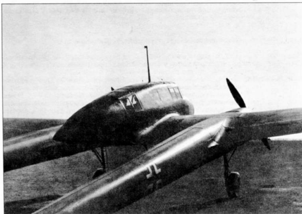
Учебно-тренировоч- ный самолет Fw 189B-1 отличался совершенно иной конструкцией гондо- лы по сравнению с разведчиками Fw 189A
