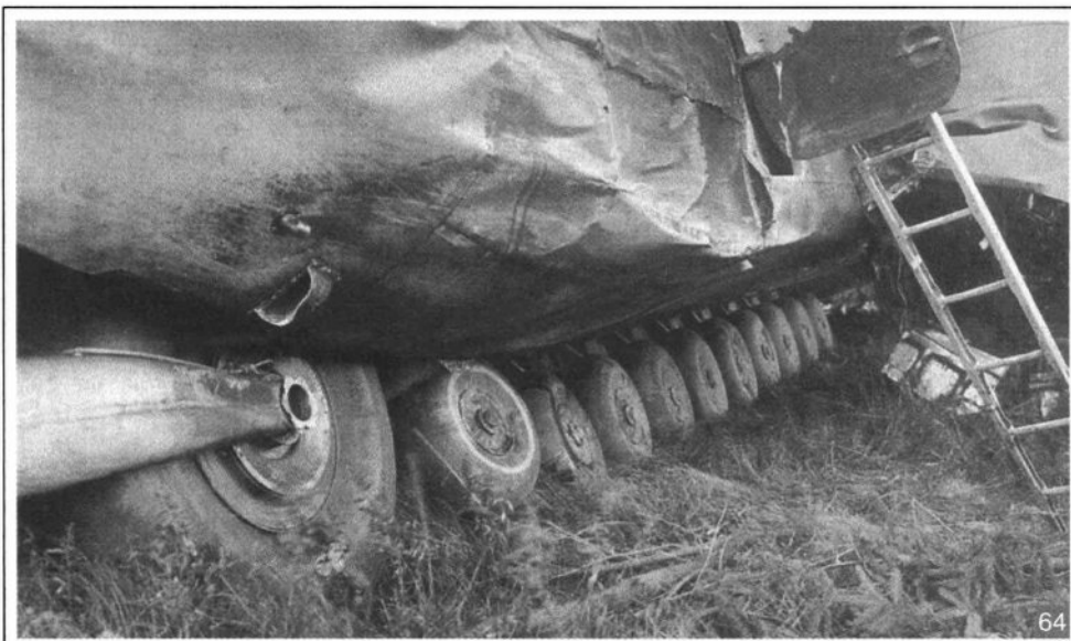
64. Необычное шасси транспортного Ar232B вызвало особый интерес советских авиационных специалистов
