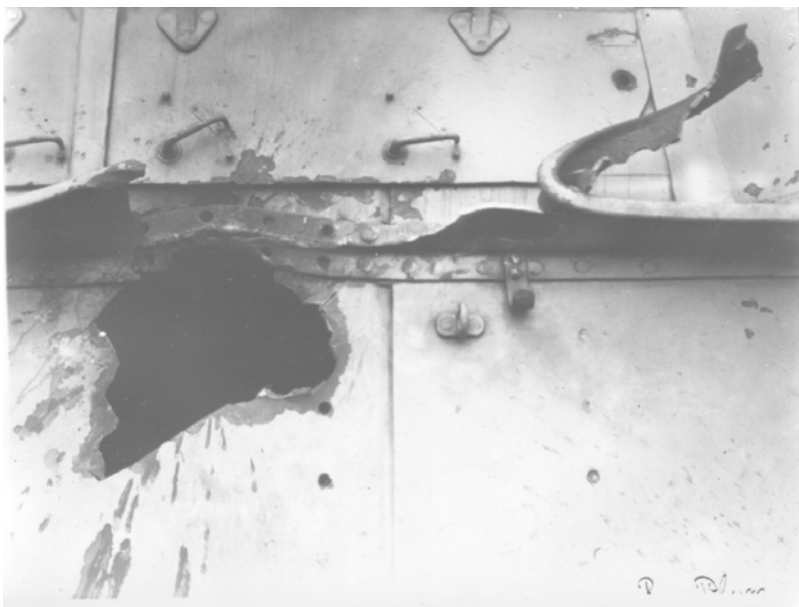
Фото 29. Линейный крейсер «Фон дер Танн». Пробитие легкой брони английским снарядом
