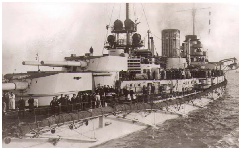
Фото 43. Линейный крейсер «Мольтке». Видны противоторпедные сети, уложенные вдоль борта
