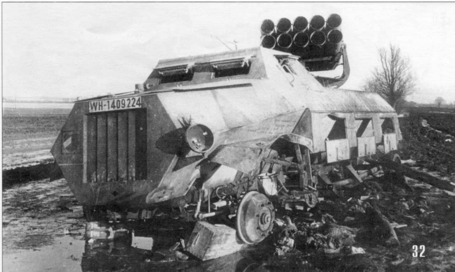
32. Реактивный 150-мм миномет на бронированной полугусеничной базе Panzerwerfer 42 Ausf SF (Sd Kfz 4/1) (номер "WH-1409224") предположительно из состава 11-й бригады реактивных установок. Восточная Пруссия, Земландский полуостров, апрель 1945 года (АСКМ).
