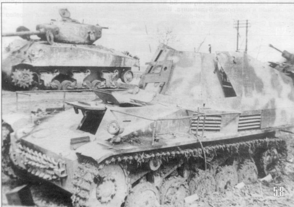
58. Транспортёр боеприпасов на базе самоходного орудия Sd Kfz 124 "Веспе". На борту видна эмблема 13-й тд и надпись "I Pz Art Rgt 13" (13-й артиллерийский полк). Ниже без черного фона белой краской нанесен знак самоходной артиллерии и цифра "7" справа от него. Венгрия, район Будапешта, январь 1945 года (АСКМ).
